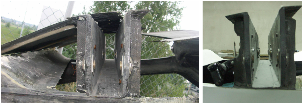
[U góry i u dołu] Porównanie struktur kadłubów samolotów – po lewej poddany wytrzymałościowej próbie statycznej (przyklejona pokrywa górna, zamykająca profile omegowe poprzeczek głównych wręg kadłuba), po prawej rozwiązanie zastosowane w samolotach seryjnych (pokrywa górna nieprzyklejona, otwarte profile omegowe poprzeczek wręg mocujących skrzydła – głównej i przedniej).
