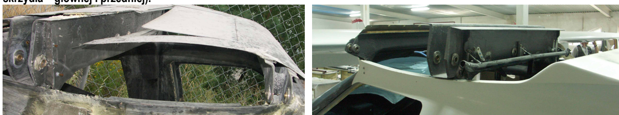
[U góry i u dołu] Porównanie struktur kadłubów samolotów – po lewej poddany wytrzymałościowej próbie statycznej (przyklejona pokrywa górna, zamykająca profile omegowe poprzeczek głównych wręg kadłuba), po prawej rozwiązanie zastosowane w samolotach seryjnych (pokrywa górna nieprzyklejona, otwarte profile omegowe poprzeczek wręg mocujących skrzydła – głównej i przedniej).
