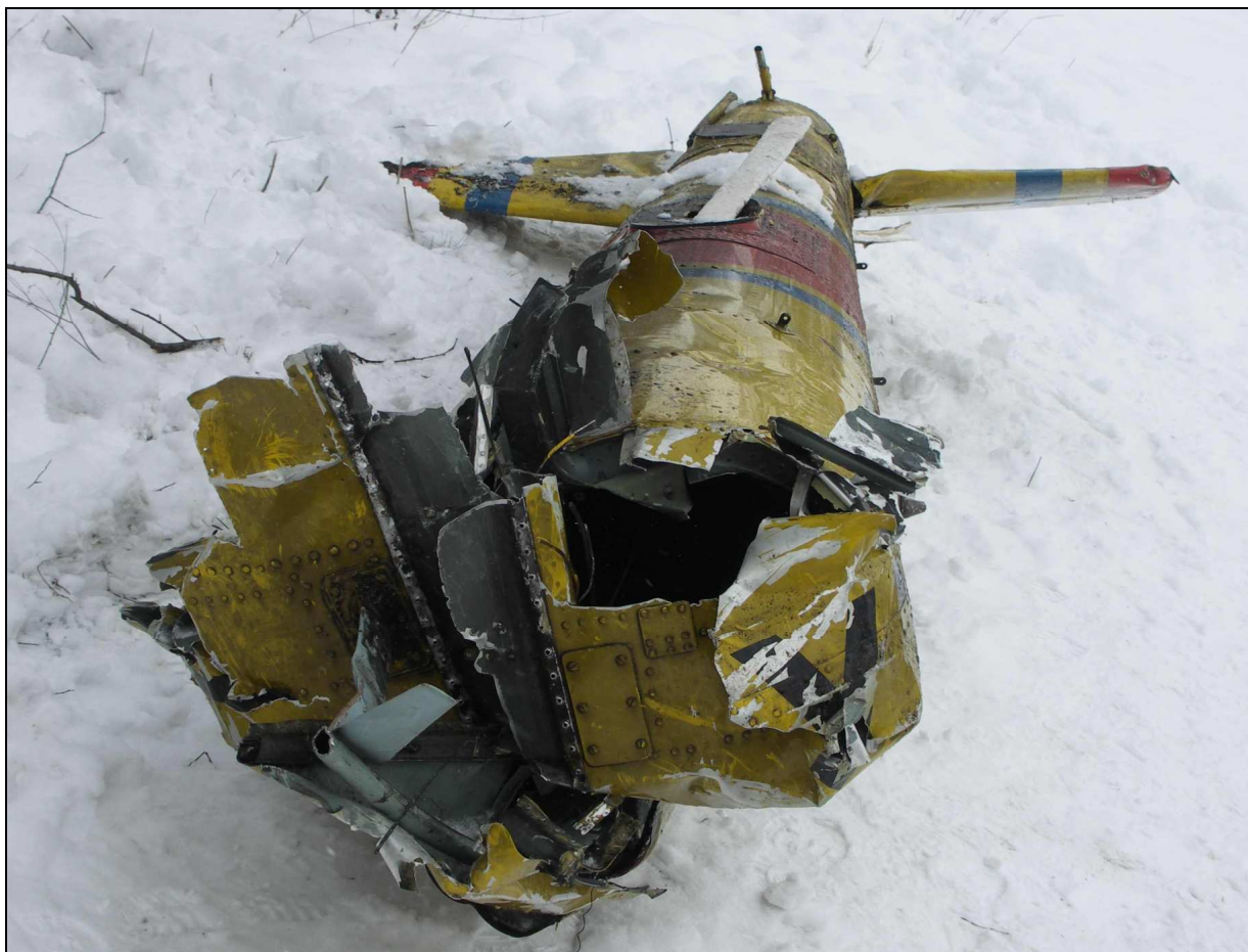
55 – Oderwana belka ogonowa [po odcięciu od wraka].
