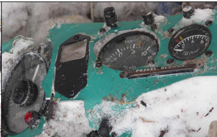
71 – Zbliżenie fragmentu tablicy ze wskaźnikami pracy zespołu napędowego
