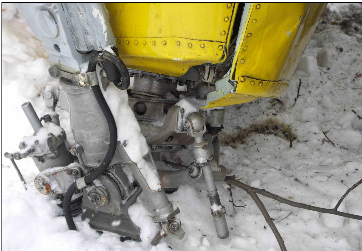
57 – Piasta wirnika głównego z pozostałym w okuciu fragmentem łopaty.
