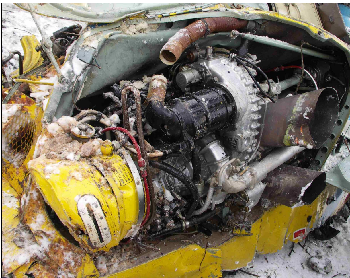
62 – Lewy silnik z wlotem ogrzewanym, widok 3/4 z przodu od lewej.
