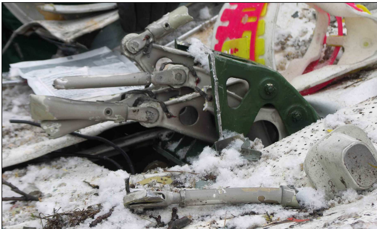
65 – Zniszczone elementy układu sterowania, zwraca uwagę doraźny charakter zniszczenia.
