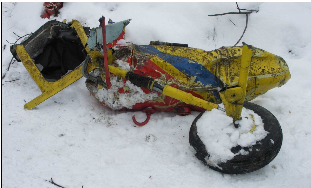
52 – Dodatkowy zbiornik paliwa i prawe podwozie główne. Obok szczątki obramowania jednego z okien kabiny.
