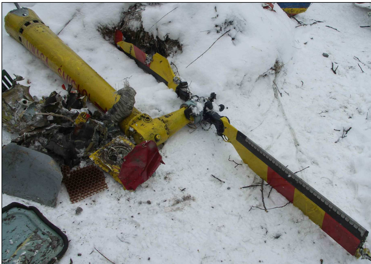
56 – Oderwany wysięgnik wirnika ogonowego z wirnikiem ogonowym [po odcięciu od wraka].
