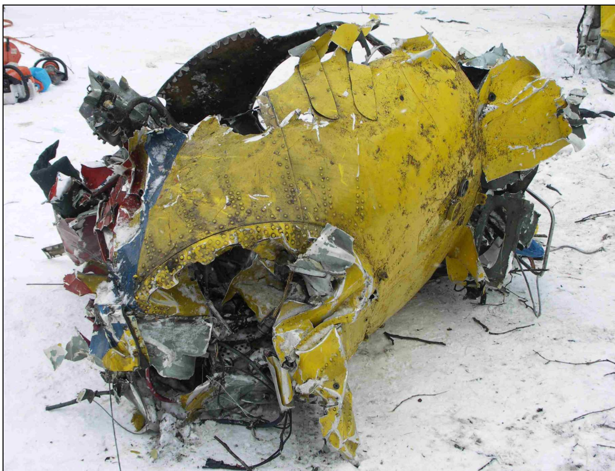
53 – Tylny segment kadłuba widoczny od zewnątrz z prawej strony [po odcięciu od wraka].
