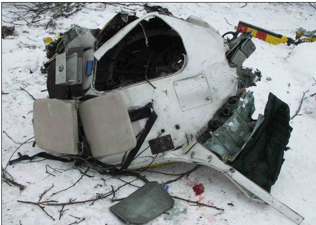
54 – Tylony segment kadłuba widoczny od strony wewnętrznej [tj. od wnętrza kabiny, po odcięciu od wraka]. Zwraca uwagę uszkodzony fotel lekarza z odpiętymi pasami bezpieczeństwa.
