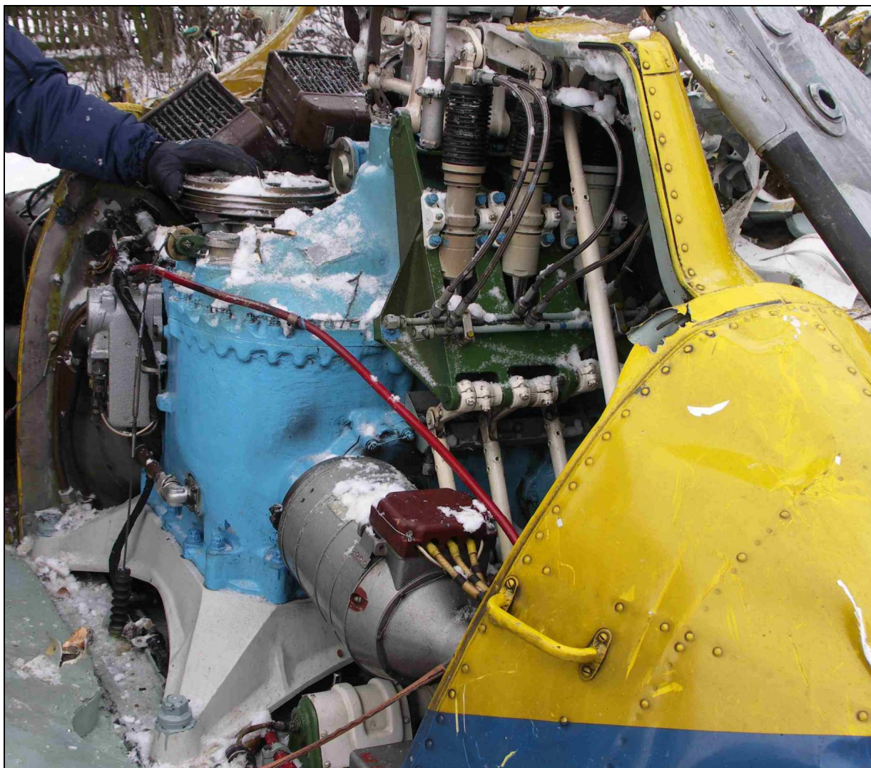
64 – Przekładnia główna z lewej strony od tyłu. Widać trzy siłowniki łopat.
