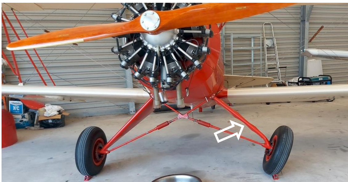
Rys. 1 Samolot Hatz Classic ze zdeformowaną golenią podwozia. Strzałką pokazano miejsce uszkodzenia [źródło: użytkownik samolotu]
