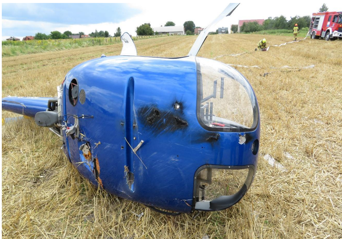
Rys. 3. Widoczne ślady kontaktu z linią energetyczną oraz ślady wybudowania się podwozia płozowego śmigłowca.
