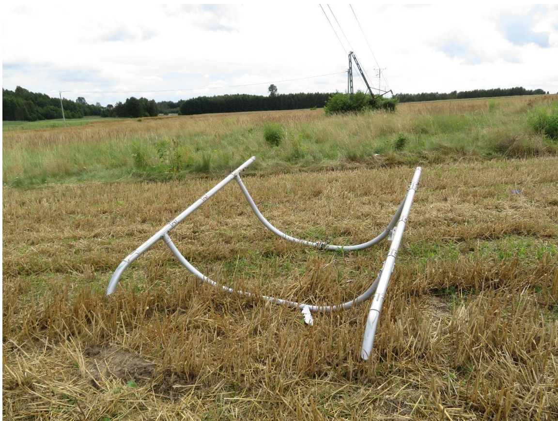
Rys. 4. Oderwane podwozie płozowe śmigłowca i złamany słup linii energetycznej.
