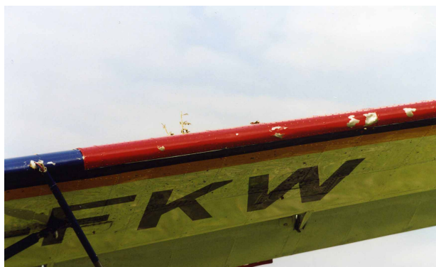
Fot.13 i 14 – Uszkodzenia noska lewego skrzydła.
