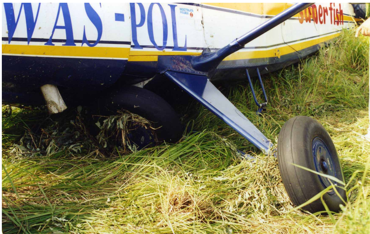
Fot.15 – Widok na podwozie główne samolotu. Prawe podwozie główne złamane, koło pod kadłubem.
