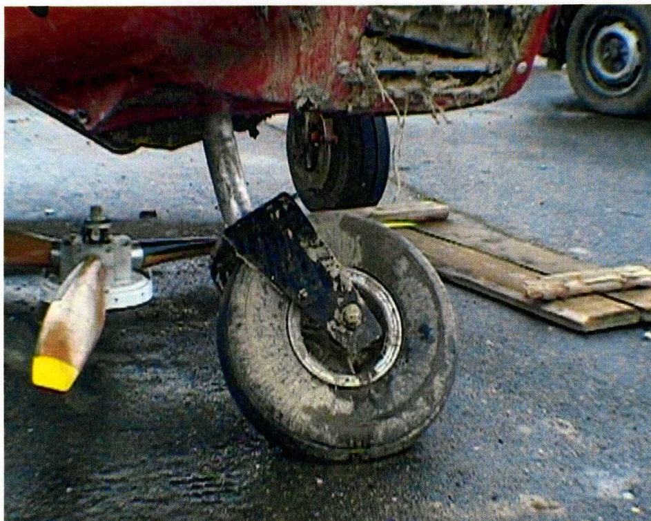
Rys. 7 Uszkodzona przednia goleń podwozia
