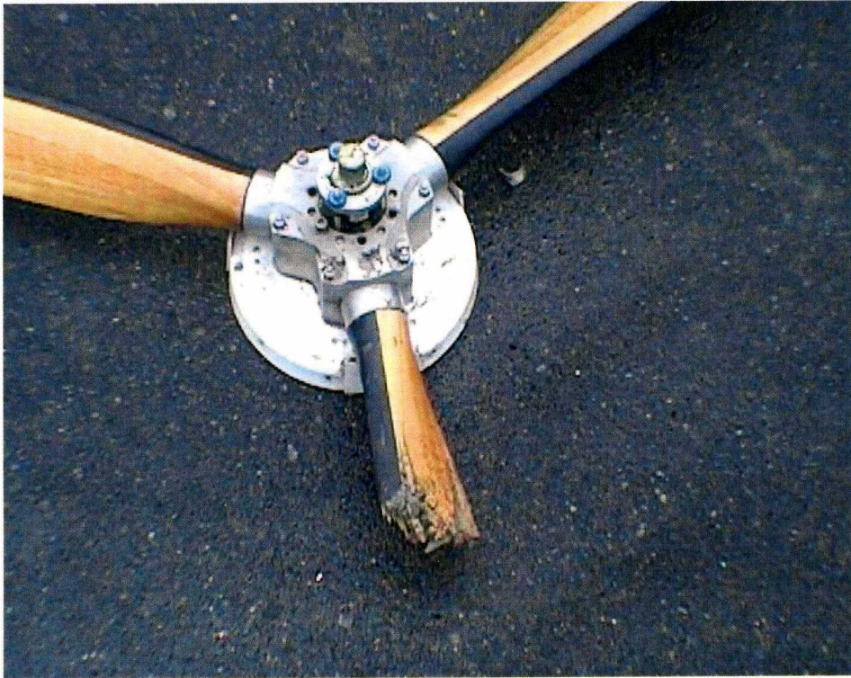
Rys. 5 Uszkodzona łopata śmigła
