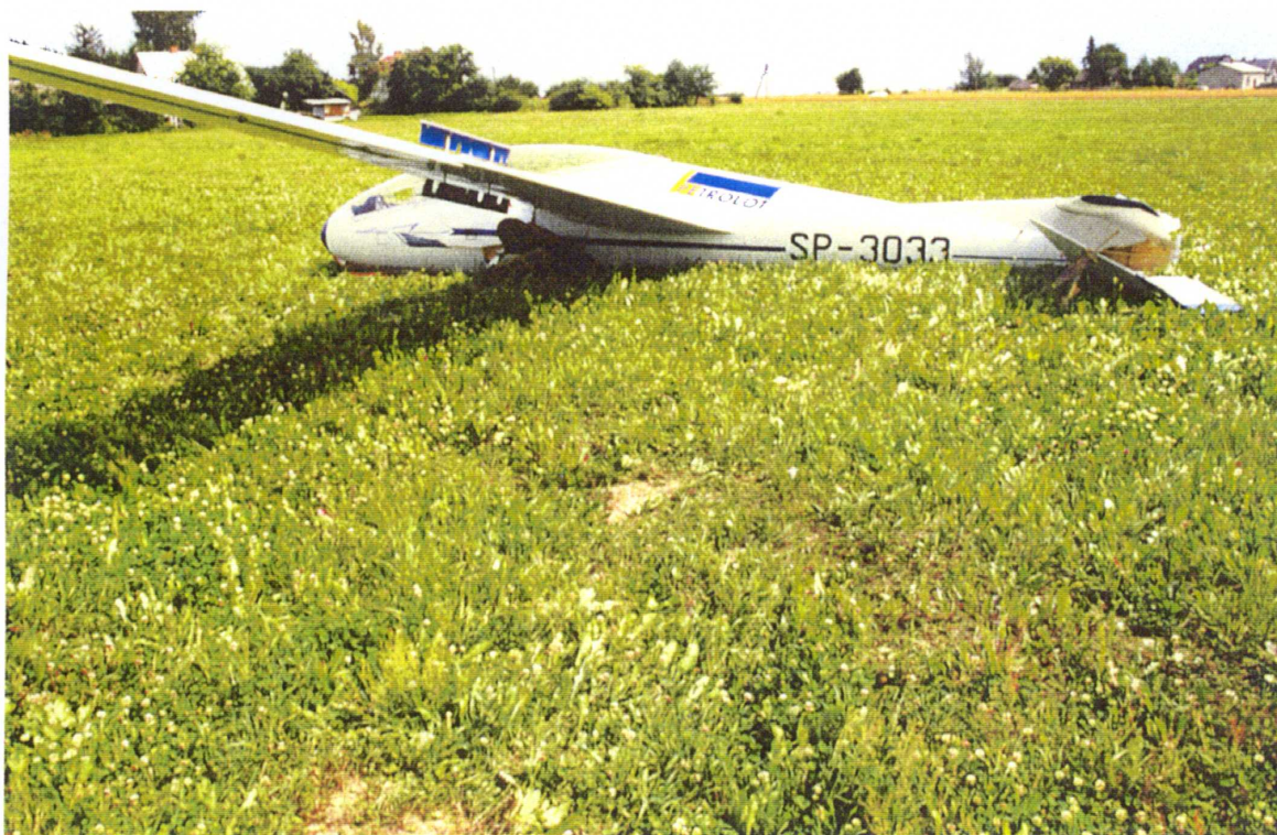
Fot. 6 Widok na uszkodzone podwozie i usterzenie
