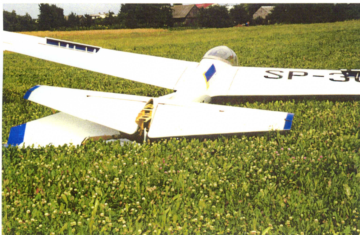
Fot. 8 Uszkodzone usterzenie pionowe – widok z tyłu
