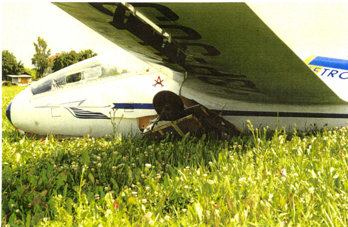
Fot. 5 Widok uszkodzeń podwozia i kadłuba
