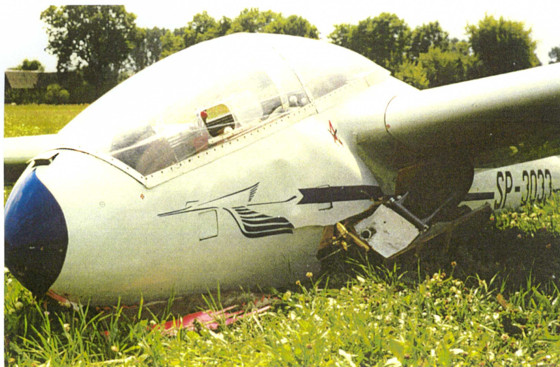
Fot. 4. Uszkodzona konstrukcja podwozia
