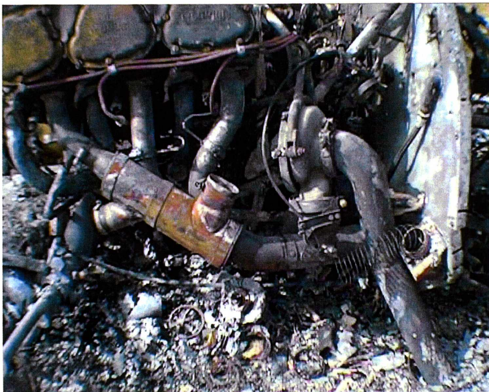
Fot. 11. Widok lewej turbiny z kolektorem wydechowym.
