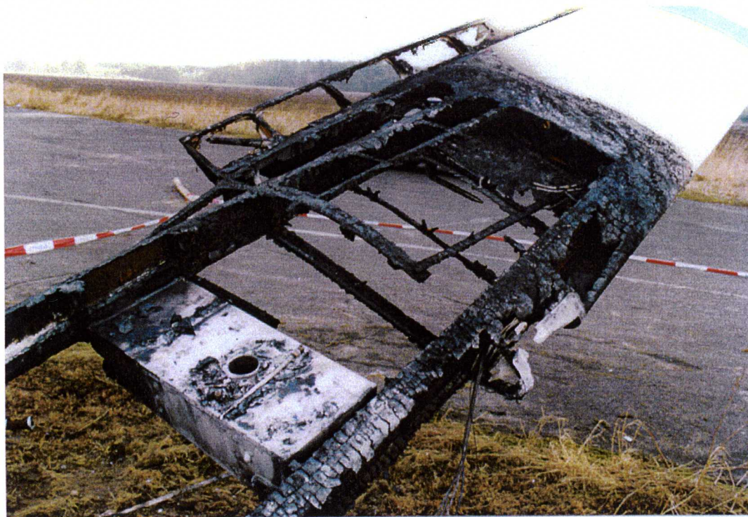
Fot. 9. Widok lewego skrzydła ze zbiornikiem paliwa.
