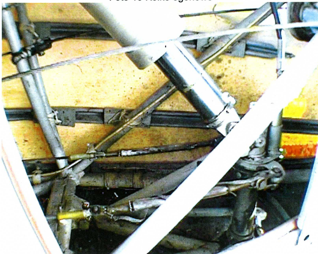
Foto 14 Węzeł sterowania tylnym kółkiem
