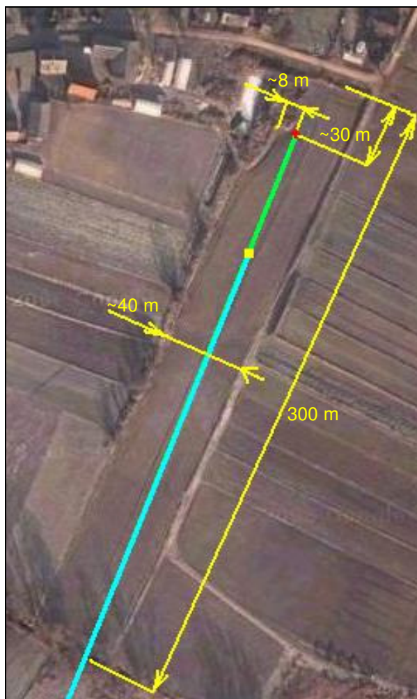
4 – Pole, na którym wylądował samolot z zaznaczonym miejscem wypadku, śladami kół i wymiarami.
