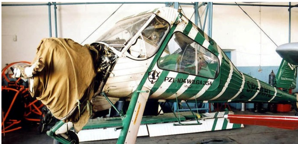
14 – Kadłub samolotu w hangarze po wypadku. Na drugim planie widoczne zdemontowane skrzydła i usterzenie poziome.
