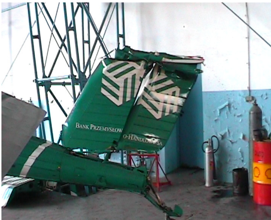
Fot. 3 Uszkodzony statecznik pionowy
