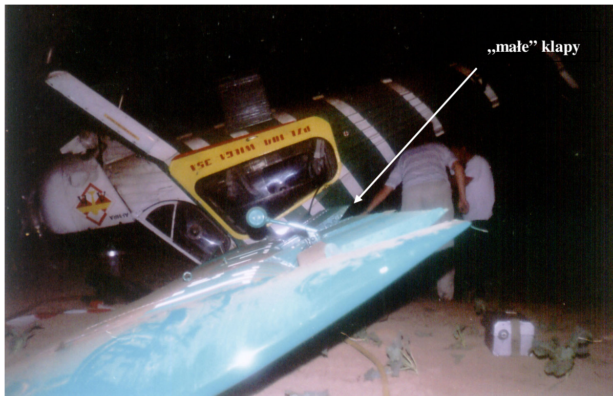
Fot. 1 Widok samolotu po kapotażu (na zdjęciu widoczne klapy w położeniu „małe”)
