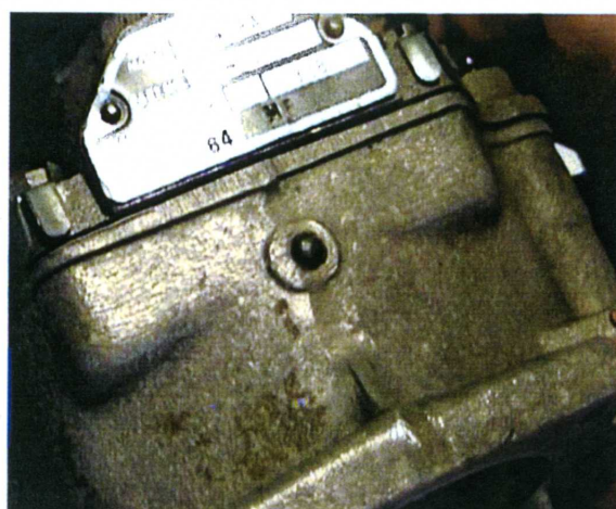
14. Dla porównania otwór prawidłowo zaślepiony kulką na innym gaźniku.
