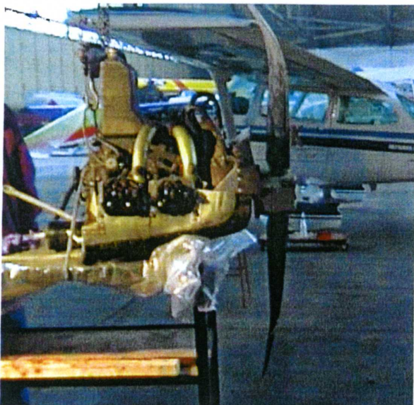
9. Ogólny widok zdemontowanego zespołu napędowego, pogięte śmigło, urwany gaźnik.
