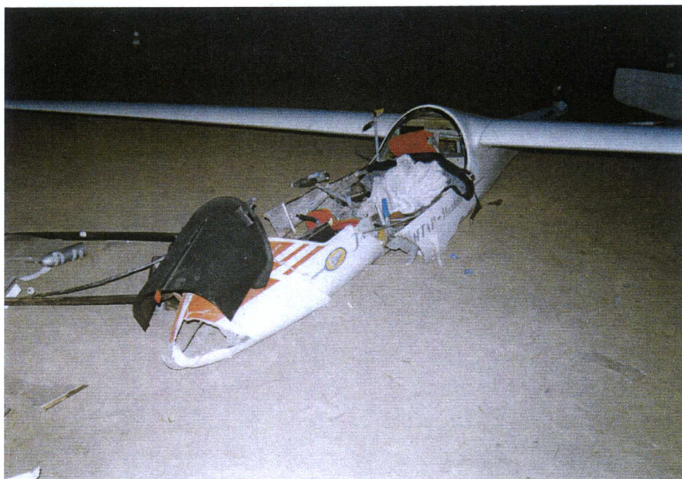
Fot. 4. Zniszczona kabina.
