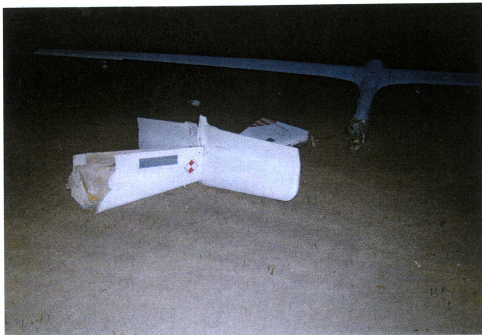
Fot. 12. Zniszczone usterzenie ogonowe.
