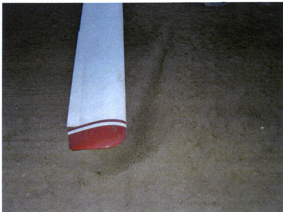
fot. 14. Końcówka prawego skrzydła ze śladem odbitym w gruncie.
