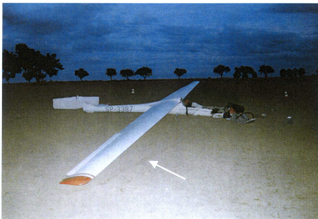
Fot. 2. Widok ogólny od strony północno- zachodniej ze śladem uderzenia krawędzi natarcia odbitym w gruncie.
