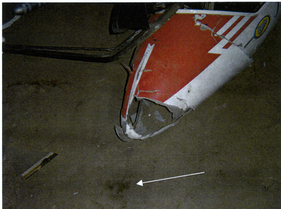
Fot. 13. Zniszczona przednia część kadłuba ze śladem odbitym w gruncie.
