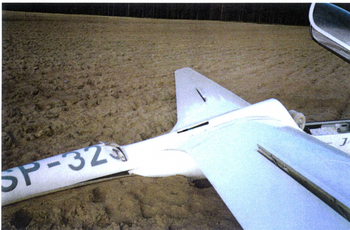
Fot. 6. Widok na miejsce złamania kadłuba.
