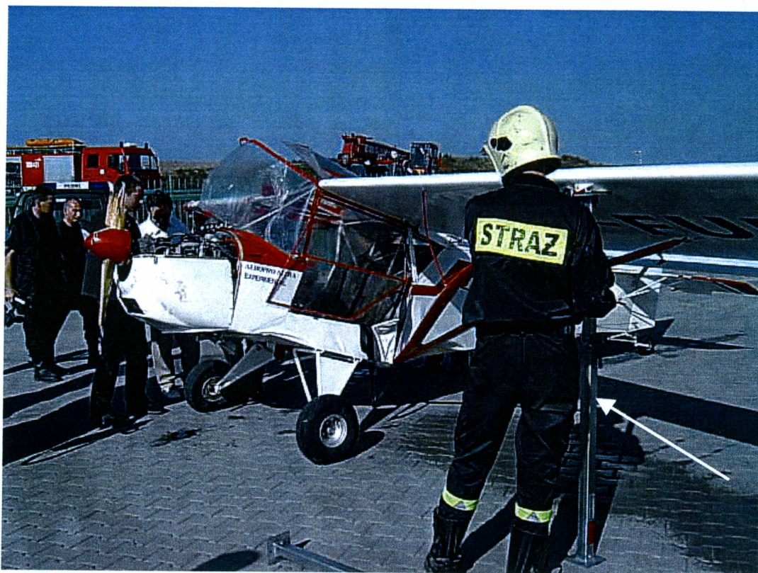
Fot. 7. Ustawianie podpory pod lewe skrzydło.
