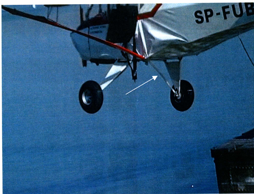
Fot. 5. Widok podwozia po wydobyciu samolotu z jeziora. Wygięty zastrzał prawego podwozia.
