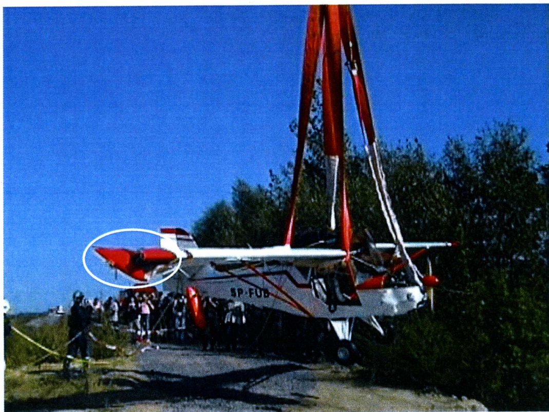
Fot. 3. Transport samolotu po wydobyciu z jeziora. Wyrwana końcówka prawego skrzydła.
