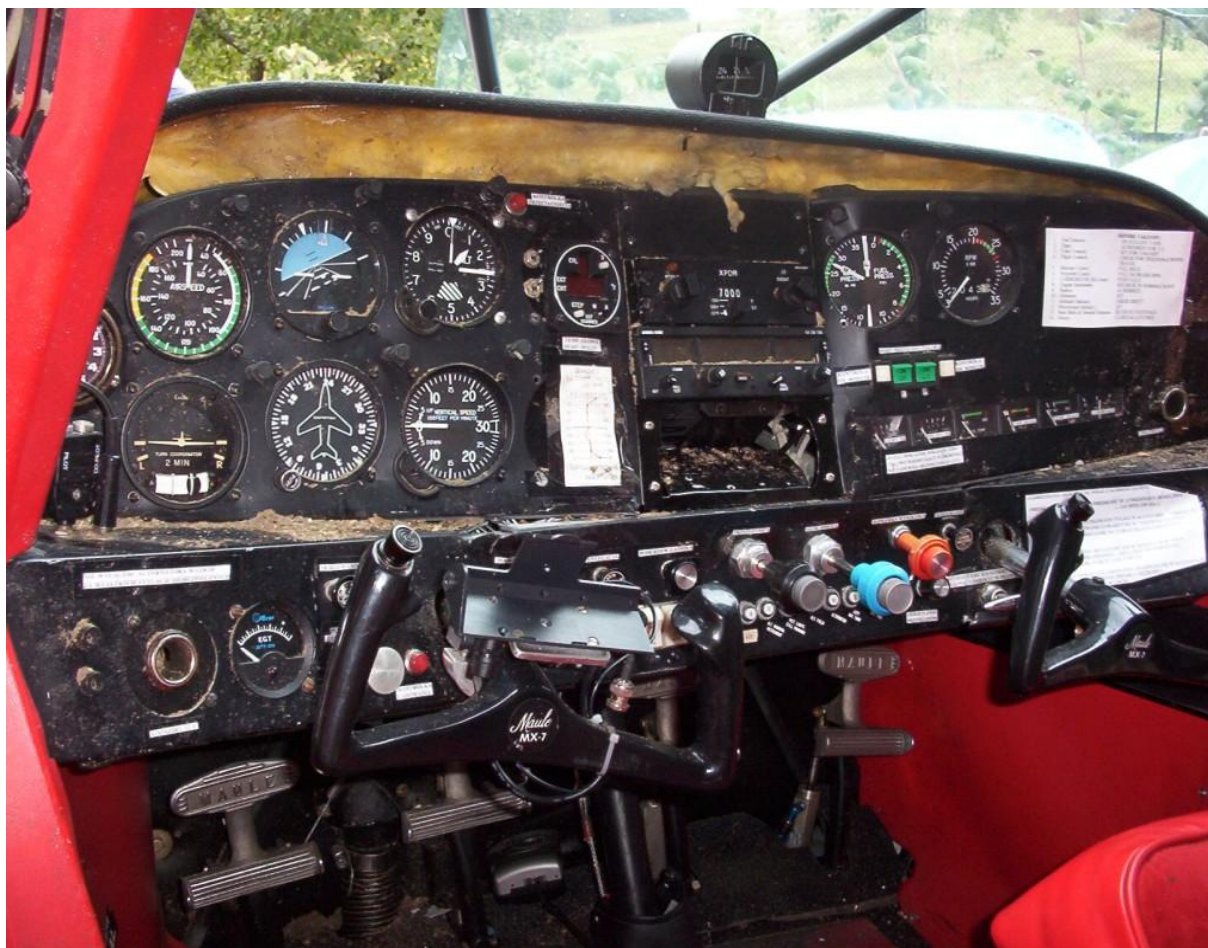
22 – Wnętrze kabiny z tablicą przyrządów.
