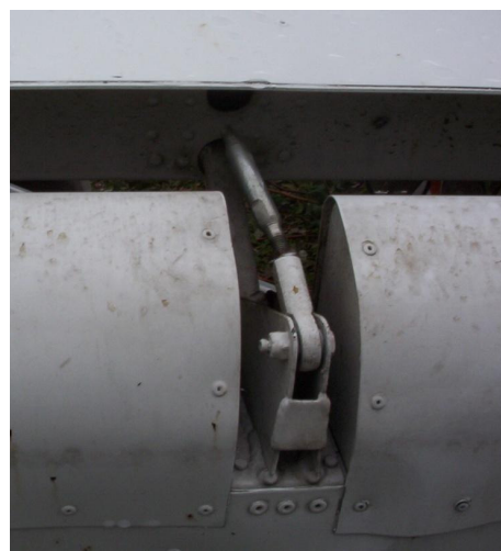
18 – Wspornik kłapy i urwany popychacz napędu kłapy lewego skrzydła.
