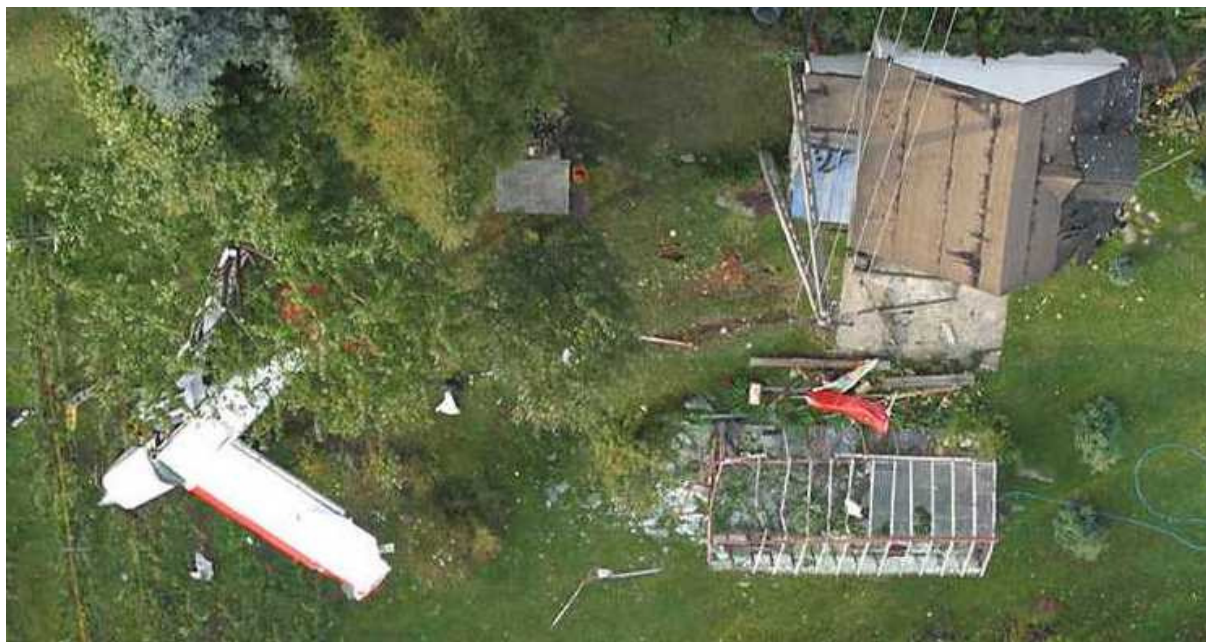
5 – Ogólny widok miejsca wypadku z powietrza. Przyziemiacący samolot przeszedł między domkiem a szklarnią prawie równoległe do dolnej krawędzi zdjęcia, zaczepiając skrzydłami o oba budynki i powodując ich uszkodzenia.
