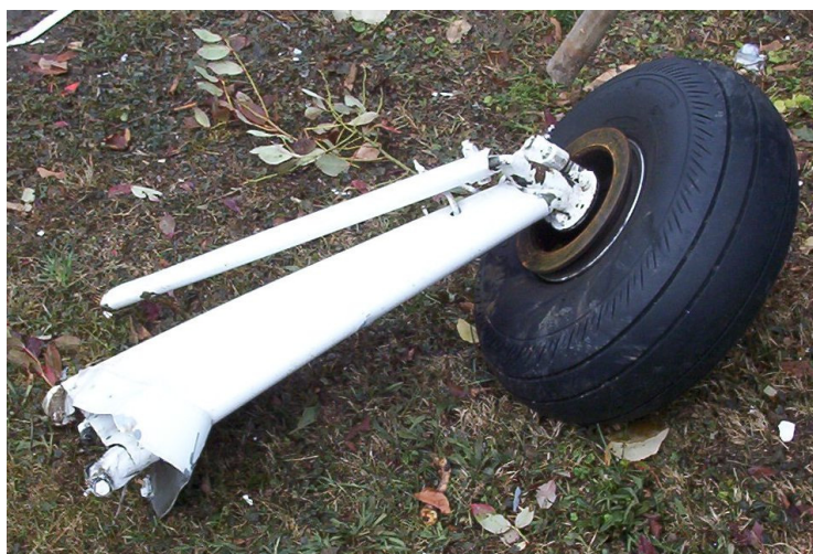
17 – Wyłamane prawe podwozie główne.
