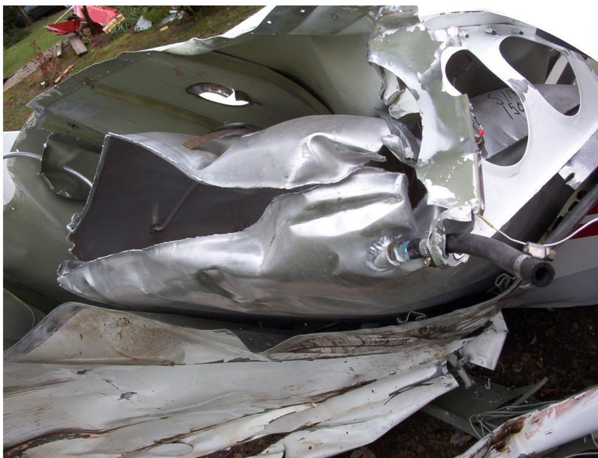
12 – Zniszczenia prawego skrzydła, widoczny rozdarty zbiornik paliwowy.
