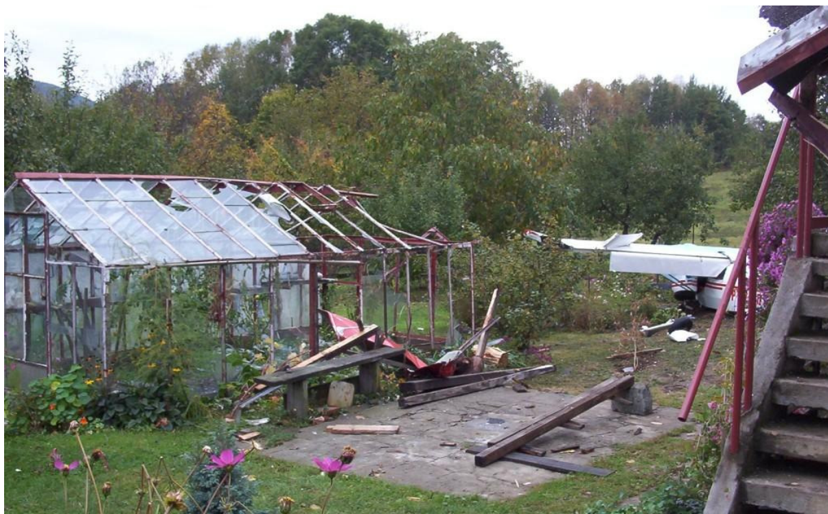
19 – Uszkodzony przez lewe skrzydło samolotu budynek szklarni, na drugim planie rozbity samolot. W prawym górnym rogu kadru widać fragment dachu piętrowego domu, uszkodzonego prawym skrzydłem samolotu.
