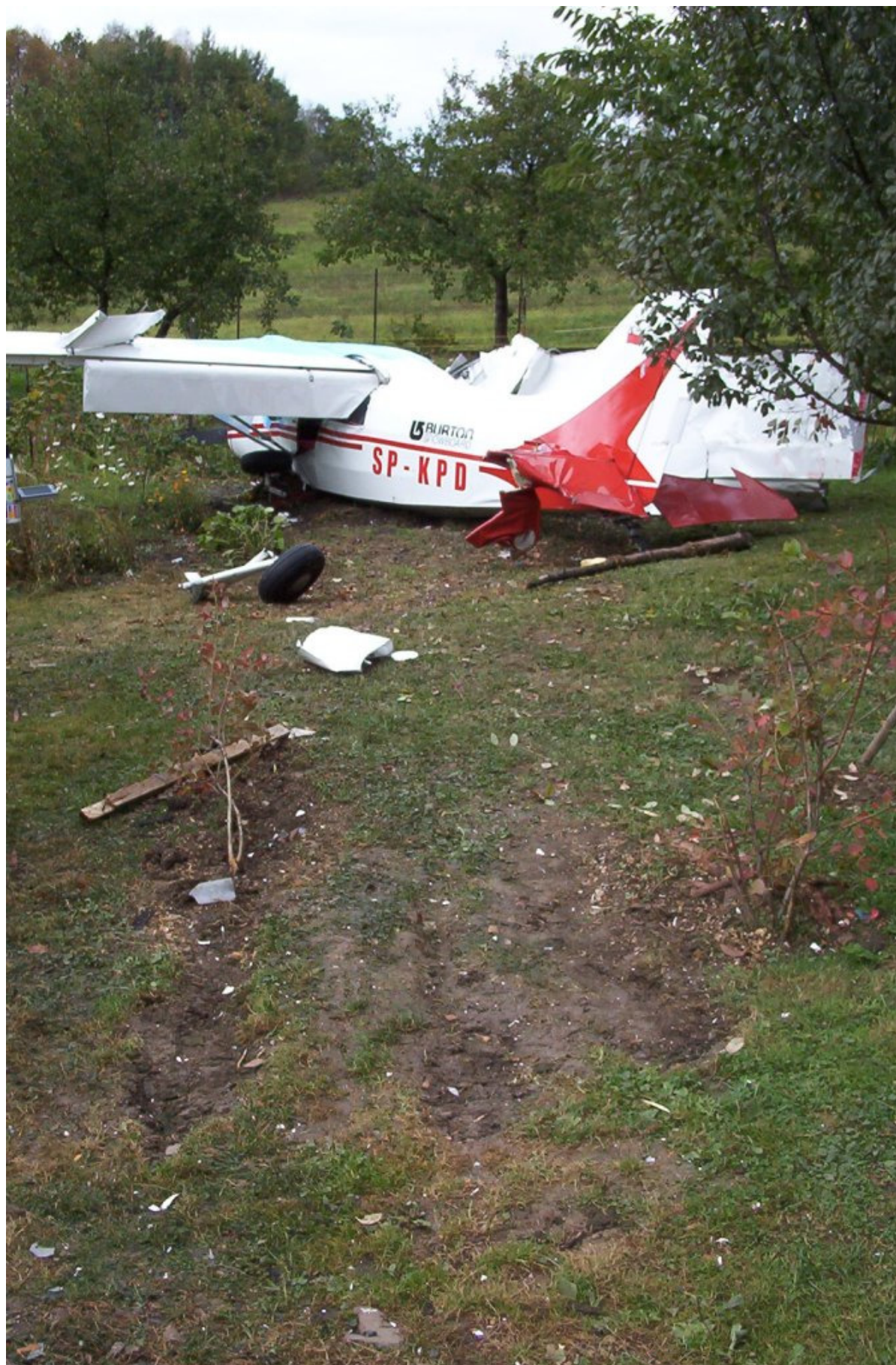
8 – Ślad przyziemienia, rozbitý samolot i jego szczątki.
