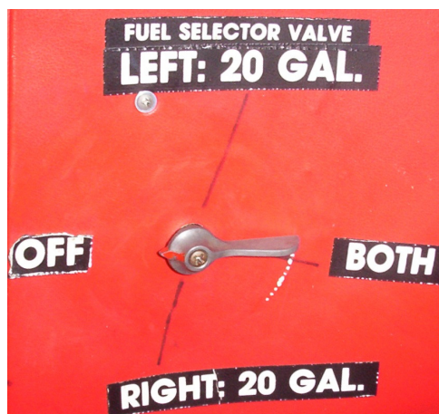
28 – Przełącznik głównego zaworu paliwowego (w położeniu zamkniętym).
