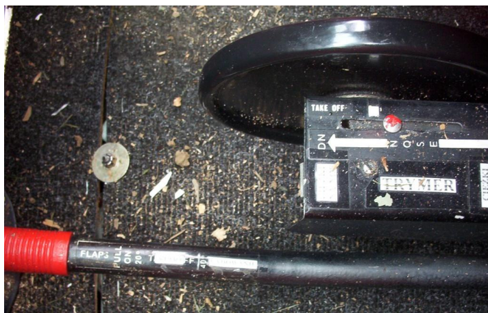
27 – Dźwignia sterowania klap (u dołu) i pokrętko trymera steru wysokości z sygnalizatorem położenia.
