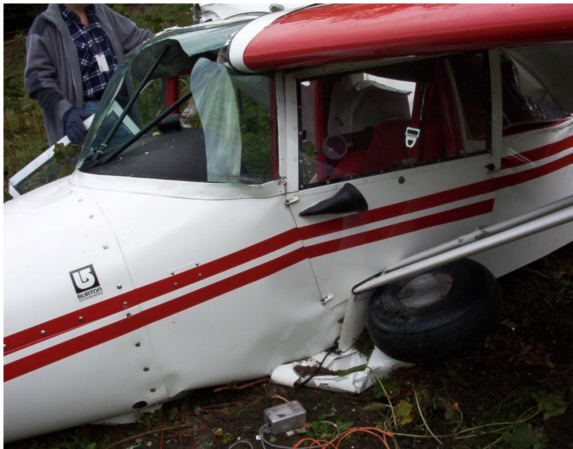
14 – Przód kadłuba z lewej strony, widoczne wyłamane lewe podwozie główne i zastrzał lewego skrzydła, złamany przy kadłubie przez koło podwozia.
