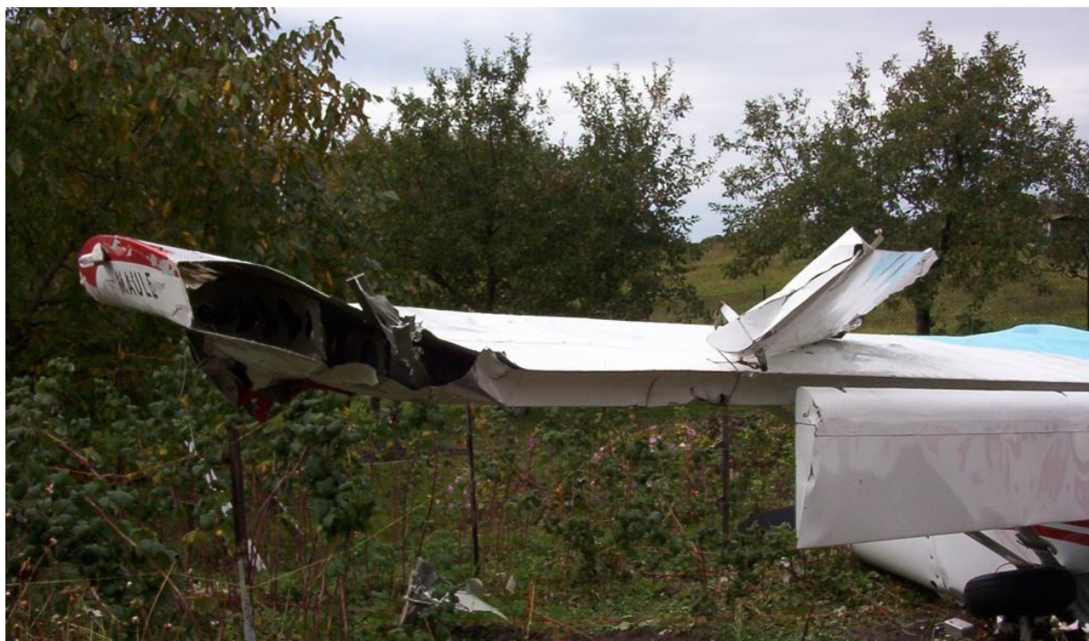
11 – Zniszczenia lewego skrzydła.
