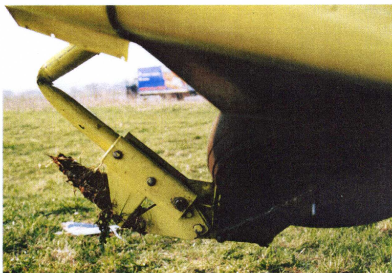
Fot. 9. Widok uszkodzeń goleni i kółka przedniego
