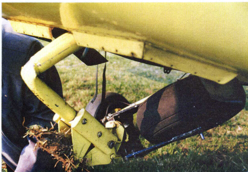
Fot. 7. Widok uszkodzeń kółka przedniego po podniesieniu samolotu
