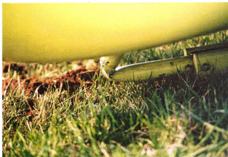
Fot. 6. Widok uszkodzeń goleni kółka przedniego
