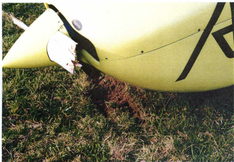
Fot. 5 widok uszkodzeń drugiej łopaty śmigła
