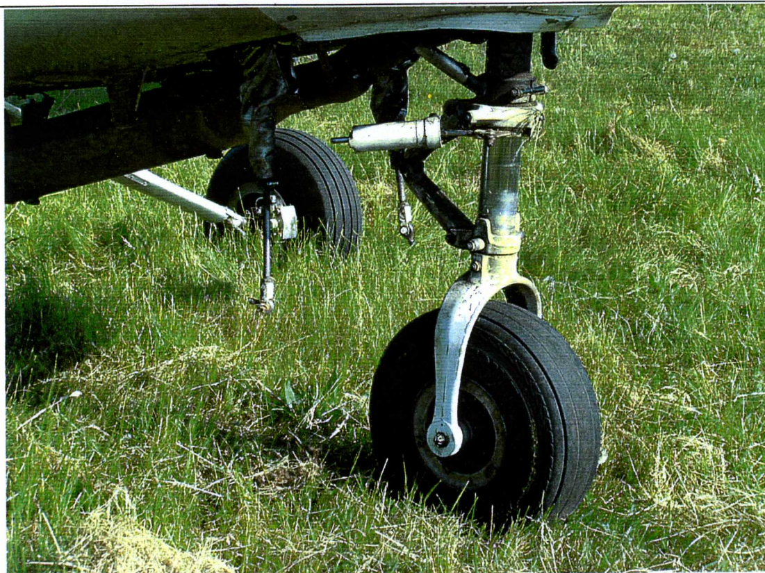
Foto 5 Widok uszkodzonej przedniego podwozia
