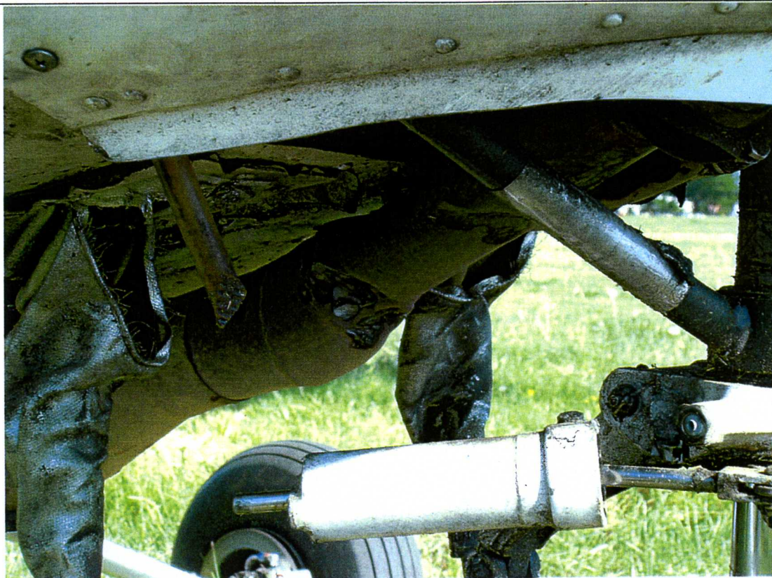
Foto 7 Uszkodzony tłumik drgań
