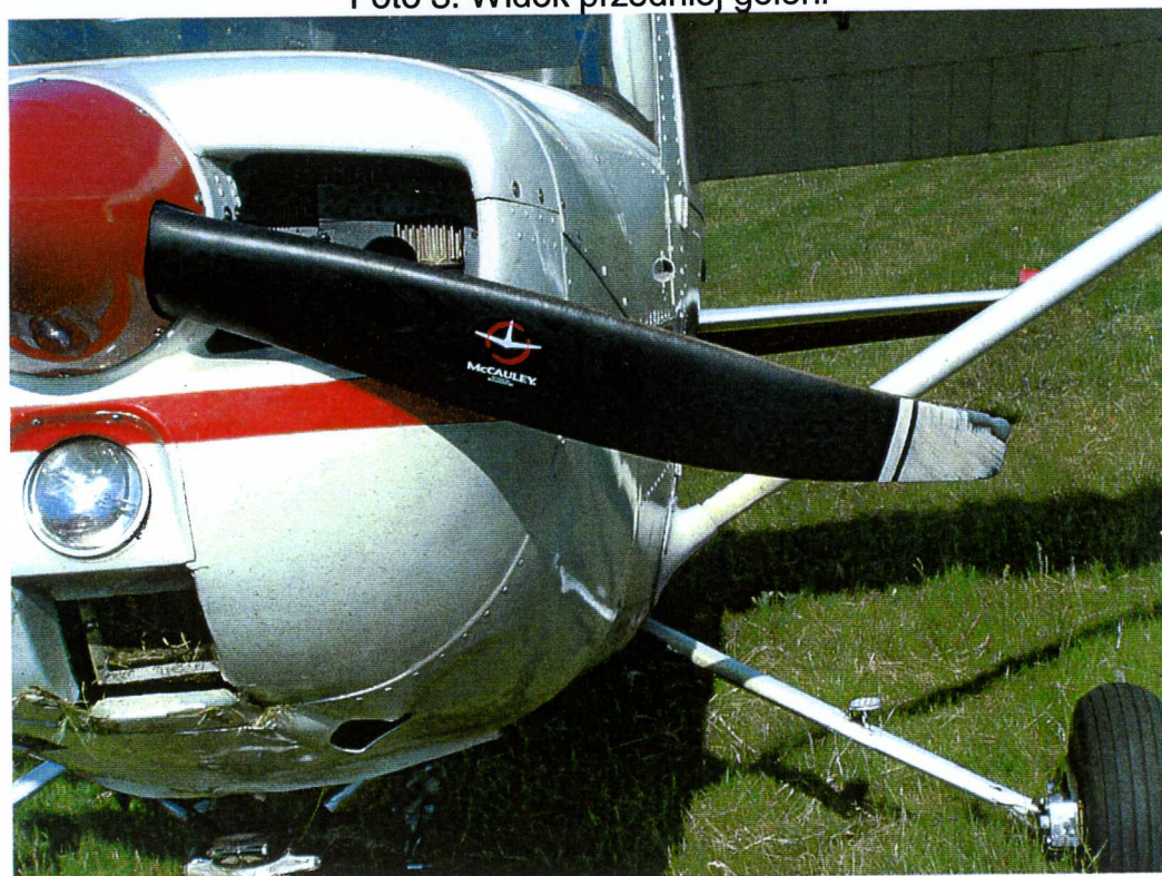
Foto 4 Uszkodzenia od przodu
