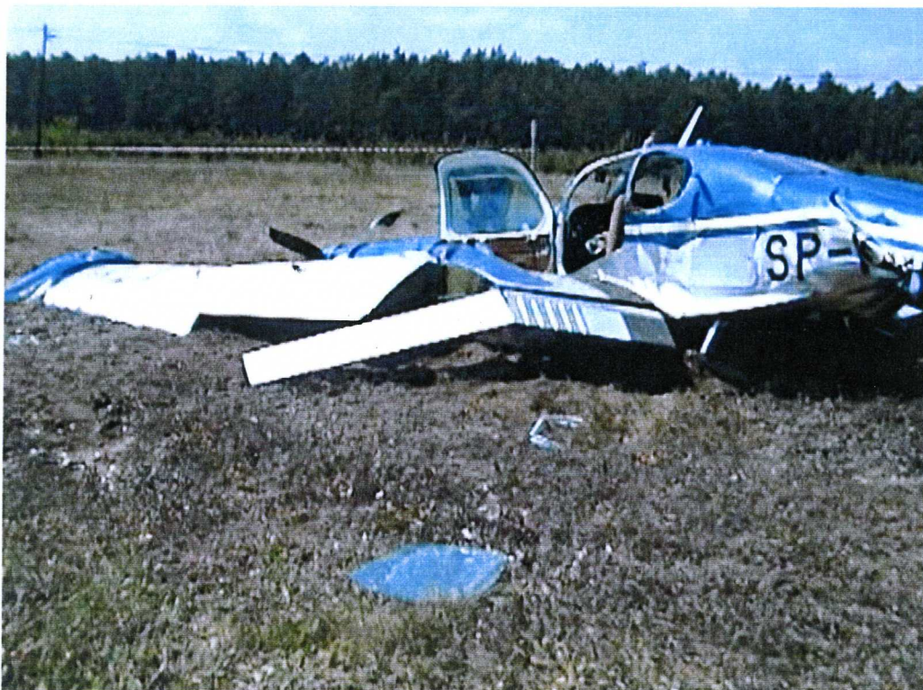
Zdjęcie 10 Widok wyrwanego lewego skrzydła za silnikiem i klapy
