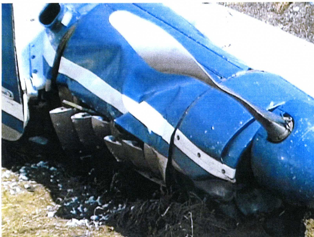
Zdjęcie 16. Otwarte zasłonki chłodzenia na silniku
