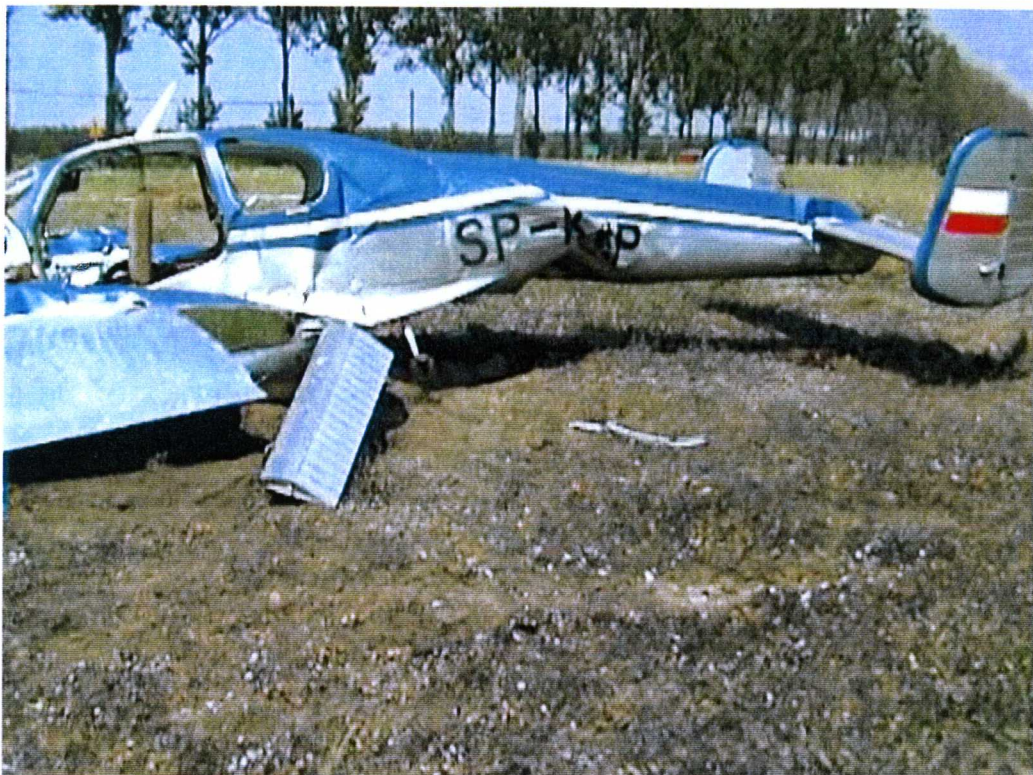
Zdjęcie 9. Przełamanie kadłuba za bagażnikiem
