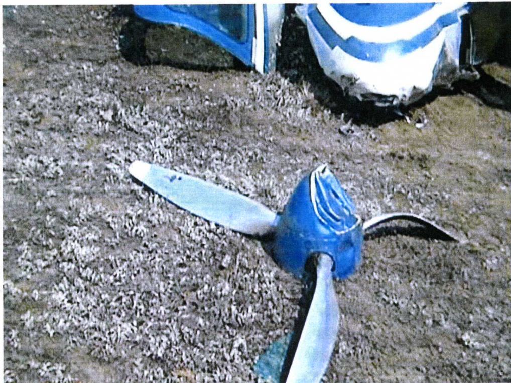
Zdjęcie 4. Urwane śmigło prawego silnika
