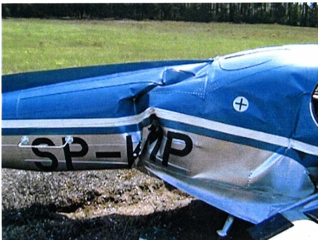
Zdjęcie 7. Widok z prawej strony złamania kadłuba za bagażnikiem
