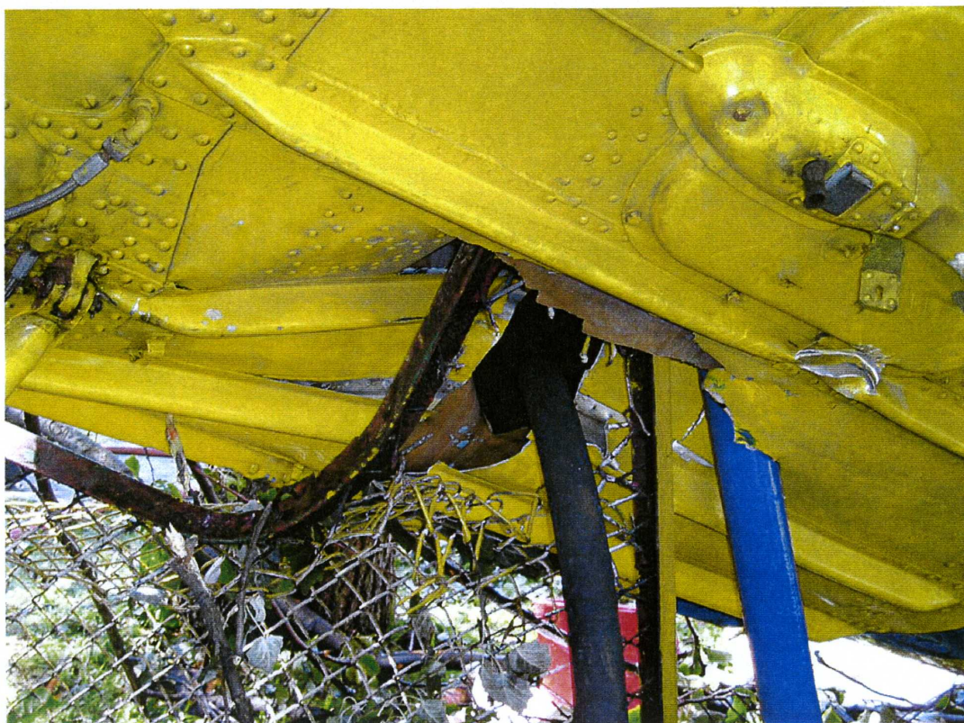
Fot. 5. Przebicie kadłuba przez płot ogrodzający.
