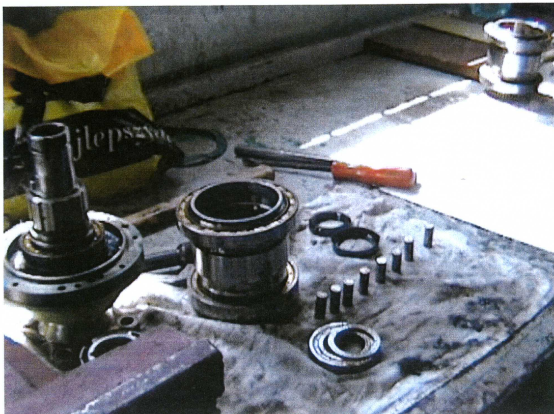
Fot.10. Widok zdemontowanego sprzęgła lewego silnika (pkt 6 protokołu z dnia 10.06.2003)
