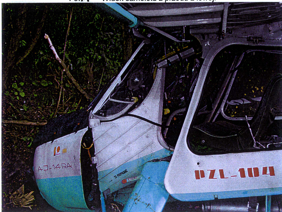
Fot. 8 Samolot po uderzeniu silnikiem w burtę rowu.
