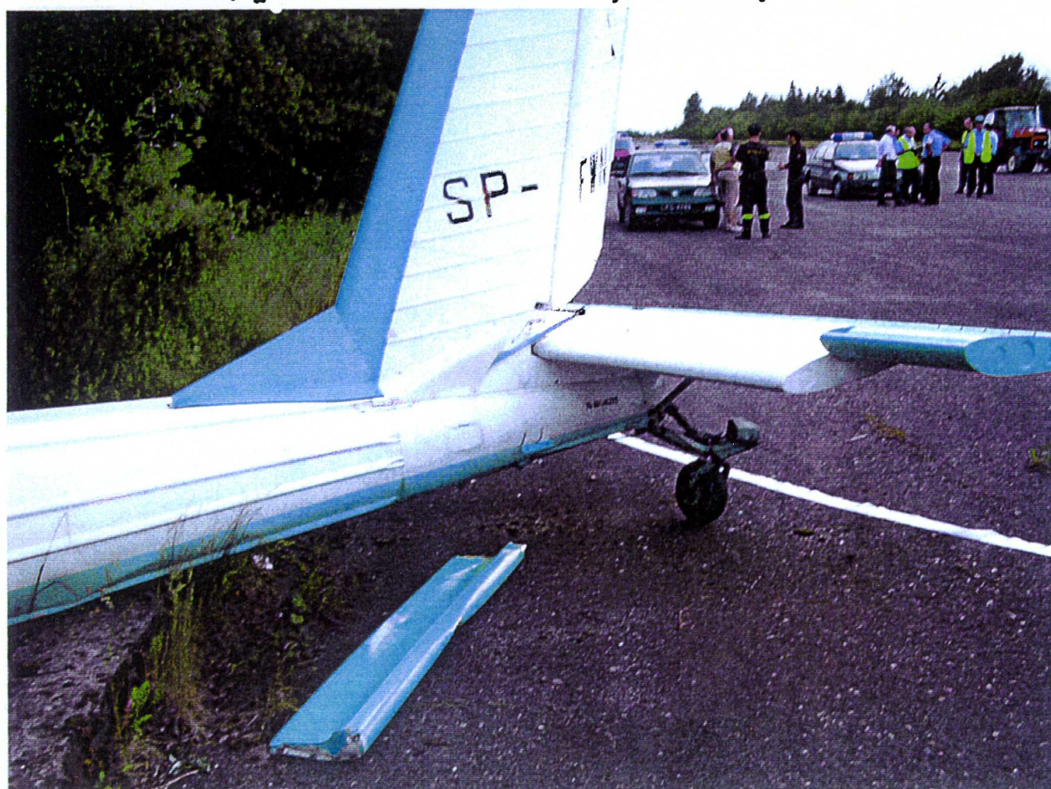
Fot. 2 Urywany slot i uszkodzenia opierzenia ogonowego.
