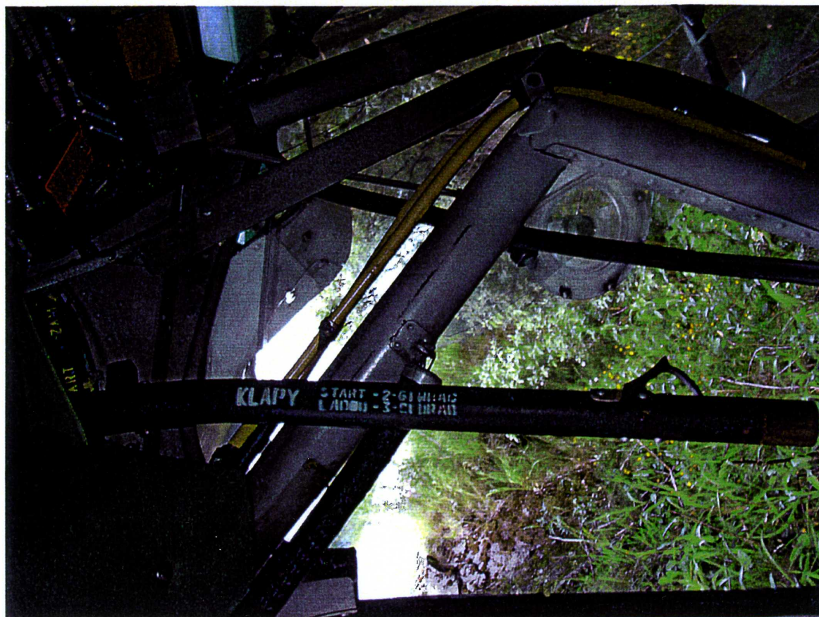
Fot. 11 Położenie klap do lądowania.
