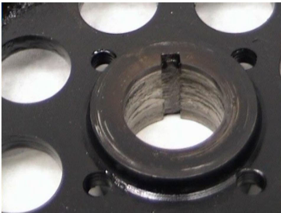
Fot.11 – Koło zębate 13M-05-01 – w piaście koła widoczny rowek pod wpust z resztkami ściętego wpustu 13S-00-87.
