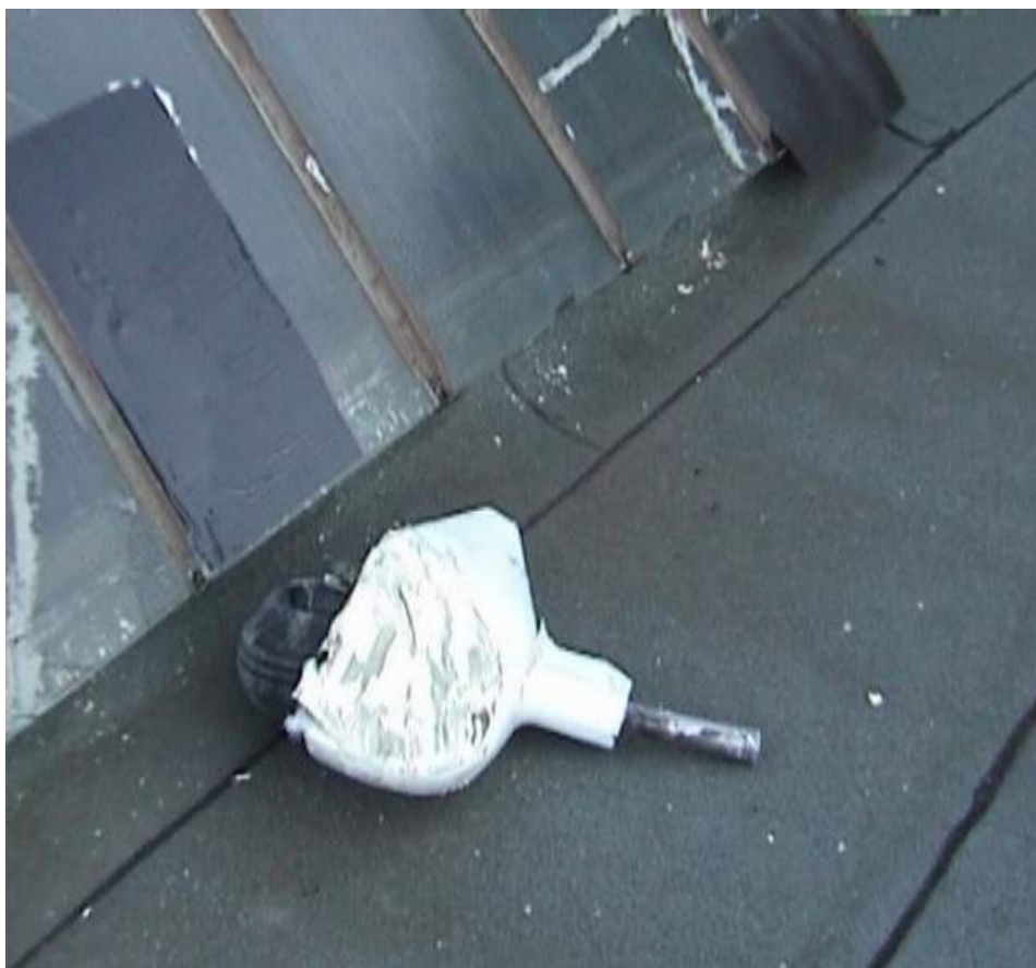
Fot.2 – Odłamane podwozie przednie, leżące na dachu niższego przyległego budynku pod miejscem uderzenia.
