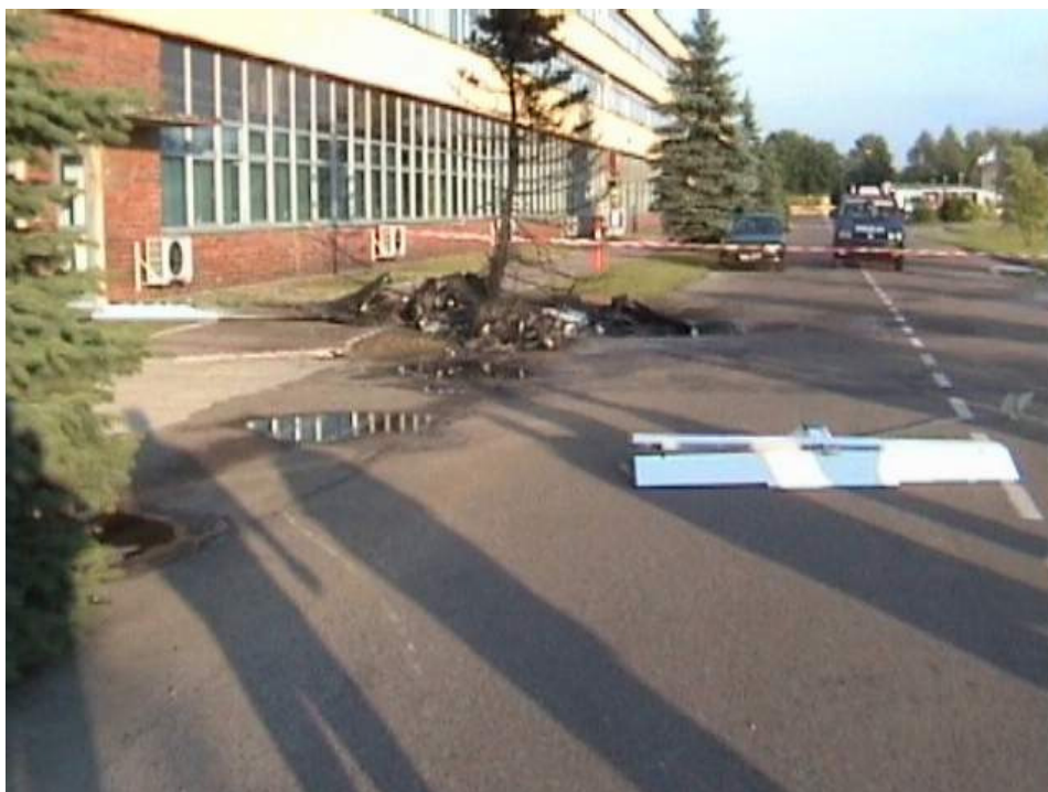
Fot.7 – Szczątki samolotu - na pierwszym planie usterzenie poziome, oderwane wraz z zakończeniem kadłuba
