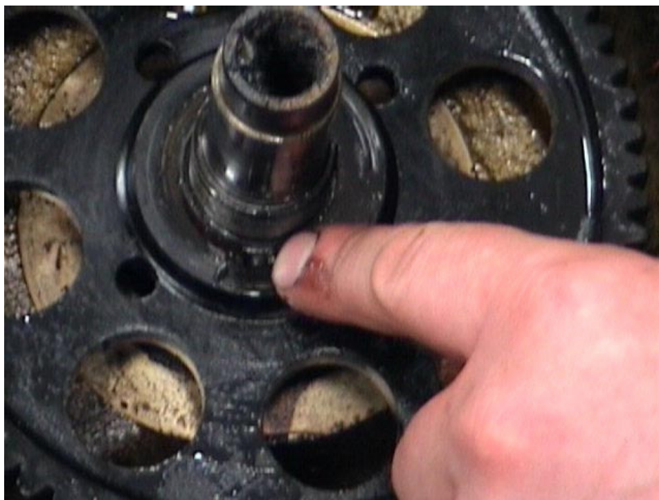
Fot.10 – Koło zębate 13M-05-01 osadzone na wałku 13M-05-03 – widoczny rowek pod wpust 13S-00-87.
