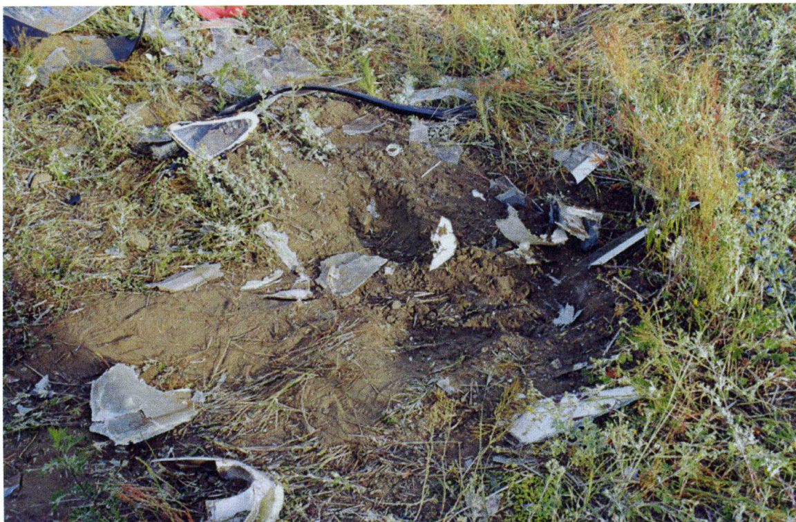
fot. 9. Ślad uderzenia przedniej części kadłuba w ziemię.
