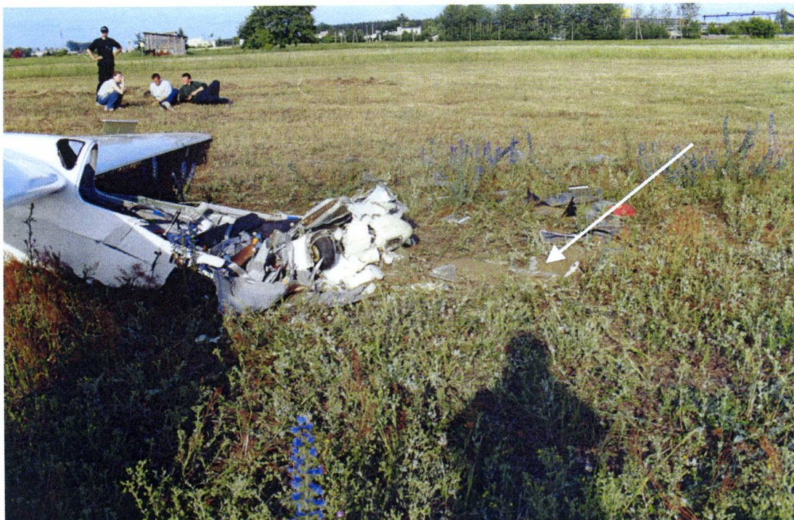
fot. 7. Przednia część kadłuba. Ślad uderzenia w ziemię przednią częścią kadłuba.
