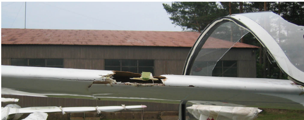
Fot.2 – Uszkodzenia krawędzi natarcia statecznika poziomego.
