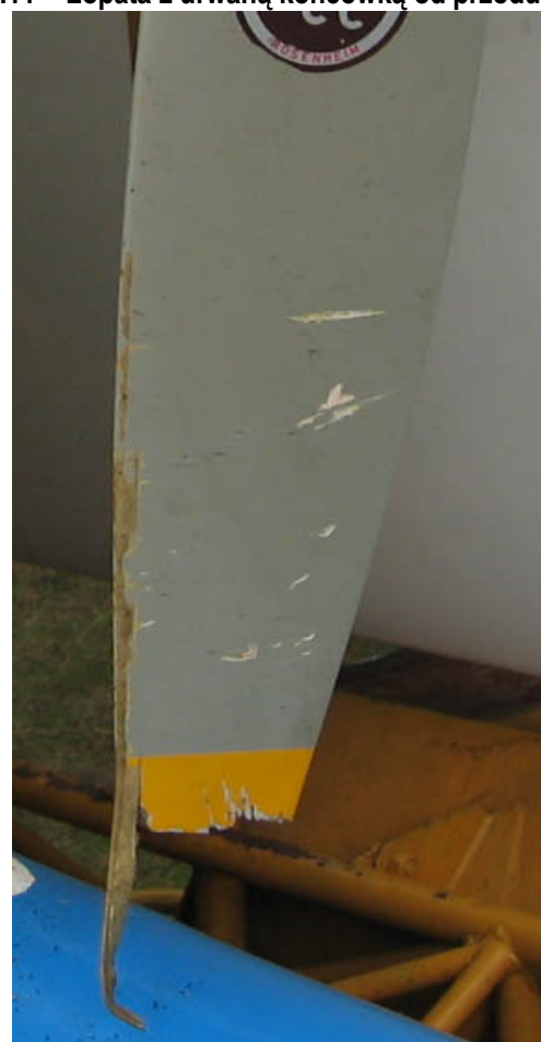
Fot.12 – Łopata z urwaną końcówką od tyłu.
