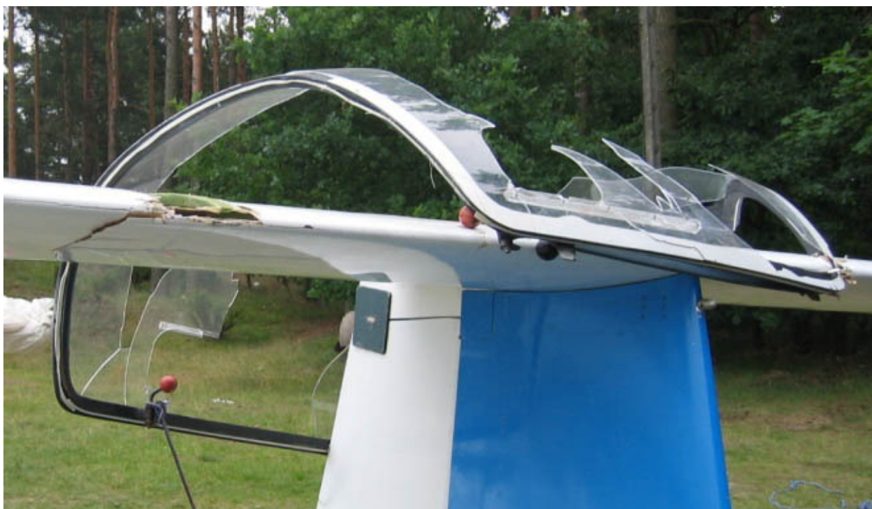
Fot.1 – Rama zniszczonej osłony kabiny na usterzeniu, prawa strona.
