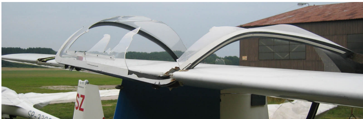
Fot.3 – Rama zniszczonej osłony kabiny na usterzeniu, lewa strona.
