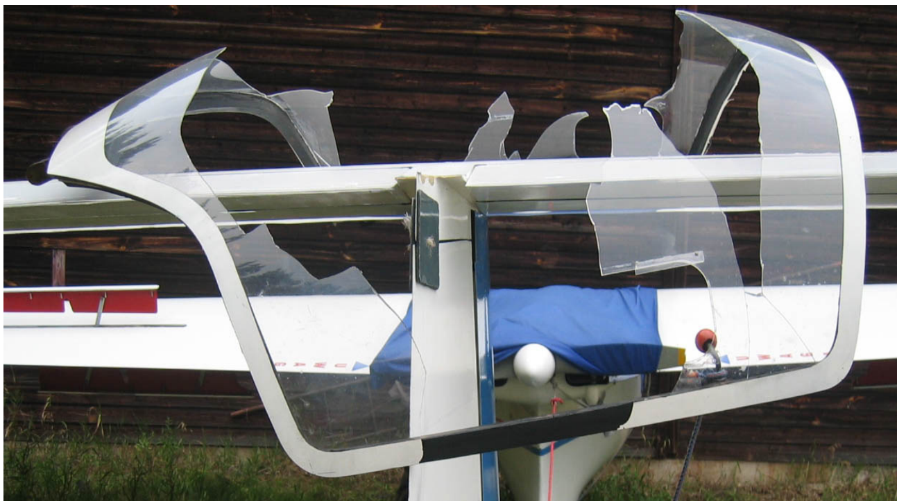
Fot.4 – Rama zniszczonej osłony kabiny na usterzeniu, widok od tyłu.
