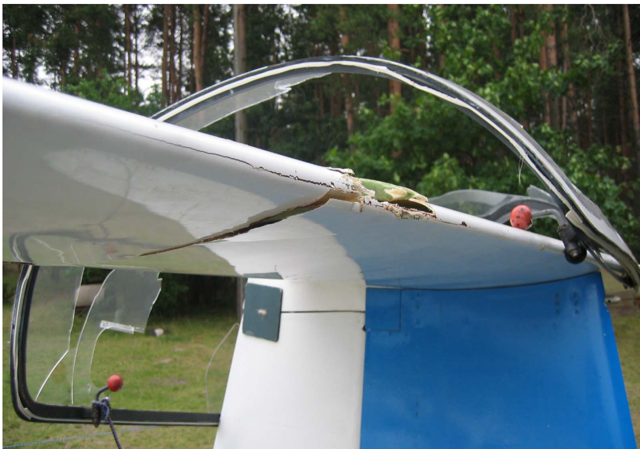
Fot.5 – Uszkodzenia krawędzi natarcia statecznika poziomego.
