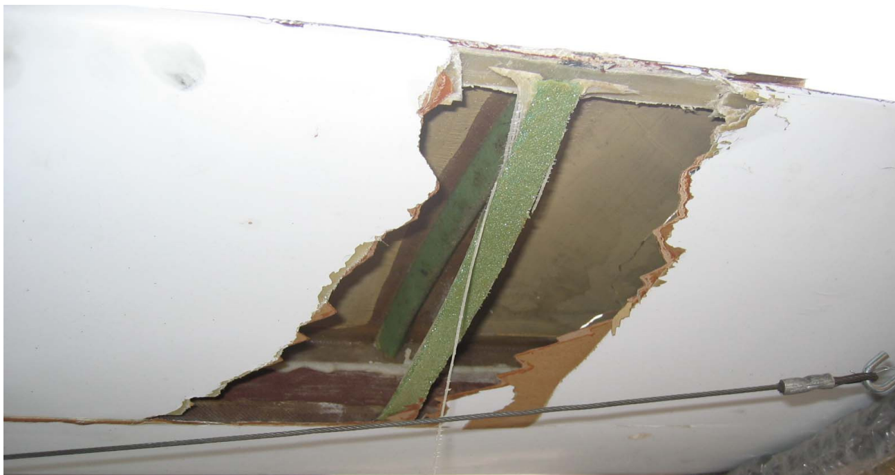
Fot.6 – Uszkodzenia krawędzi natarcia statecznika poziomego, dolne pokrycie częściowo usunięte.
