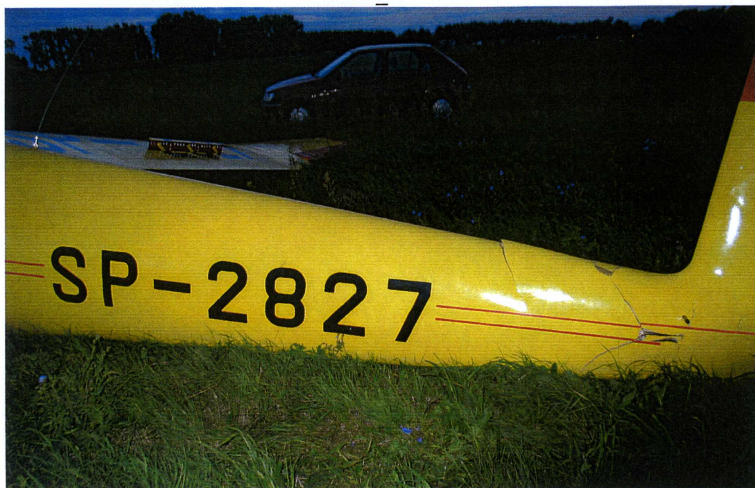
Foto 7 Widok pęknięć z lewej strony
