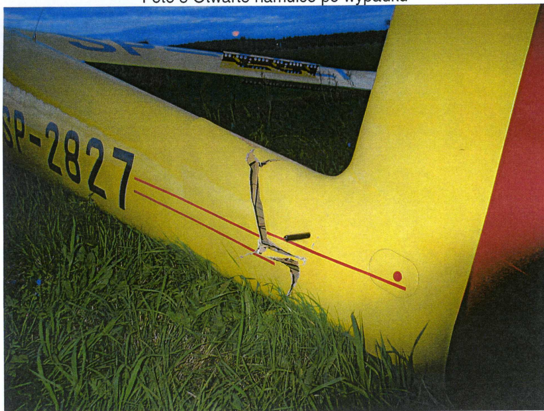
Foto 6 Pęknięcie kadłuba przed statecznikiem pionowym
