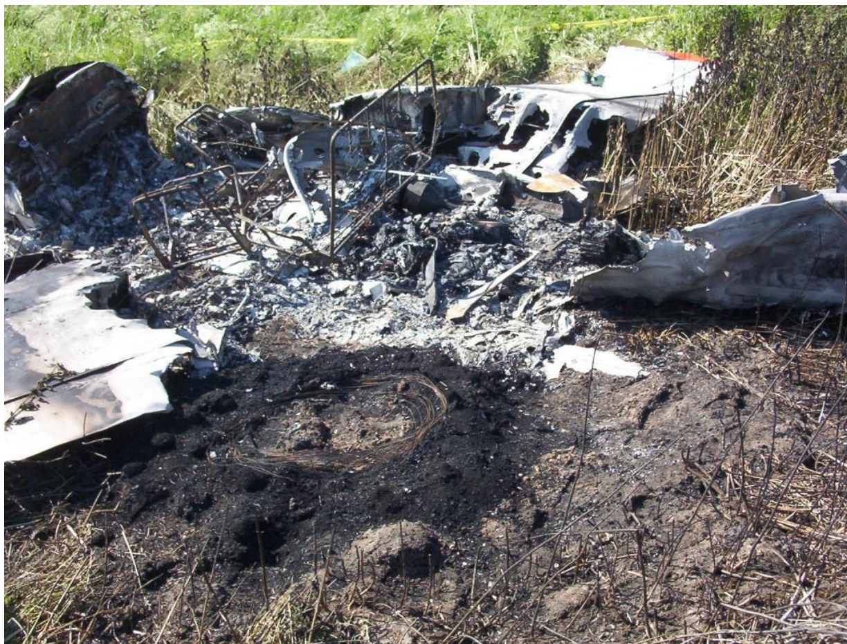
13 – Spalone szczątki kadłuba, kabiny i skrzydeł. Na pierwszym planie owalny ślad po spalonej oponie lewego koła głównego.
