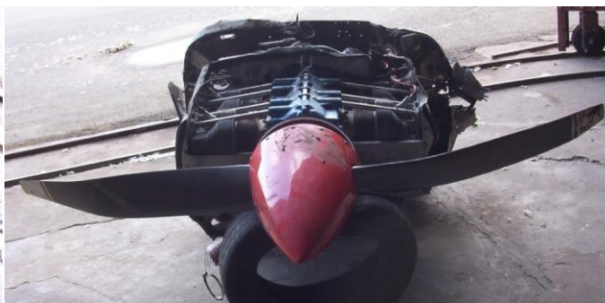
17 i 18 – Odcięty od szczątków zespół napędowy wraz z przegrodą ogniową i zniszczonym śmigłem – z lewej strony i od przodu.
