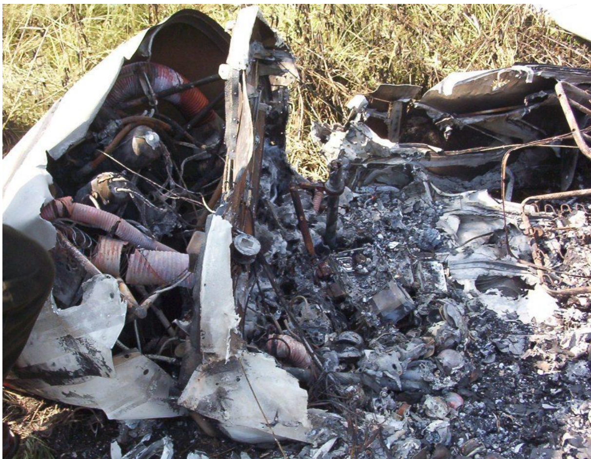
14 – Spalone szczątki kabiny i przedniej części kadłuba, widoczne agregaty zespołu napędowego i zniszczone przyrządy.
