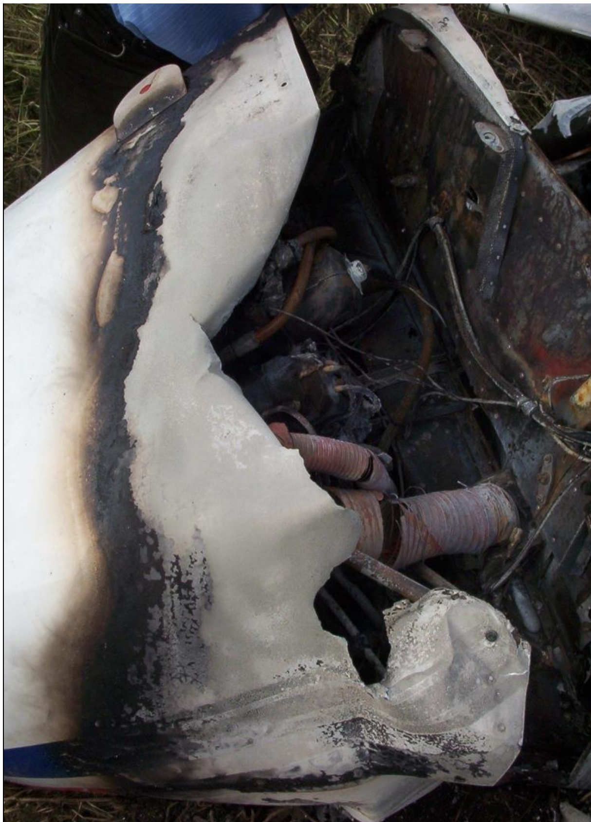
16 – Zniszczone osłony silnika i widoczne spod nich zniszczone agregaty silnika. Po prawej stronie kadru przegroda ogniowa.
