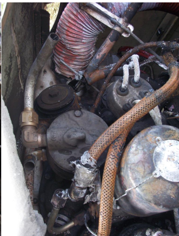
21 i 22 – Zbliżenie łoża silnika oraz zniszczonych pożarem agregatów i instalacji zespołu napędowego.
