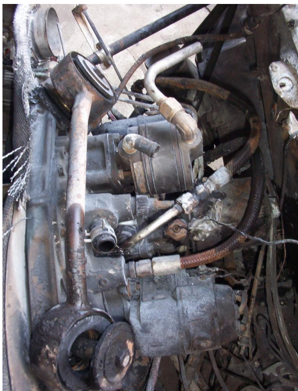
21 i 22 – Zbliżenie łoża silnika oraz zniszczonych pożarem agregatów i instalacji zespołu napędowego.
