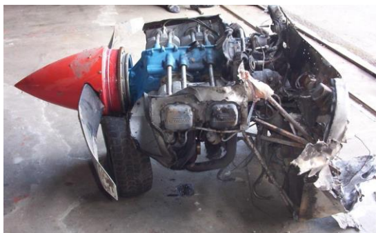
17 i 18 – Odcięty od szczątków zespół napędowy wraz z przegrodą ogniową i zniszczonym śmigłem – z lewej strony i od przodu.
