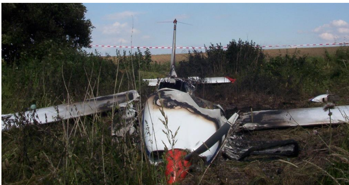
9 – Szczątki spalonego samolotu na miejscu wypadku w widoku od przodu. Widoczne zniszczone śmigło.
