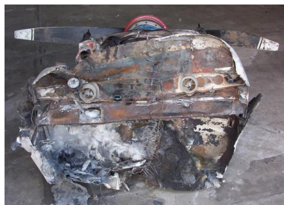
19 i 20 – Odcięty od szczątków zespół napędowy wraz z przegrodą ogniową i zniszczonym śmigłem – z prawej strony i od tyłu.
