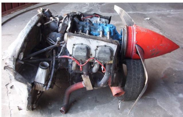
19 i 20 – Odcięty od szczątków zespół napędowy wraz z przegrodą ogniową i zniszczonym śmigłem – z prawej strony i od tyłu.
