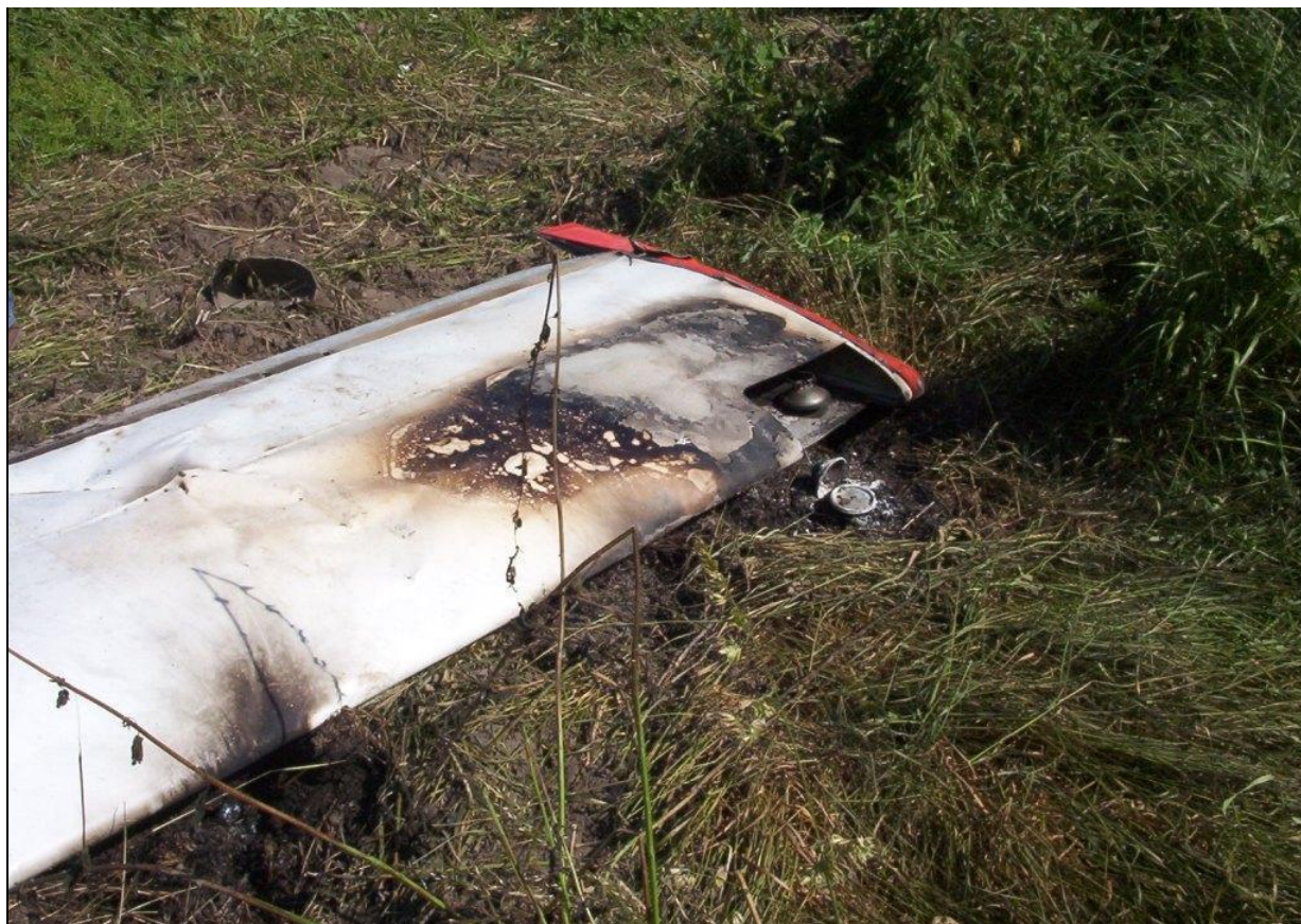
11 – Końcowa część lewego skrzydła. Widoczne strefy zacieków i pożaru paliwa.
