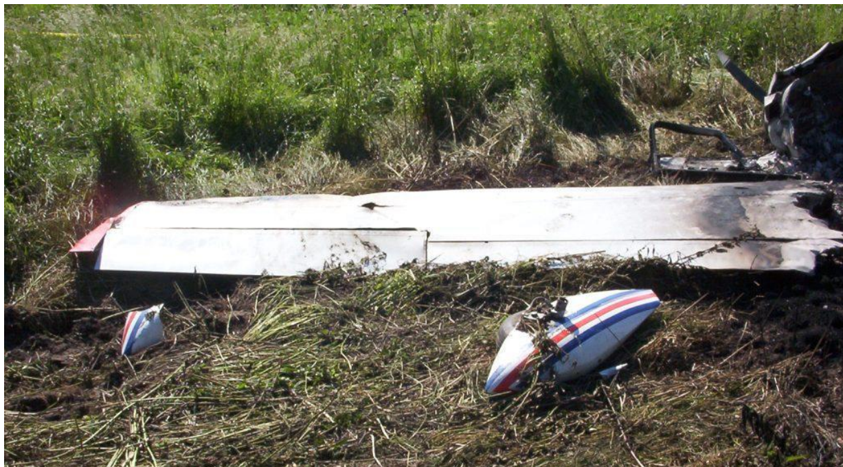
10 – Lewe skrzydło samolotu widziane od tyłu. Obok koło lewego podwozia głównego, oderwane od goleni wraz z owiewką.
