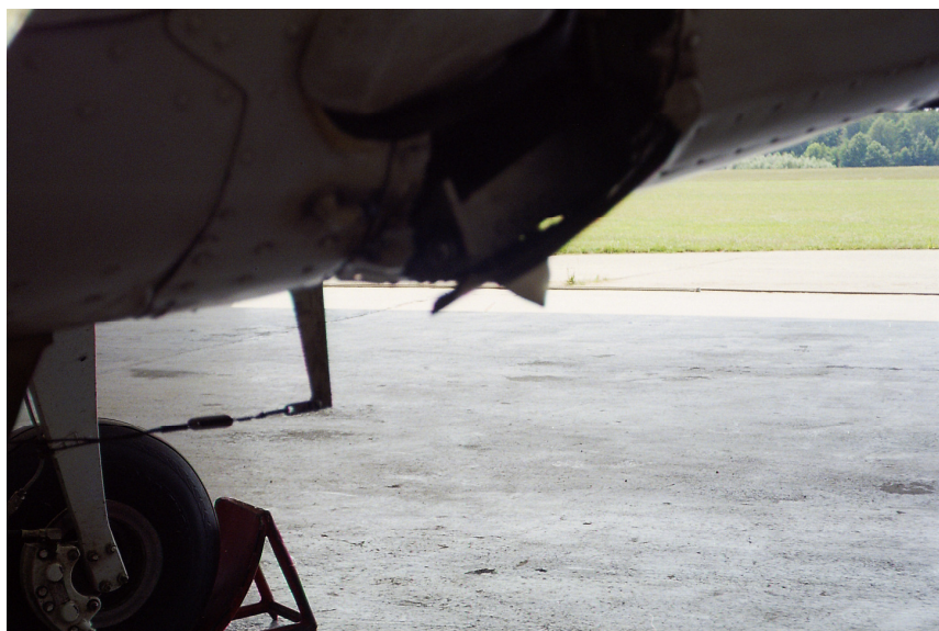
Fot.11 – Uszkodzone pokrycie kadłuba wokół otworu gniazda prawej gołeni podwozia głównego
