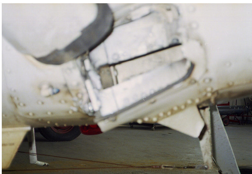
Fot.9 – Gniazdo wyłamanej nogi w kadłubie.
