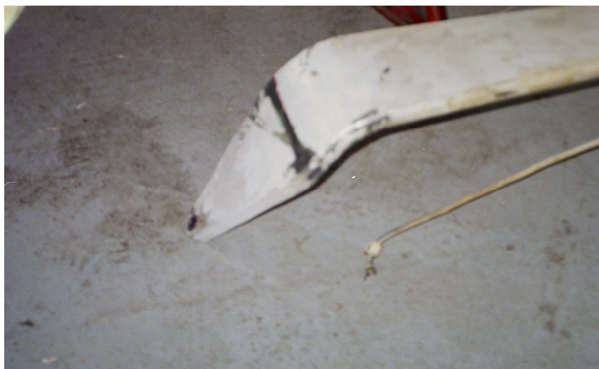
Fot.10 – Wylamana prawa goleń podwozia głównego.
