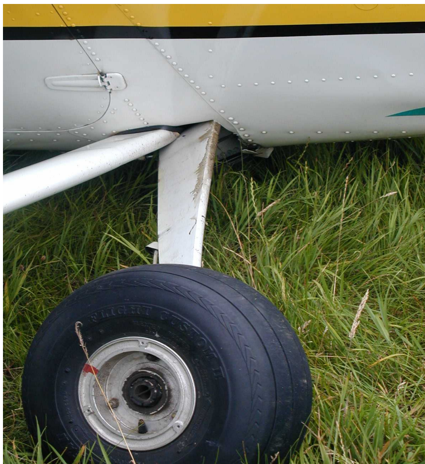
Fot.6 – Zbliżenie na wyłamane podwozie główne.
