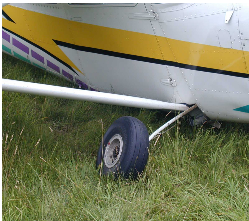
Fot.7 – Zbliżenie na wyłamane podwozie główne.
