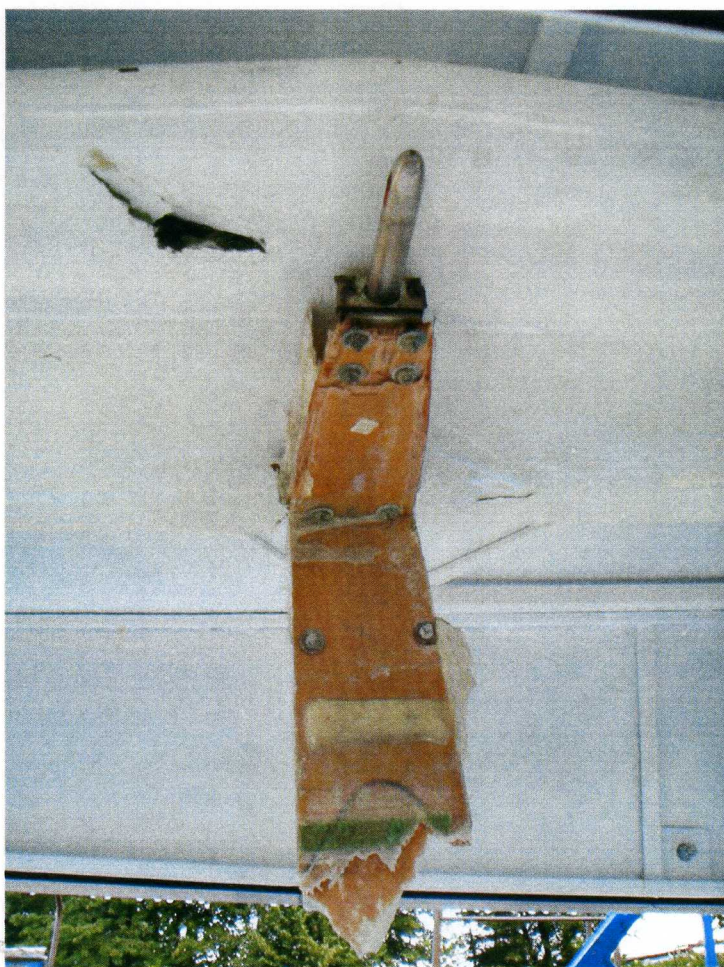
Fot. 23 – SP-3636: • usterzenie poziome z częścią konstrukcji statecznika pionowego.
