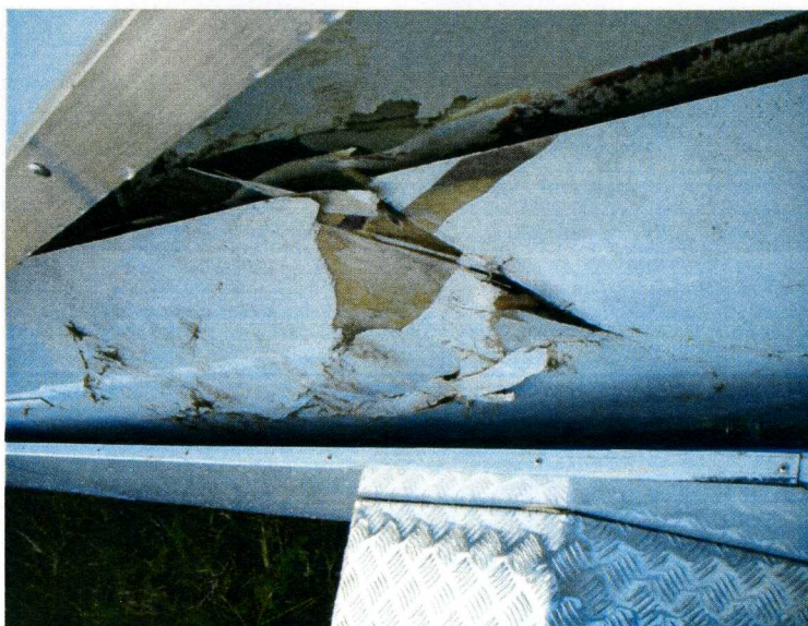
Fot. 22 – SP-3636: • uszkodzone skrzydło.
