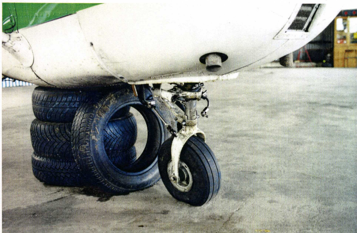
2 – Widok uszkodzonego przedniego podwozia samolotu.
