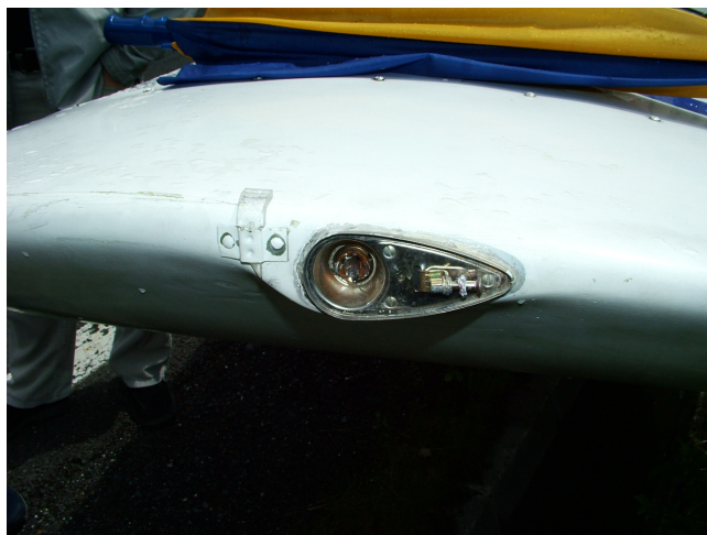
Fot.4 – Końcówka lewego skrzydła z oberwaną lampką pozycyjną.
