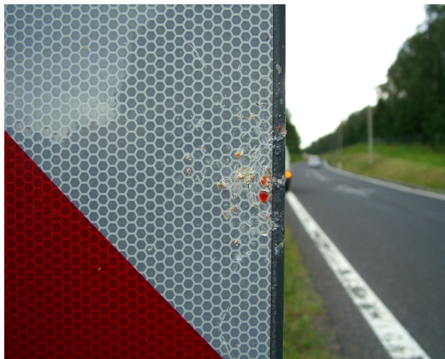
Fot.5 – Tablica na początku zjazdu ze śladem uderzenia końcówką lewego skrzydła.
