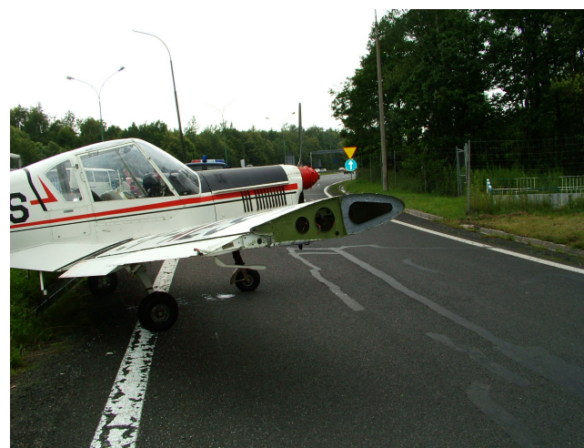
Fot.8 – Widok na prawe skrzydło samolotu z oderwaną końcówką.
