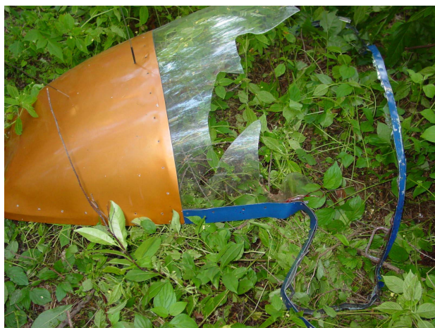
Fot.17 – Zniszczona osłona kabiny.
