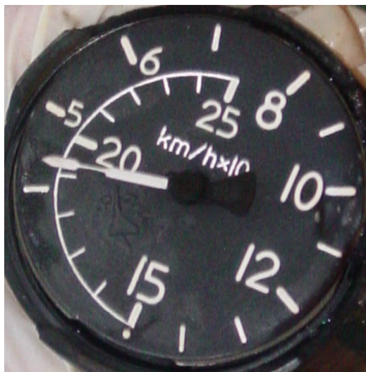
Fot.15 – Prędkościomierz wyrwany z tablicy przyrządów
