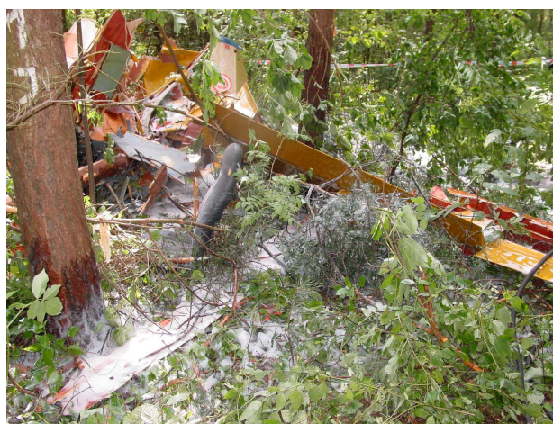
Fot.4 – Szczątki lewego skrzydła
