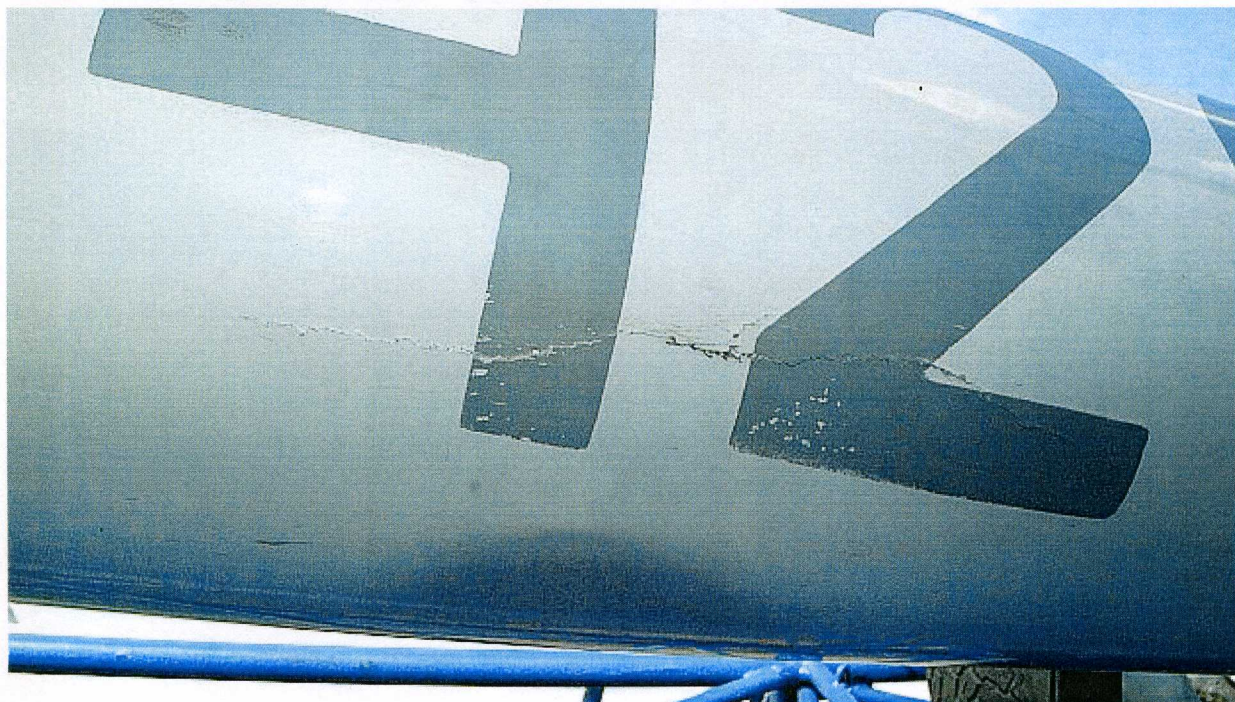
Fot. 1 – Rura kadłuba, lewa strona, w odległości ok. 1 m od przejścia rura kadłuba-statecznik pionowy widoczne pęknięcie długości ok. 25 cm.
