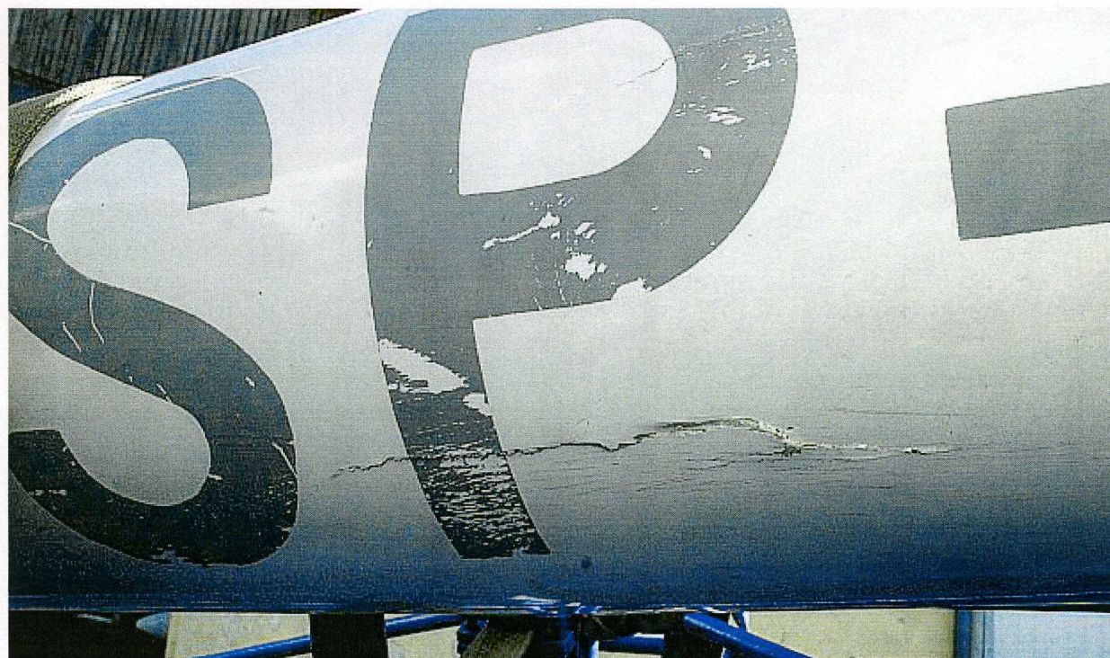
Fot. 2 – Rura kadłuba, prawa strona, w odległości ok. 1 m od przejścia rura kadłuba-statecznik pionowy widoczne pęknięcie długości ok. 25 cm.
