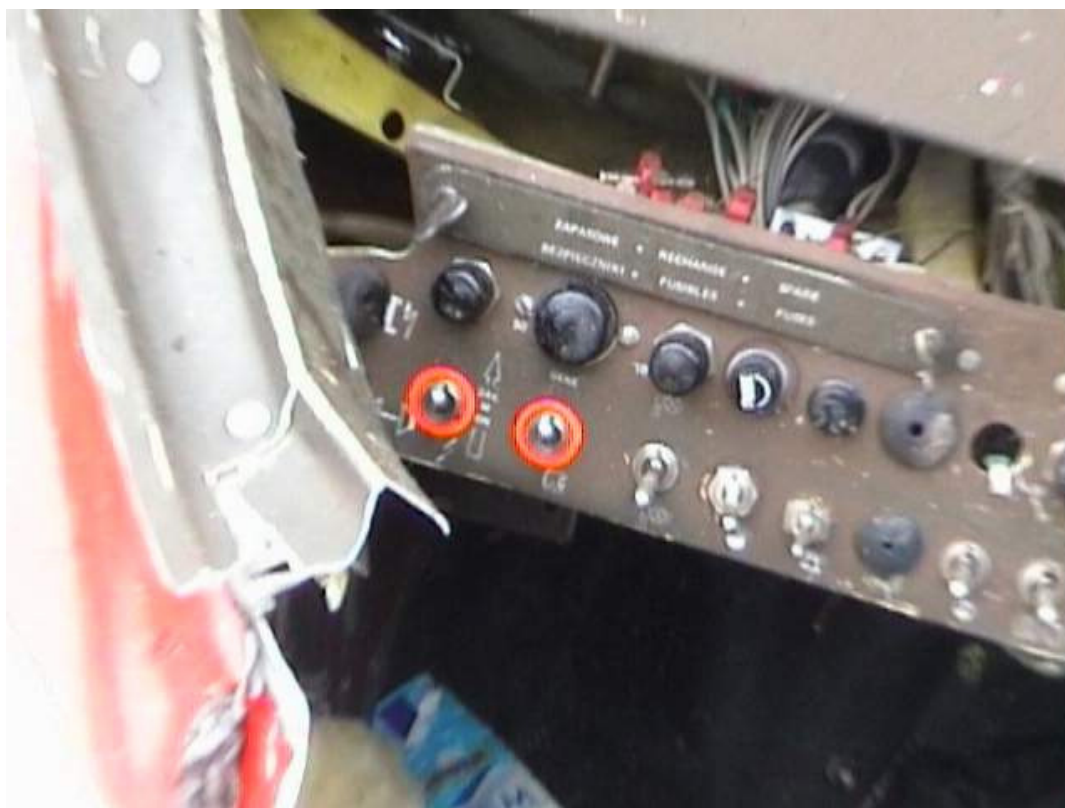
Fot.34 – Pulpit poziomy po stronie pilota – widoczne położenia przełączników.
