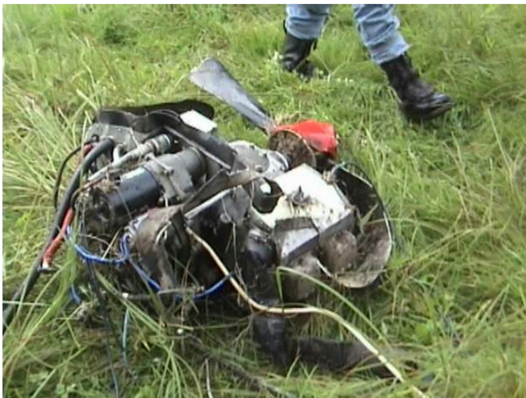
Fot.27 – Silnik wraz ze śmigłem wyrwany z łoża – widoczne agregaty i zniszczone śmigło.
