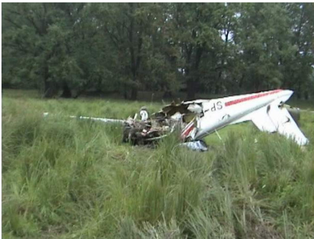
Fot.19 – Kadłub samolotu, leżący na plecach.
