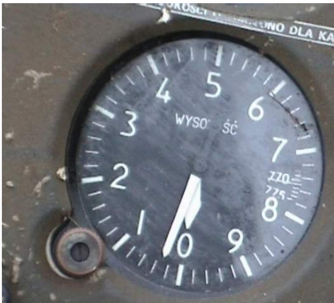
Fot.35 – Wysokościomierz z zachowanym wskazaniem wysokości (poniżej 40 m) i ciśnienia lotniska (771 mm Hg = 1028 hPa).
