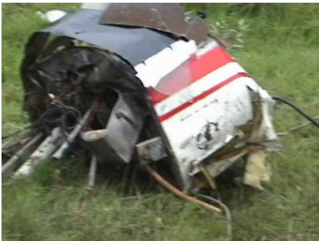
Fot.38 – Odcięta przednia część kadłuba z widoczną przegrodą ogniową, resztkami łoża silnika, skrzynką akumulatora i gniazdkiem zasilania lotniskowego.
