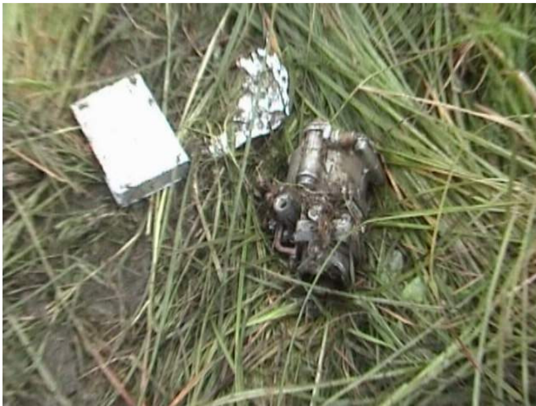
Fot.18 – Wyrwane agregaty – gaźnik i blok radiostacji.
