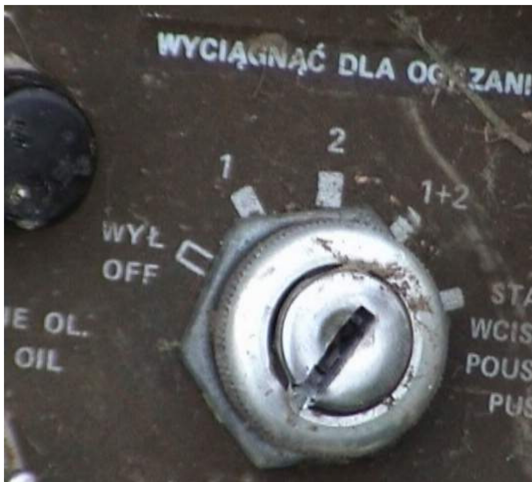
Fot.33 – Stacyjka – przełącznik iskrowników (kluczyk ułamany w położeniu „1+2”)
