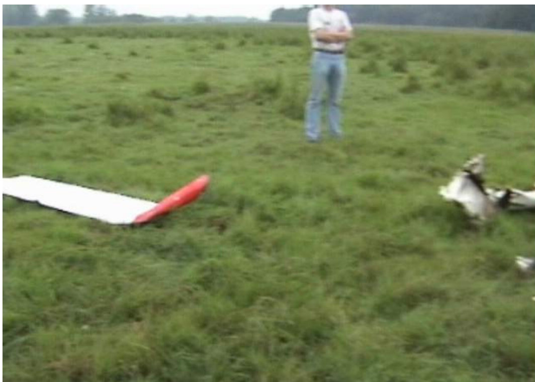
Fot.4 – Oderwana prawa część steru wysokości.
