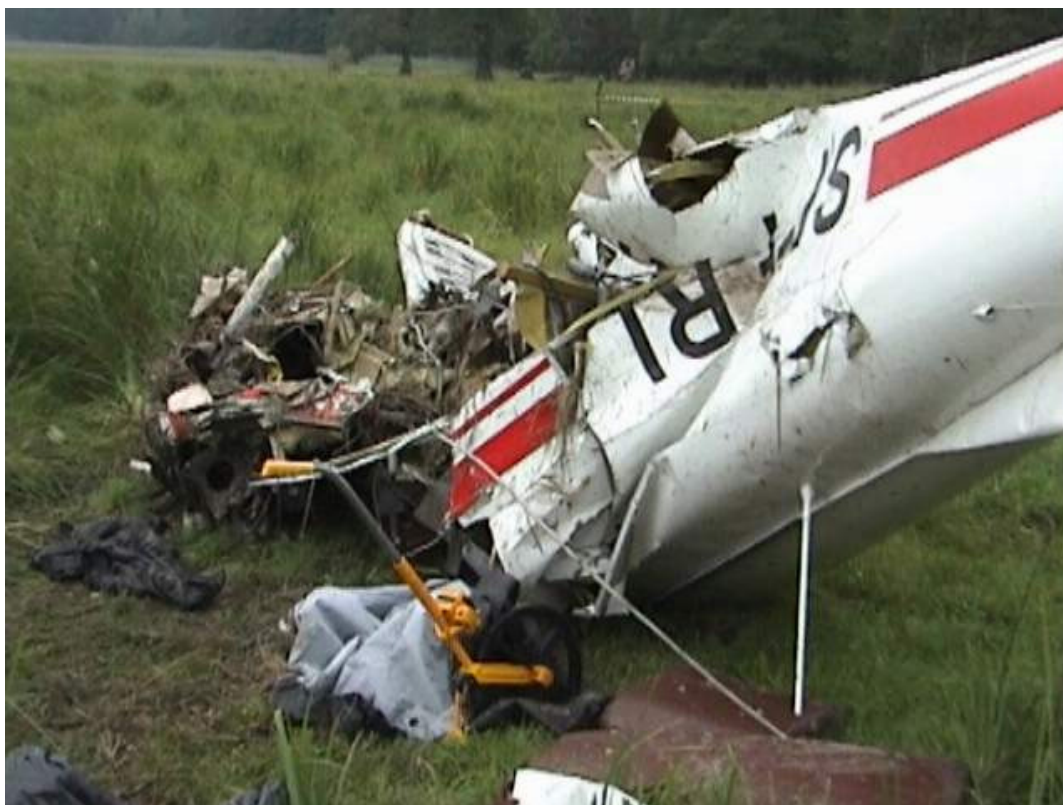
Fot.21 – Całkowicie zniszczona kabinowa część kadłuba.
