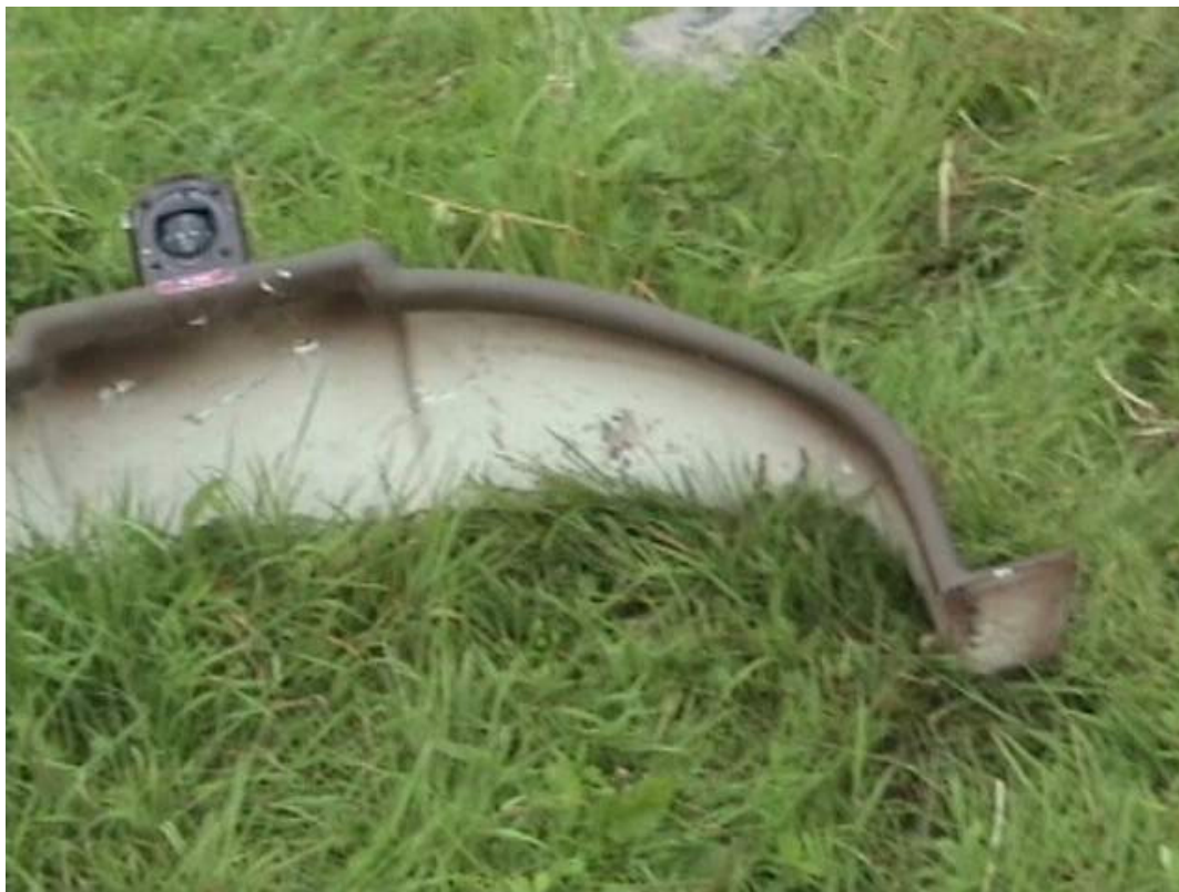
Fot.14 – Osłona-ocieniacz tablicy przyrządów z busolą KI-13.
