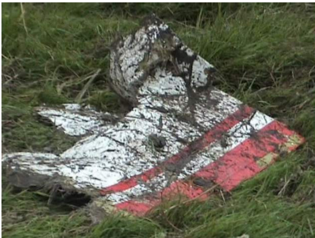
Fot.11 – Szczątki dolnej osłony silnika.
