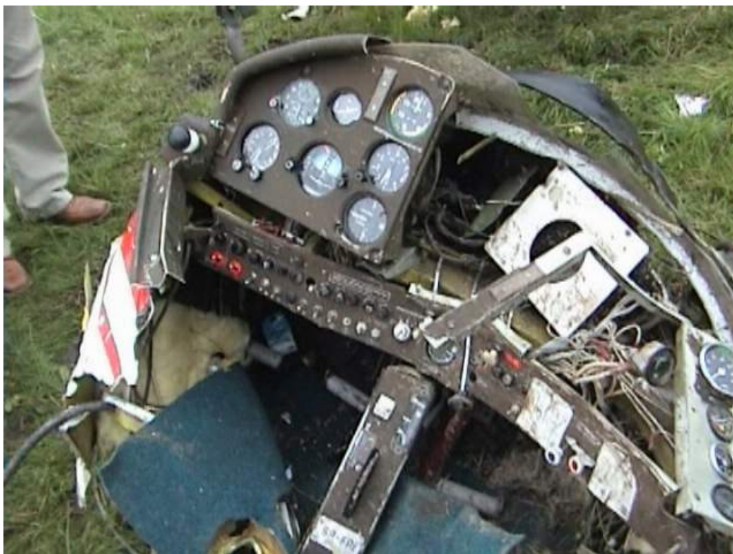
Fot.29 – Widok na zniszczone tablice przyrządów i pulpity – strona lewa i środek.
