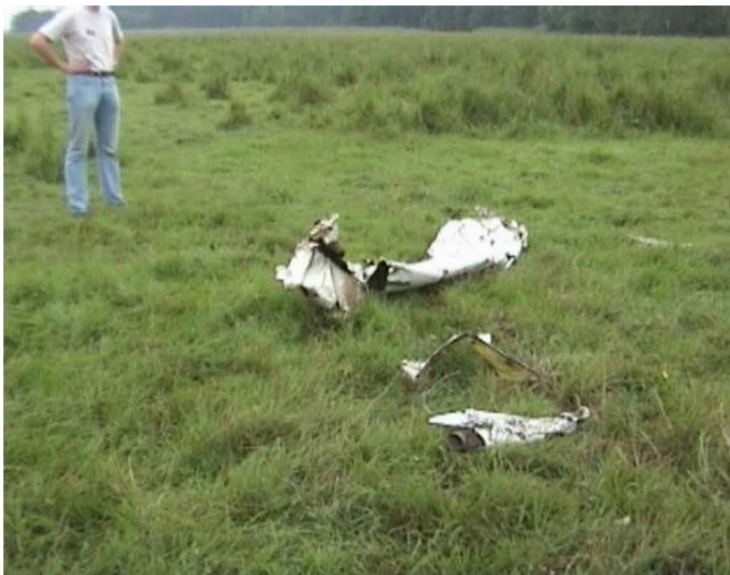
Fot.5 – Zniszczona kłapa prawego skrzydła.
