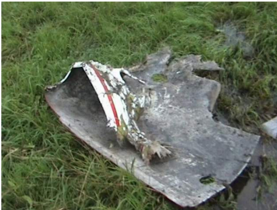
Fot.12 – Dolna część dolnej osłony silnika.
