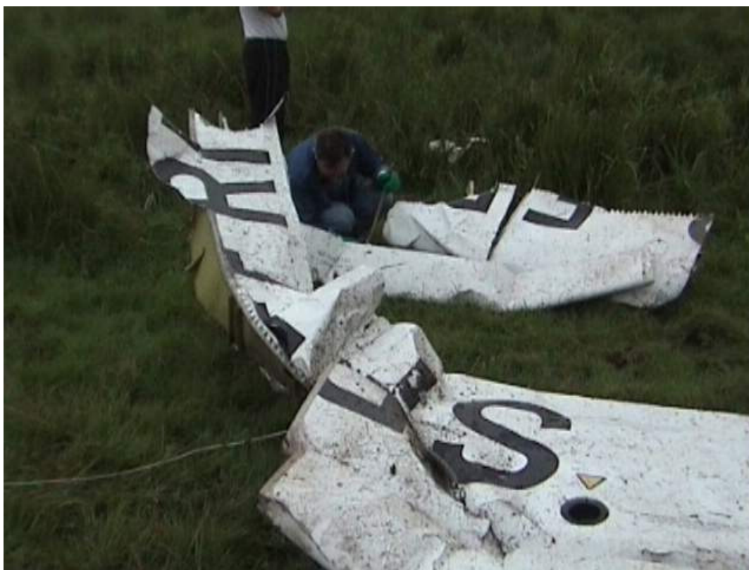
Fot.6 – Zniszczone prawe skrzydło.
