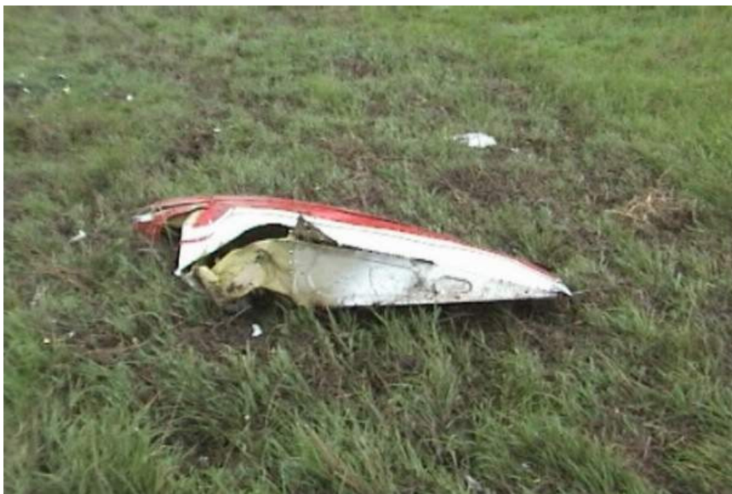
Fot.3 – Oderwana końcówka prawego skrzydła.
