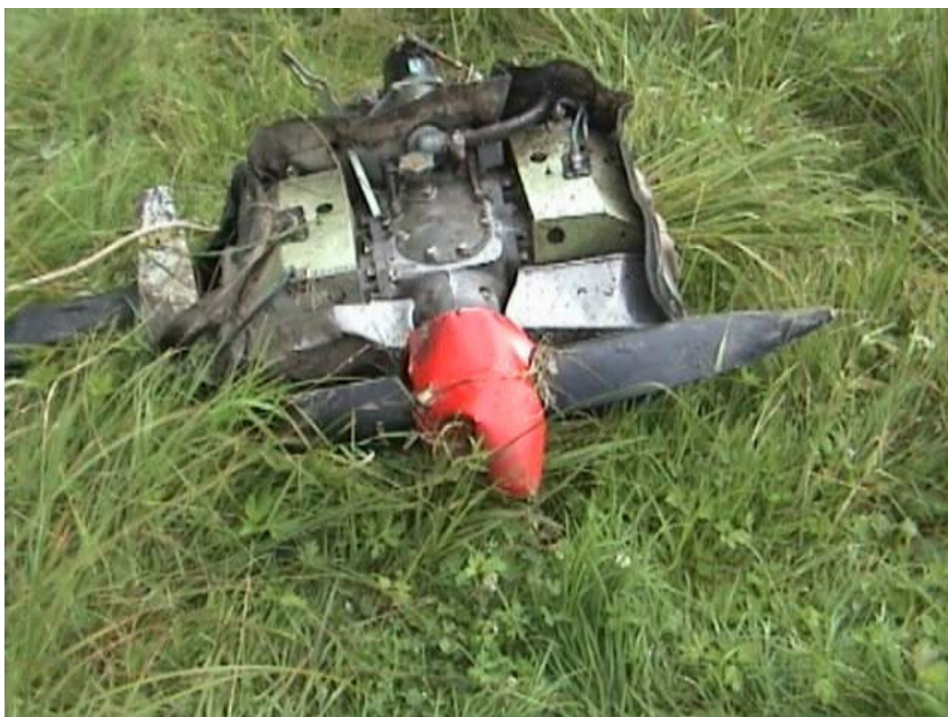
Fot.26 – Silnik wraz ze śmigłem wyrwany z łoża – jedna łopata śmigła urwana, druga zagięta.
