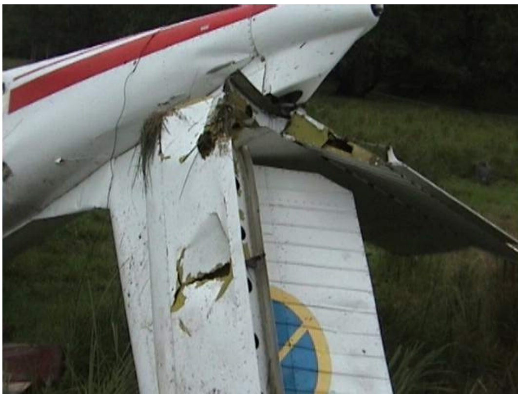
Fot.20 – Zniszczone usterzenie samolotu.
