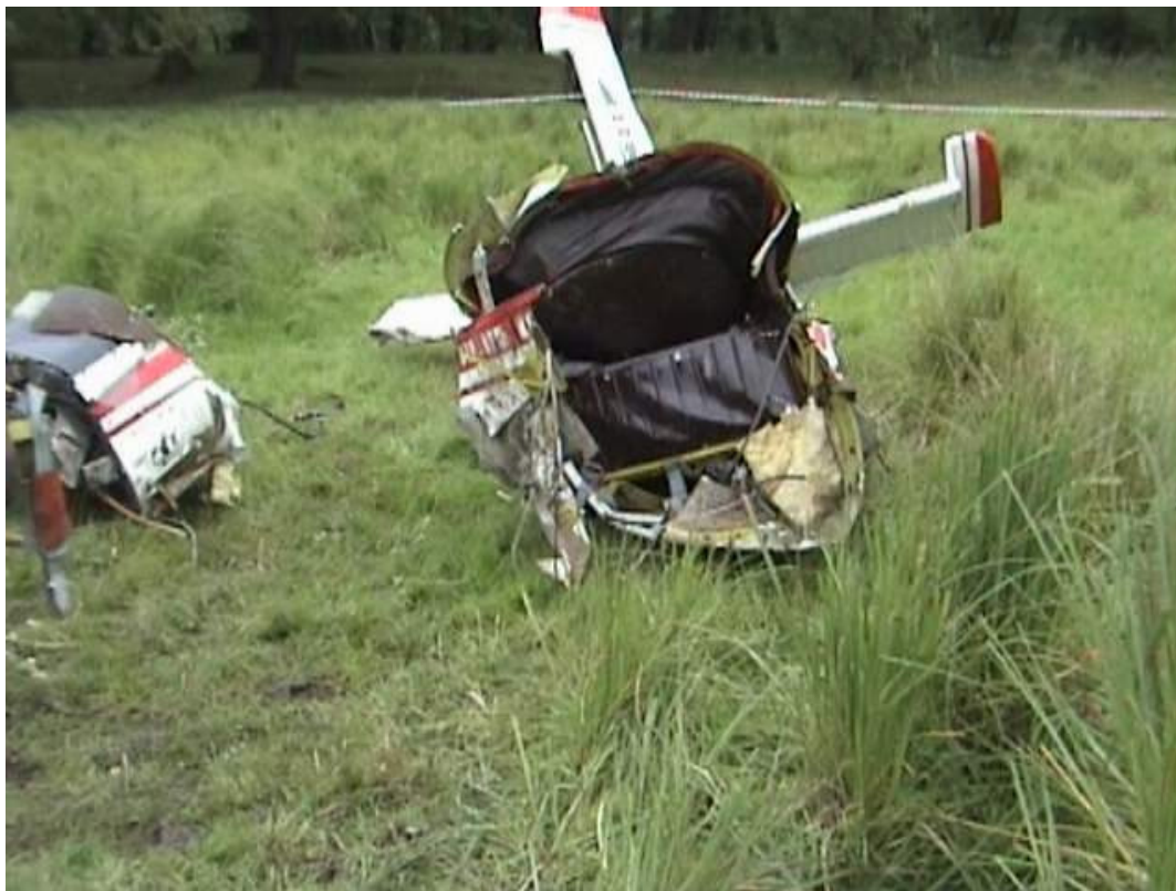
Fot.37 – Tylna część kadłuba po odcięciu szczątków kabiny.
