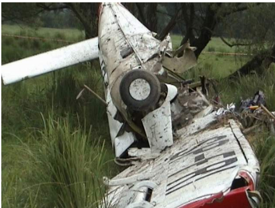
Fot.22 – Lewe skrzydło samolotu, które podczas ślizgania się samolotu na grzbiecie po kapotażu spowodowało „ukręcenie” kabiny.
