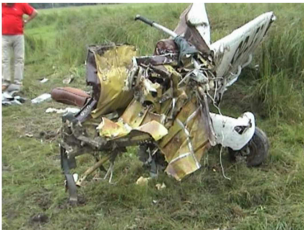
Fot.36 – Zniszczone lewe skrzydło po odcięciu od szczątków kadłuba.
