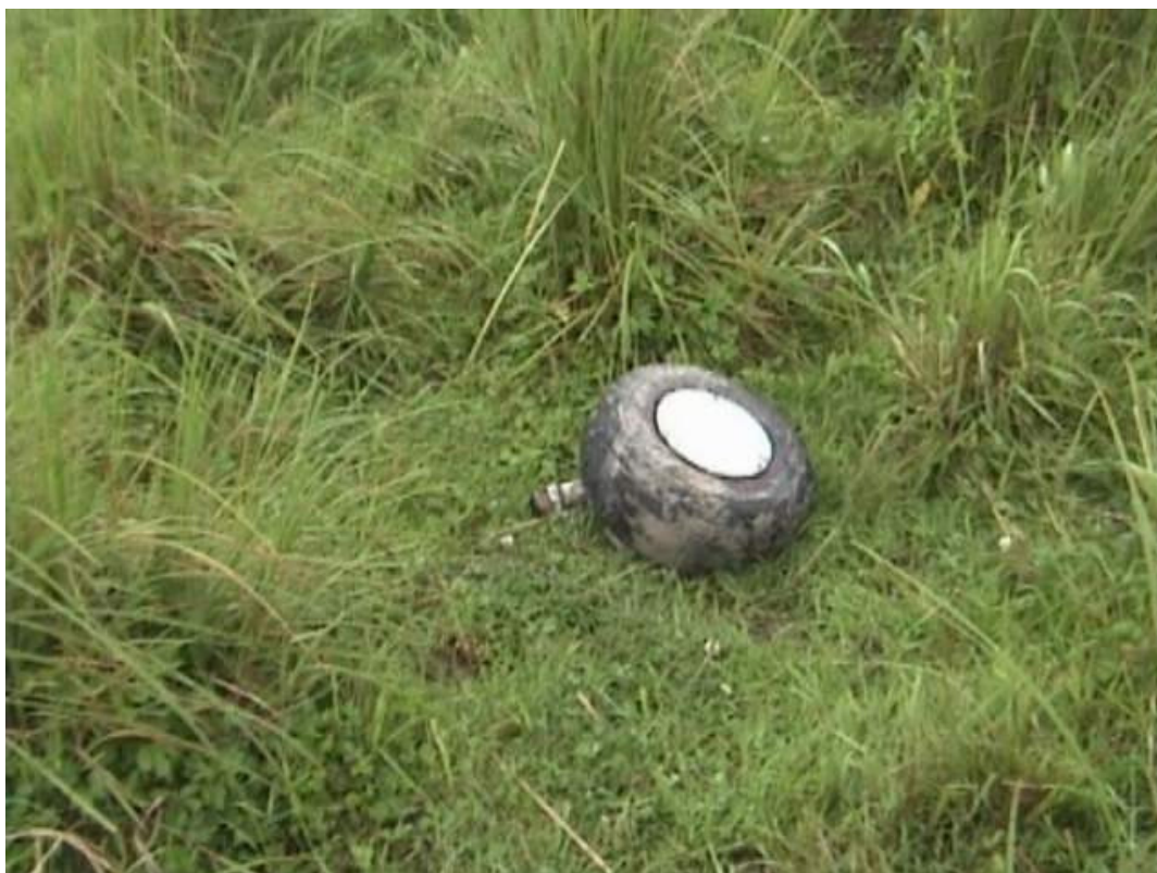
Fot.8 – Koło prawego podwozia głównego, oderwane wraz z wahaczem i amortyzatorem.
