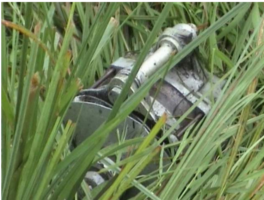
Fot.17 – Oderwany od silnika alternator.
