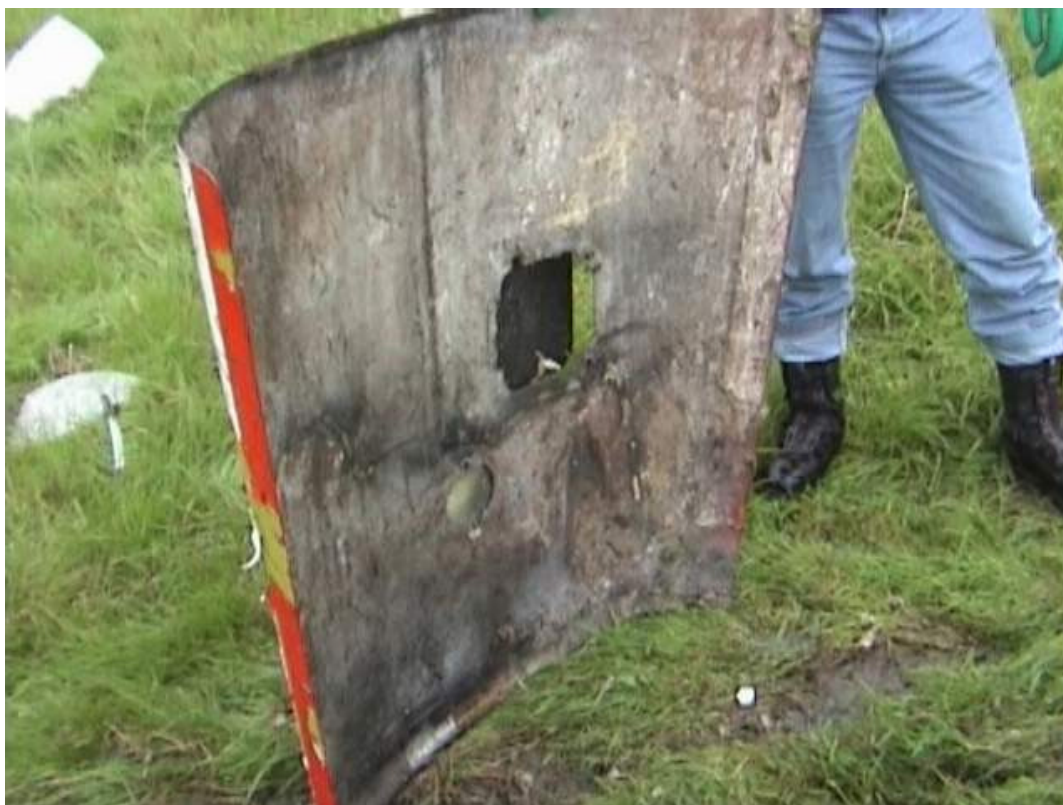
Fot.13 – Górna pokrywa silnika od spodu – bez widocznych śladów oleju i innych podcieków.
