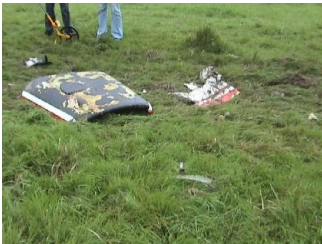
Fot.10 – Górna pokrywa silnika i resztki pokrywy dolnej.
