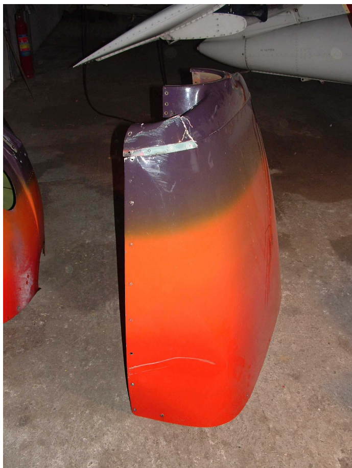
Fot.13 – Uszkodzona górna osłona silnika.
