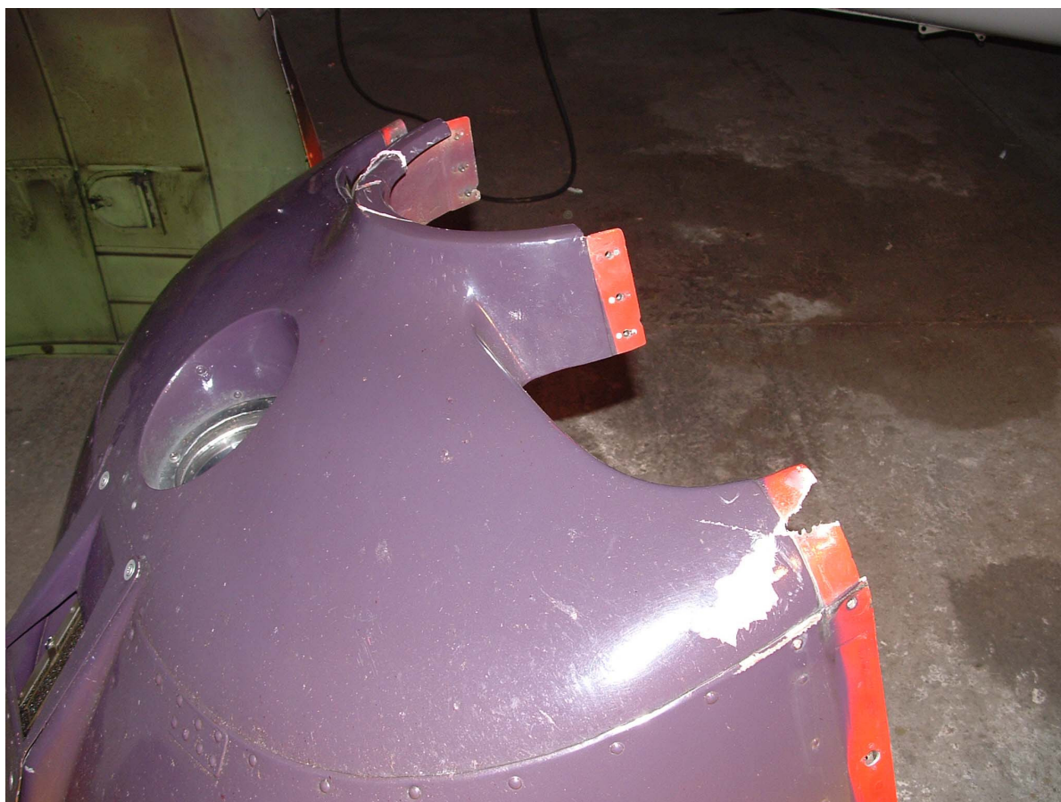
Fot.14 – Uszkodzona dolna osłona silnika.
