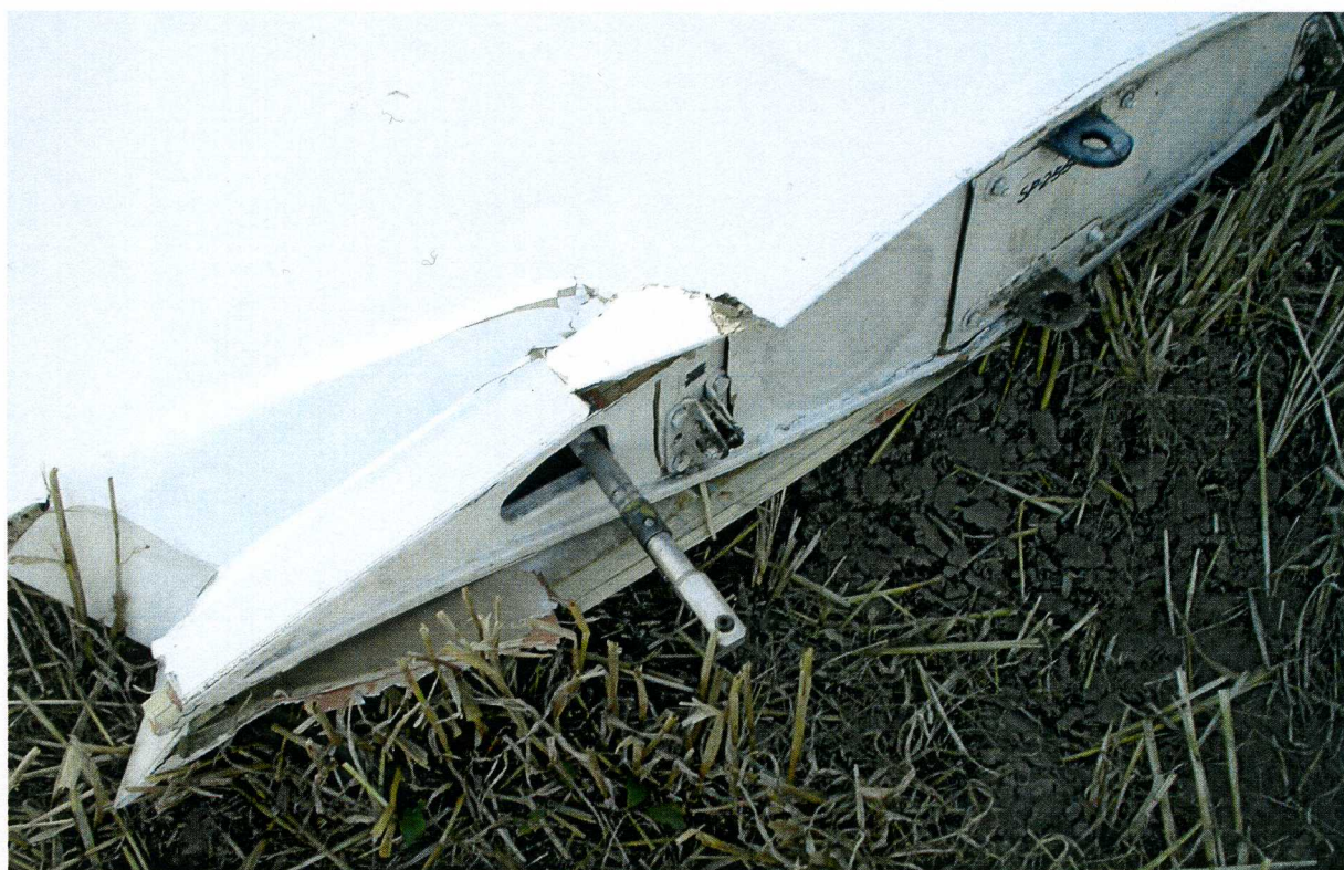
Fot.8 – Złamane żebro nasadowe zewnętrznej części lewego skrzydła (po jej demontażu).
