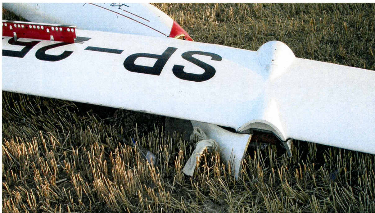
Fot.11 – Środkowa część skrzydła, oderwana od kadłuba.
