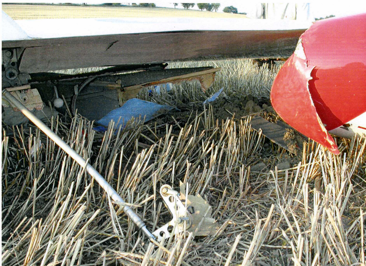
Fot.13 – Środkowa część skrzydła oderwana od kadłuba, widoczne wyrwane elementy układu sterowania w skrzydle. Po prawej stronie zdjęcia nosek kadłuba, zgnieciony wskutek uderzenia o ziemię.
