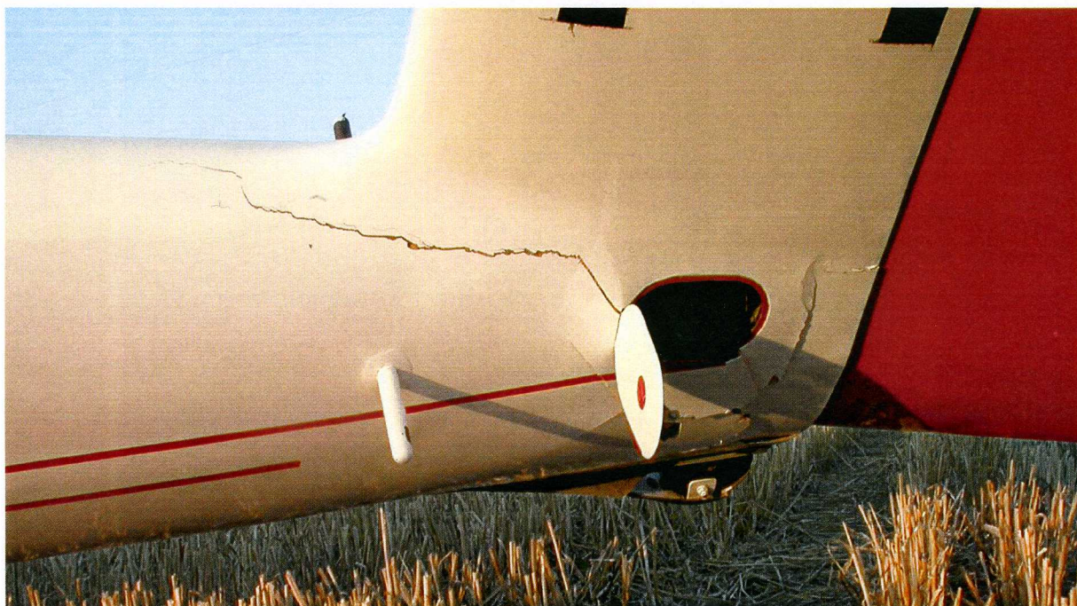
Fot.18 – Tylna część kadłuba – widoczne uszkodzenia u nasady zamocowania usterzenia pionowego.
