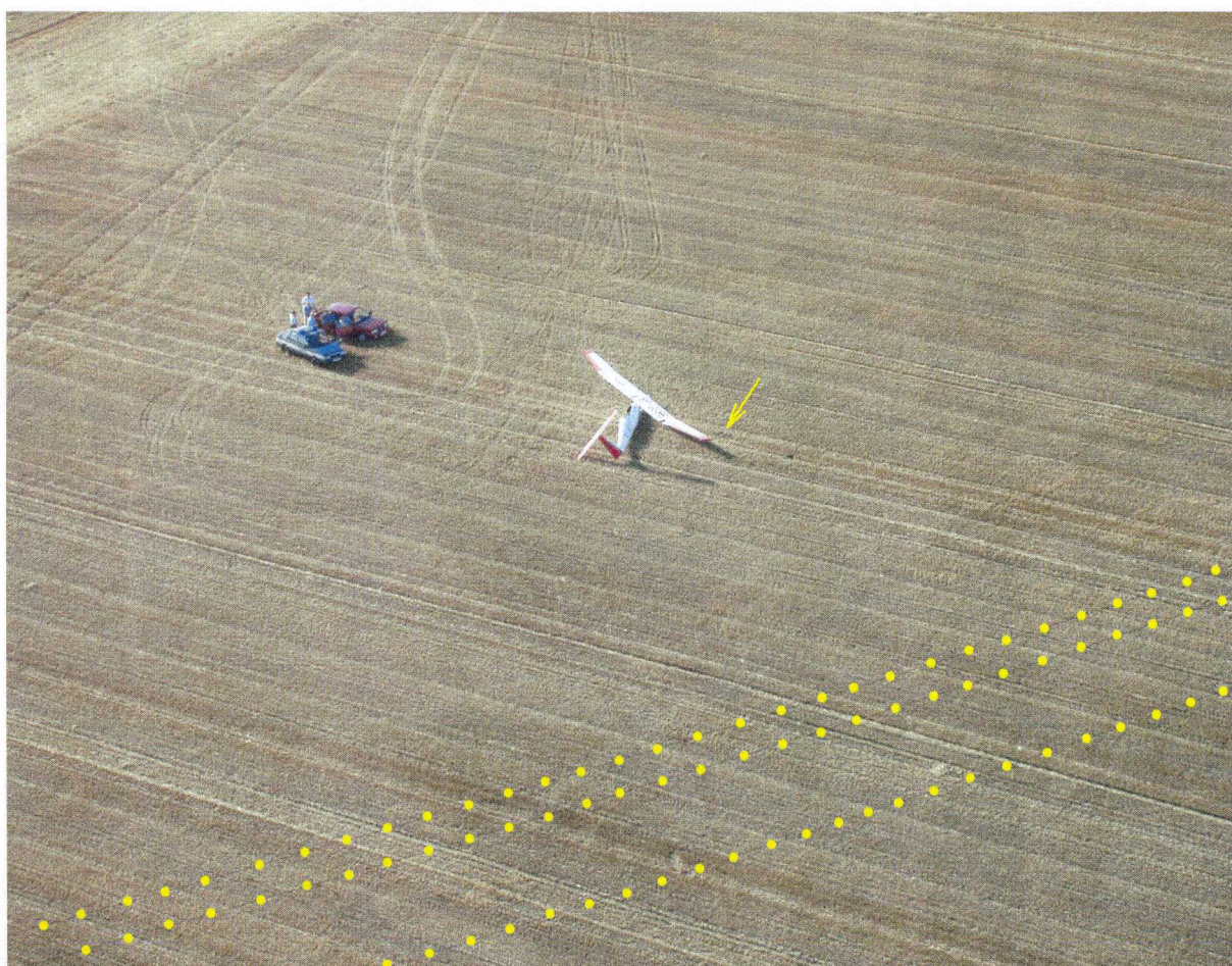
Fot.2 – Ogólny widok miejsca wypadku z lotu ptaka. Przewody linii średniego napięcia zaznaczono żółtymi kropkami. Żółta strzałka wskazuje ślad uderzenia noskiem prawego skrzydła w ziemię.
