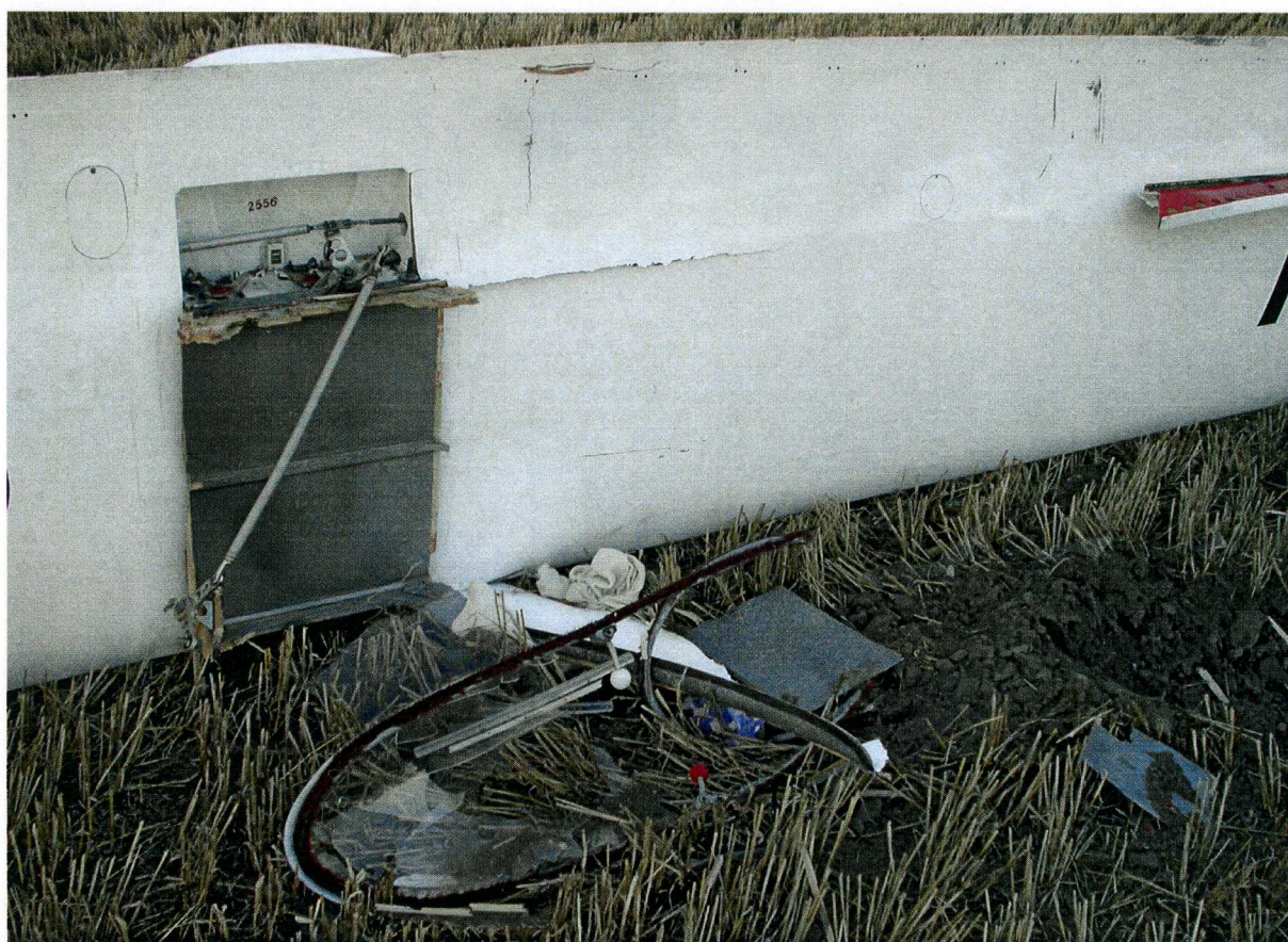
Fot.12 – Środkowa część skrzydła od spodu (po jej uniesieniu). Widoczna ścięta i zgnieciona osłona kabiny oraz wyrwane elementy układu sterowania w skrzydle i uszkodzenia dolnego pokrycia środkowej części skrzydła.
