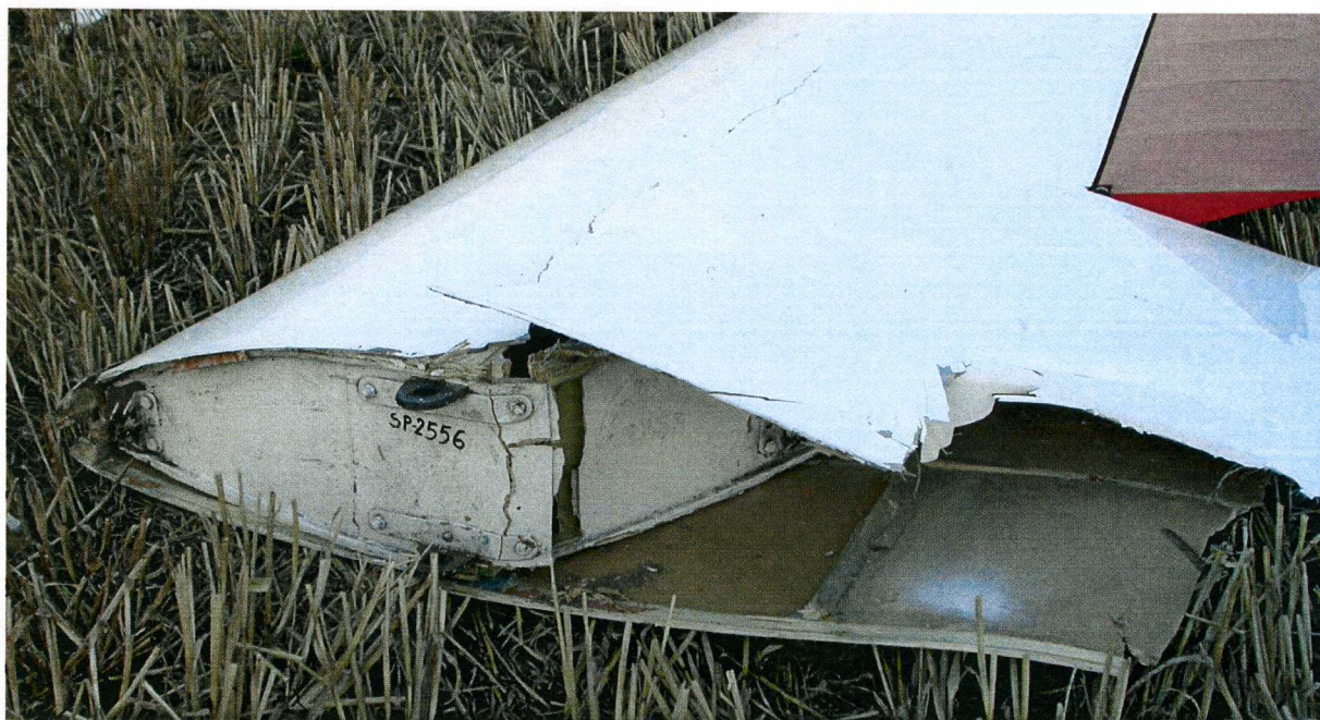
Fot.10 - Złamane żebro nasadowe zewnętrznej części prawego skrzydła (po jej demontażu).
