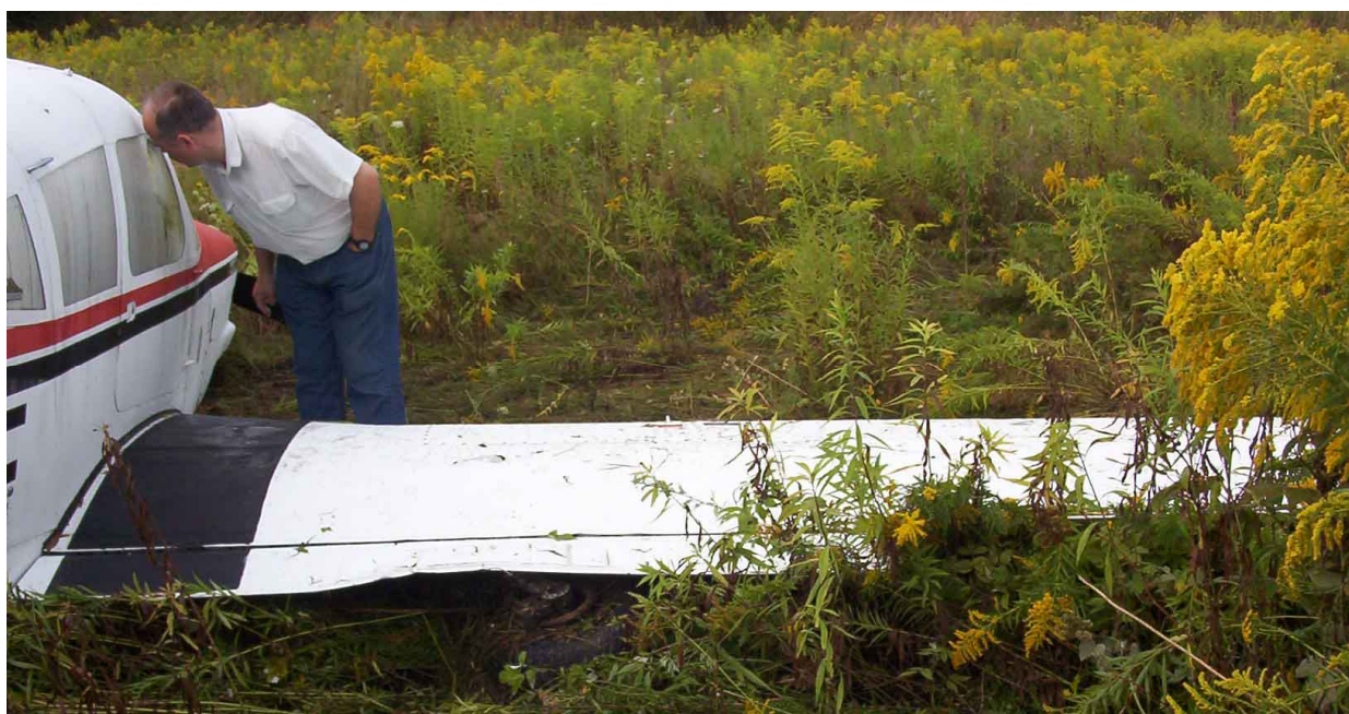
7 – Prawe skrzydło – widoczne uszkodzenia kłapy i wyłamane prawe podwozie główne (pod skrzydłem).
