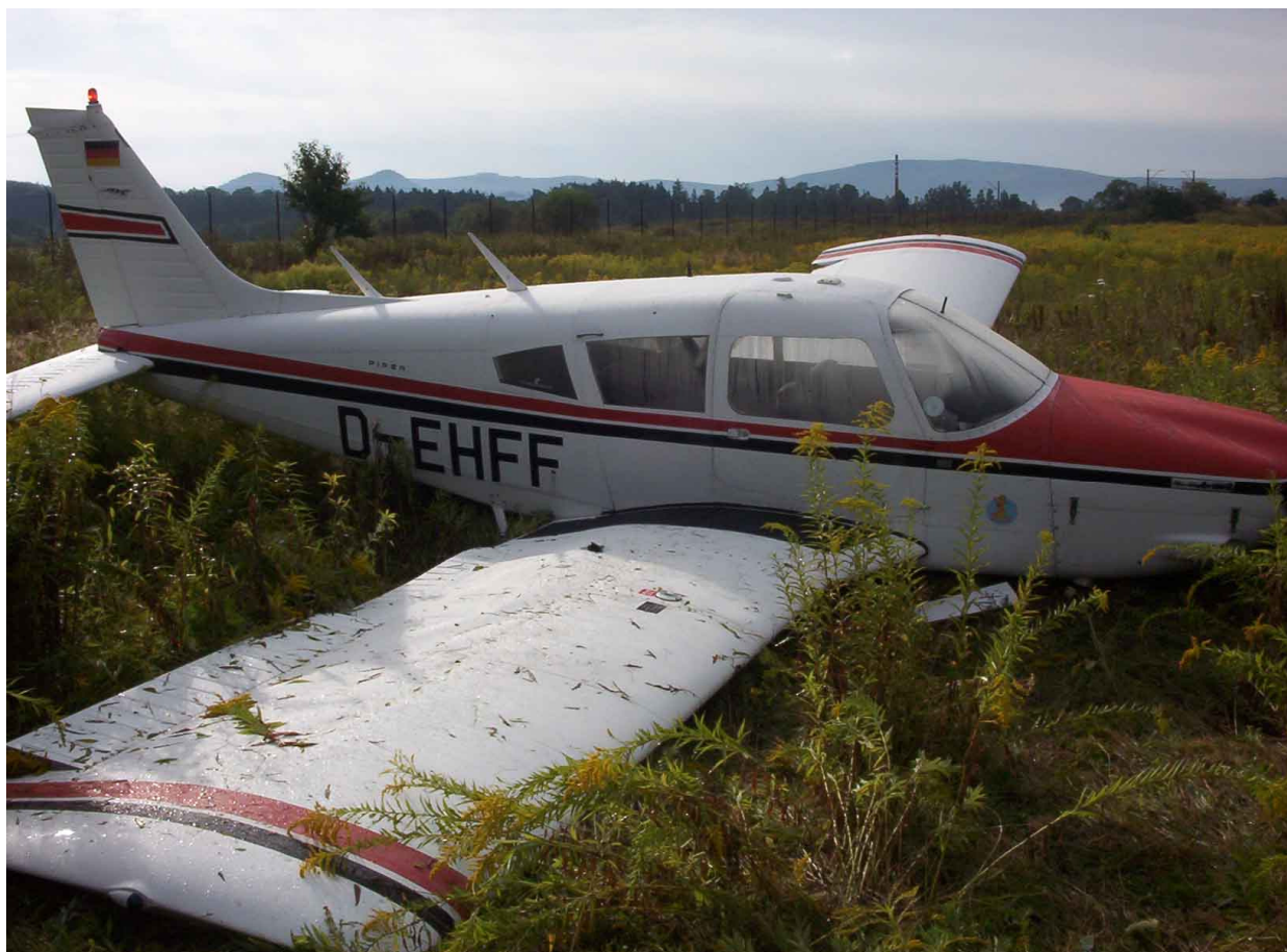
4 – Samolot z prawej strony – widoczne oddzielone osłony podwozia przedniego i uszkodzenia dolnej osłony silnika oraz kłapy.
