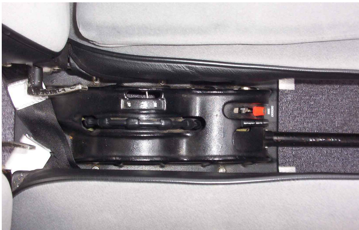
9 – Pulpit między fotelami – widoczna dźwignia klap w położeniu ZAMKNIĘTE.
