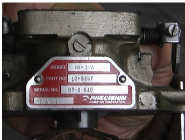
23 – Korpus zdemontowanego gaźnika – widoczna tabliczka znamionowa.
