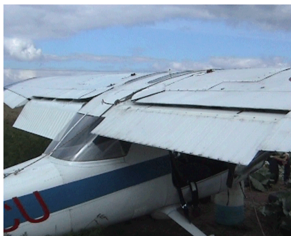
14 – Widok na górną powierzchnie skrzydeł po postawieniu samolotu na kołach; widoczne uszkodzenia pokryć.
