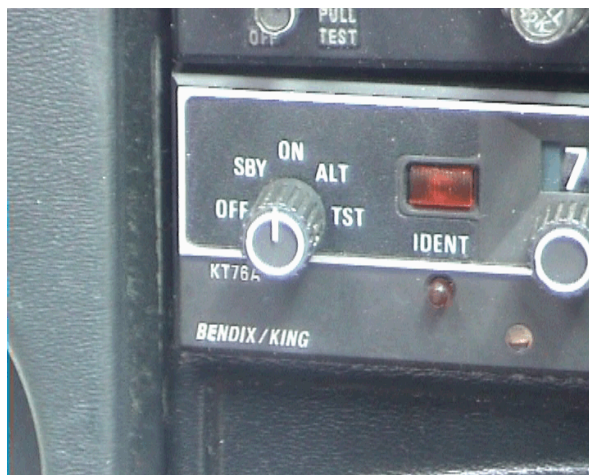
18 – Położenie przełącznika funkcji transpondera.
