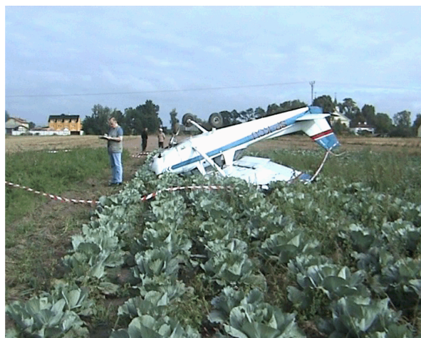
5 i 6 – Widoki skapotowanego samolotu na miejscu wypadku z lewej i prawej strony.
