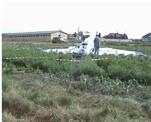
7 i 8 – Widoki skapotowanego samolotu na miejscu wypadku z tyłu i z przodu. Dobrze widoczne kłapy wypuszczone na kąt „do startu”.
