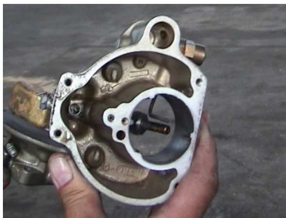
24 – Komora pływakowa gaźnika – widoczny brak śladów zanieczyszczeń.
