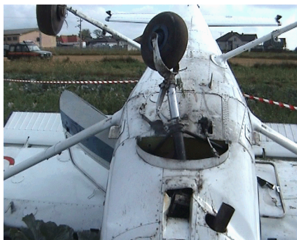
10 – Zbliżenie uszkodzonego samolotu – widoczne wyłamane podwozie przednie i uszkodzenia dolnej osłony silnika.
