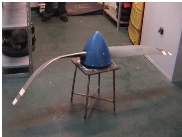
21 – Uszkodzone śmigło z kołpakiem po demontażu – widok ogólny.
