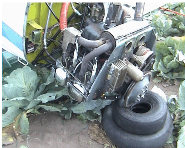
11 – Zespół napędowy samolotu na miejscu wypadku po demontażu śmigła.
