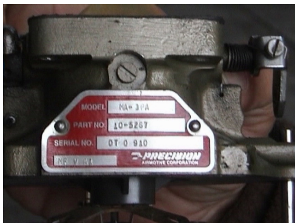
23 – Korpus zdemontowanego gaźnika – widoczna tabliczka znamionowa.
