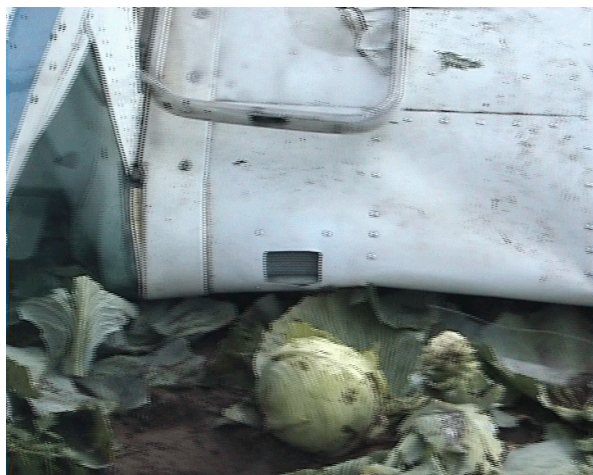
15 – Uszkodzenia noska prawego skrzydła u nasady.
