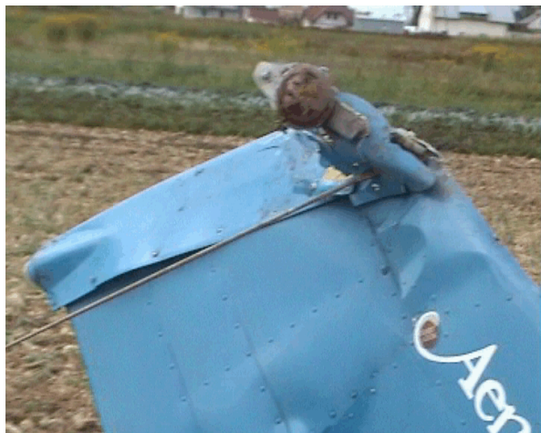
13 – Końcówka usterzenia pionowego z widocznymi uszkodzeniami (widok po odwróceniu samolotu i postawieniu na kołach).
