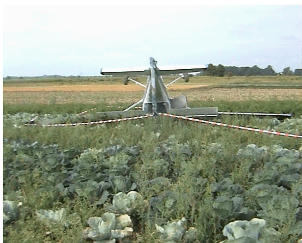
7 i 8 – Widoki skapotowanego samolotu na miejscu wypadku z tyłu i z przodu. Dobrze widoczne klapy wypuszczone na kąt „do startu”.
