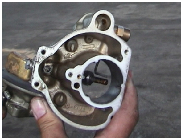
24 – Komora pływakowa gaźnika – widoczny brak śladów zanieczyszczeń.
