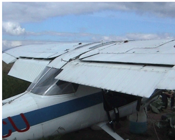
14 – Widok na górną powierzchnię skrzydeł po postawieniu samolotu na kołach; widoczne uszkodzenia pokryć.
