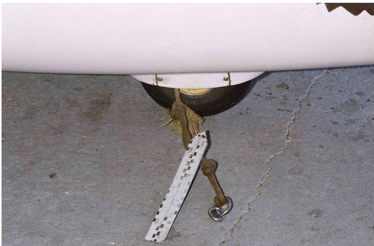
Fot.3 – Zbliżenie podwozia szybowca SZD-50-3 Puchacz, który był holowany przez samolot SP-CRZ tuż przed wypadkiem – widoczny urwany fragment linki holowniczej, zaczepony na przednim podwoziu.
