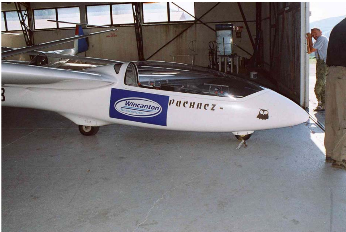
Fot.2 – Szybowiec SZD-50-3 Puchacz, który był holowany przez samolot SP-CRZ tuż przed wypadkiem – widoczny urwany fragment linki holowniczej, zaczepony na przednim podwoziu.
