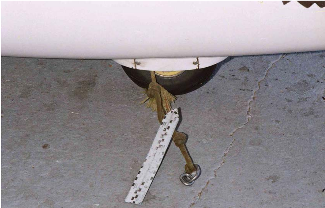
Fot. 1 Zbliżenie podwozia szybowca SZD-50-3 Puchacz, który był holowany przez samolot SP-CRZ tuż przed wypadkiem – widoczny urwany fragment linki holowniczej, zaczepiony na przednim podwoziu
