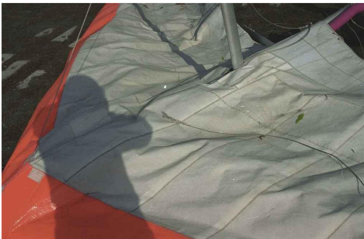
Fot.9 – Środkowa część skrzydła od góry – widoczny maszt, tylna część kilu i zerwana linka napinająca.
