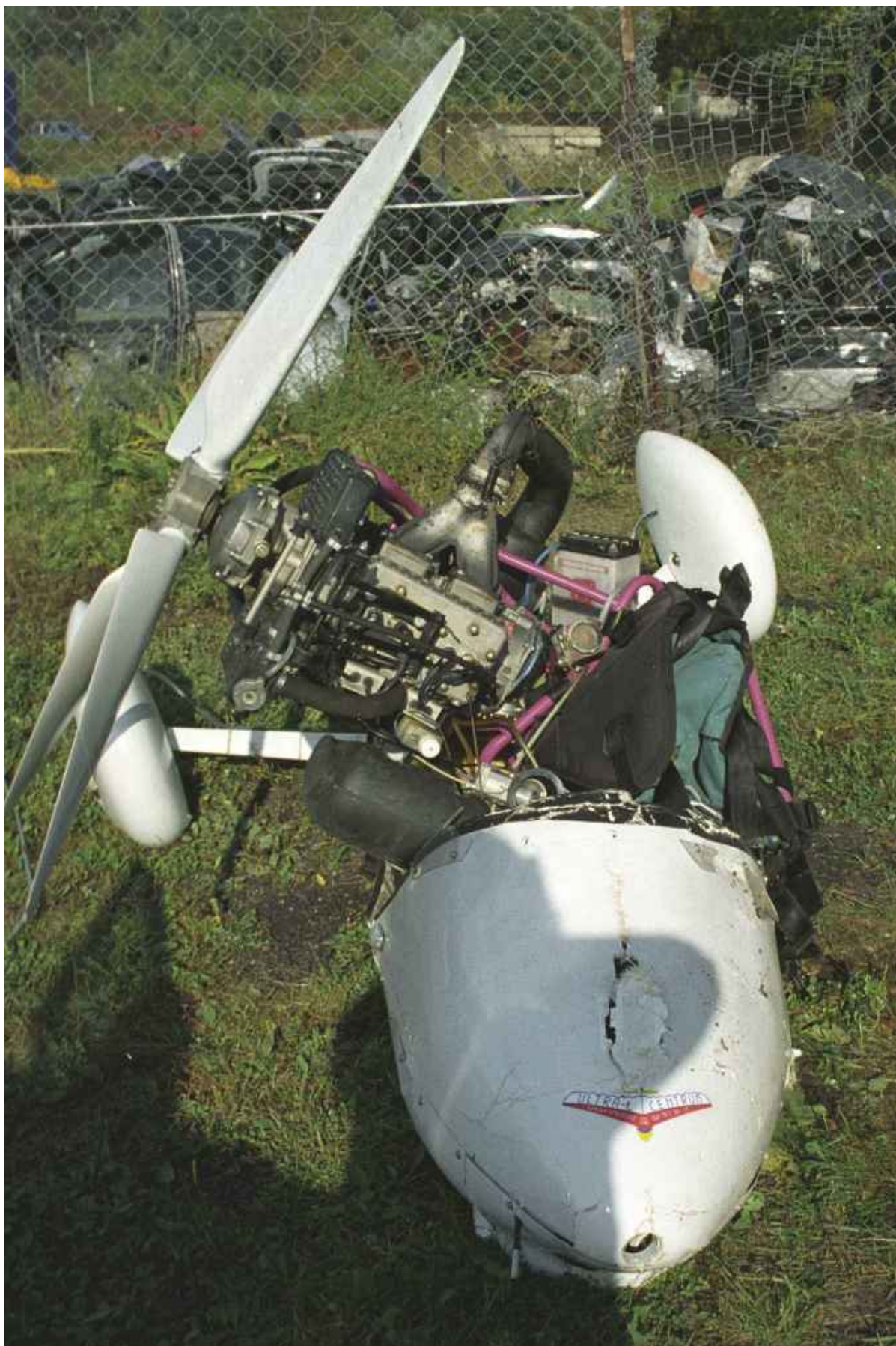
Fot.1 – Widok wózka motolotni po wypadku (z przodu).
