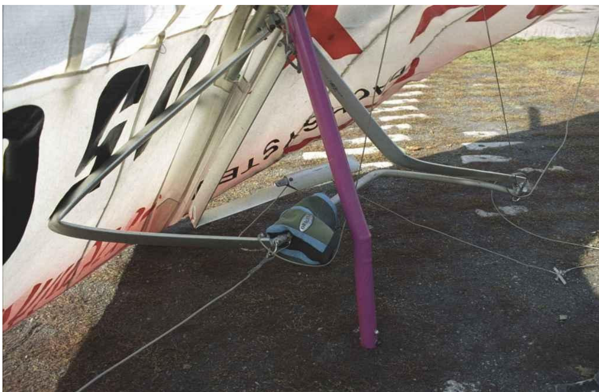
Fot.5 – Zniszczone skrzydło motolotni – widoczna górna część masztu (fioletowa) zmontowana wraz ze skrzydłem, zniszczony trójkąt sterowniczy i linki napinające.
