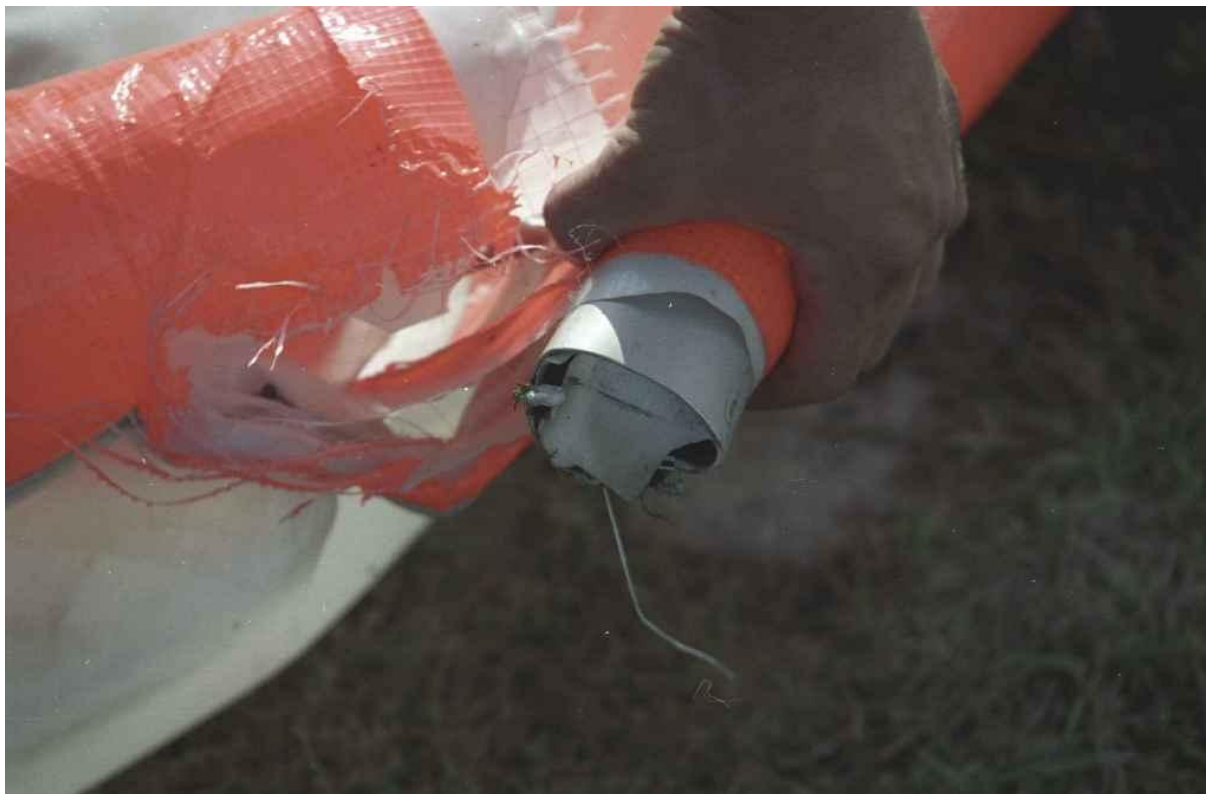
Fot.11 – Złamany prawy dźwigar skrzydła i rozdarte pokrycie.
