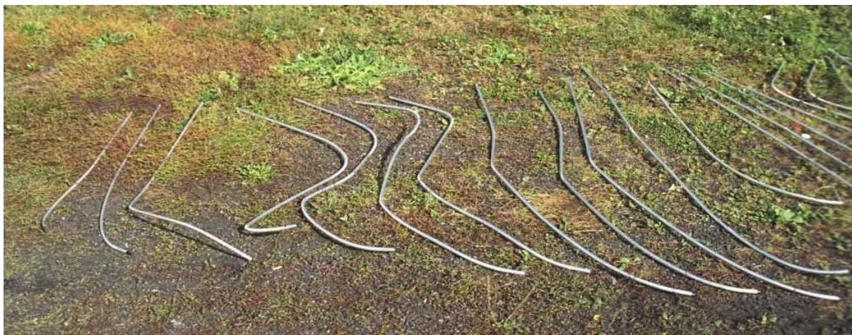
Fot.4 – Żebra skrzydła ułożone na ziemi wg ich pozycji w konstrukcji – prawa strona skrzydła.
