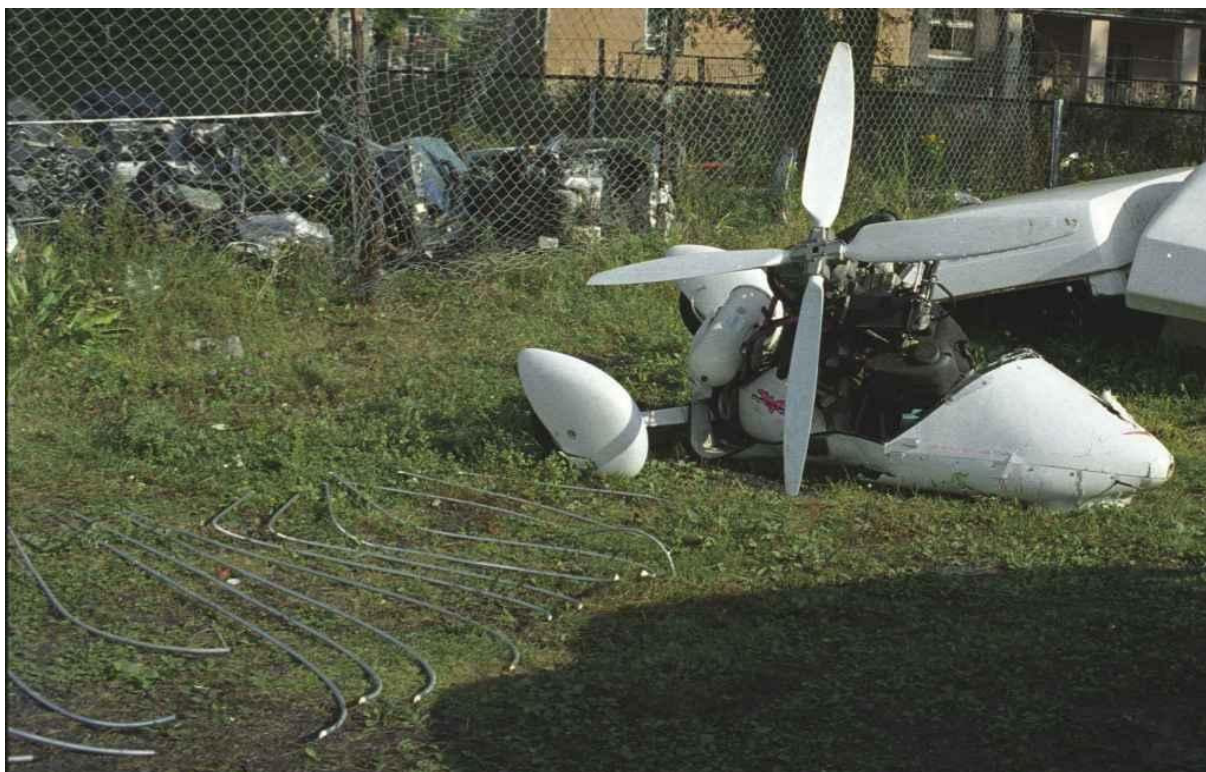
Fot.2 – Ogólny widok zniszczonego wózka motolotni. Obok ułożone na ziemi żebra skrzydła.
