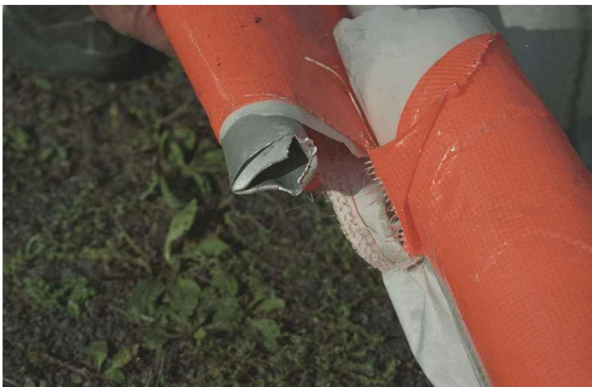
Fot.7 – Złamany prawy dźwigar i podarte pokrycie.
