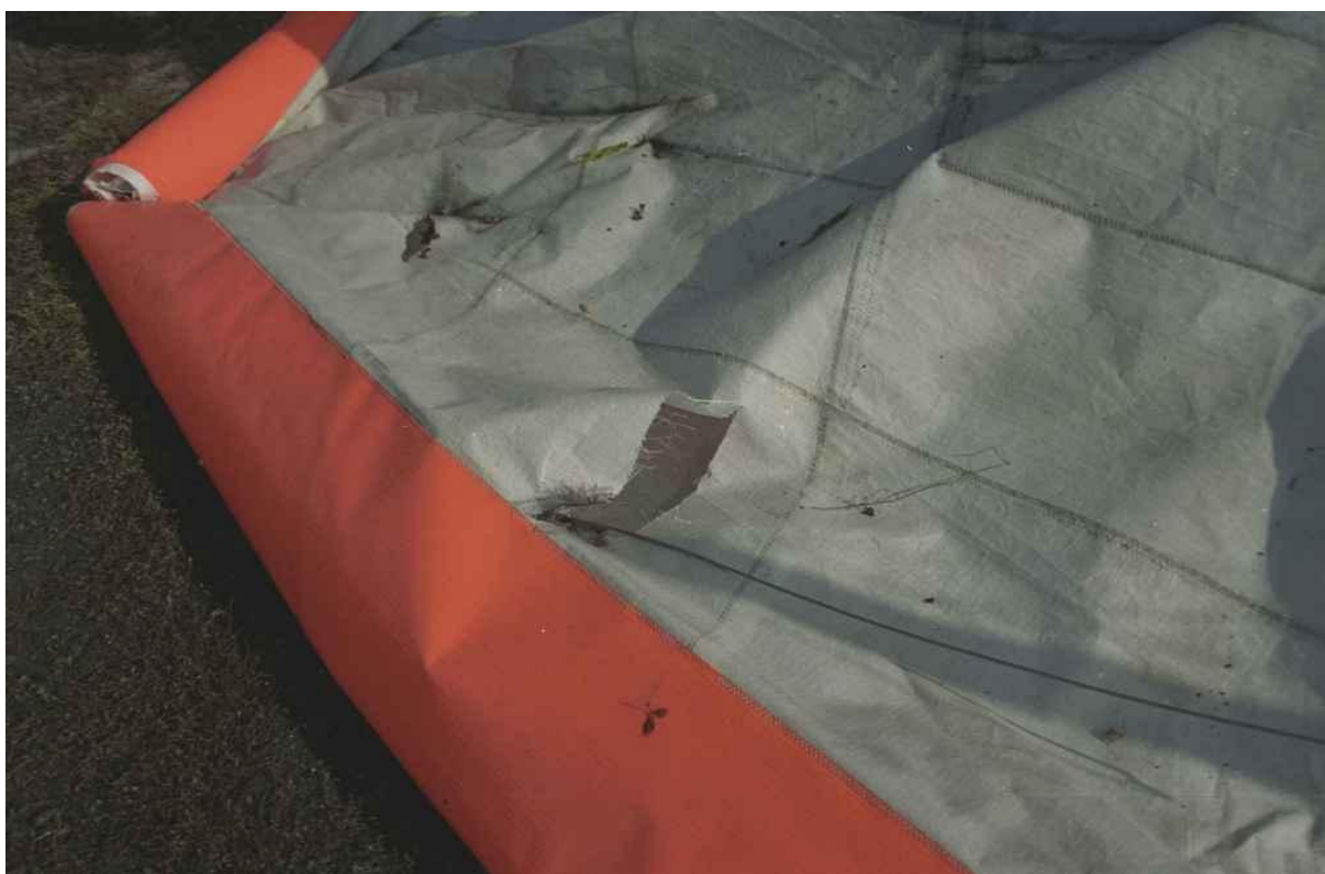
Fot.8 – Złamany prawy dźwigar i pokrycie rozdarte przez linkę napinającą.
