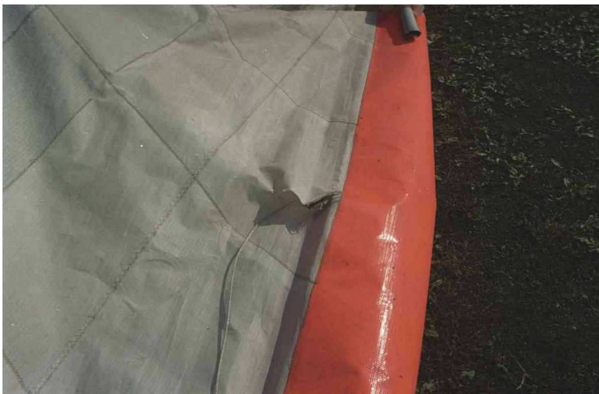
Fot.10 – Złamany prawy dźwigar skrzydła i rozdarcie pokrycia spowodowane przez linkę napinającą.
