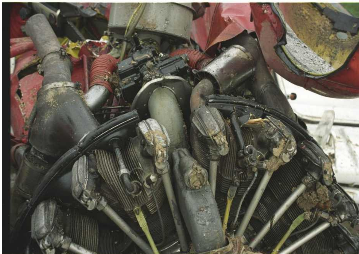
Fot.7 – Zbliżenie fragmentu silnika z gaźnikiem (po zdjęciu osłon na miejscu wypadku).
