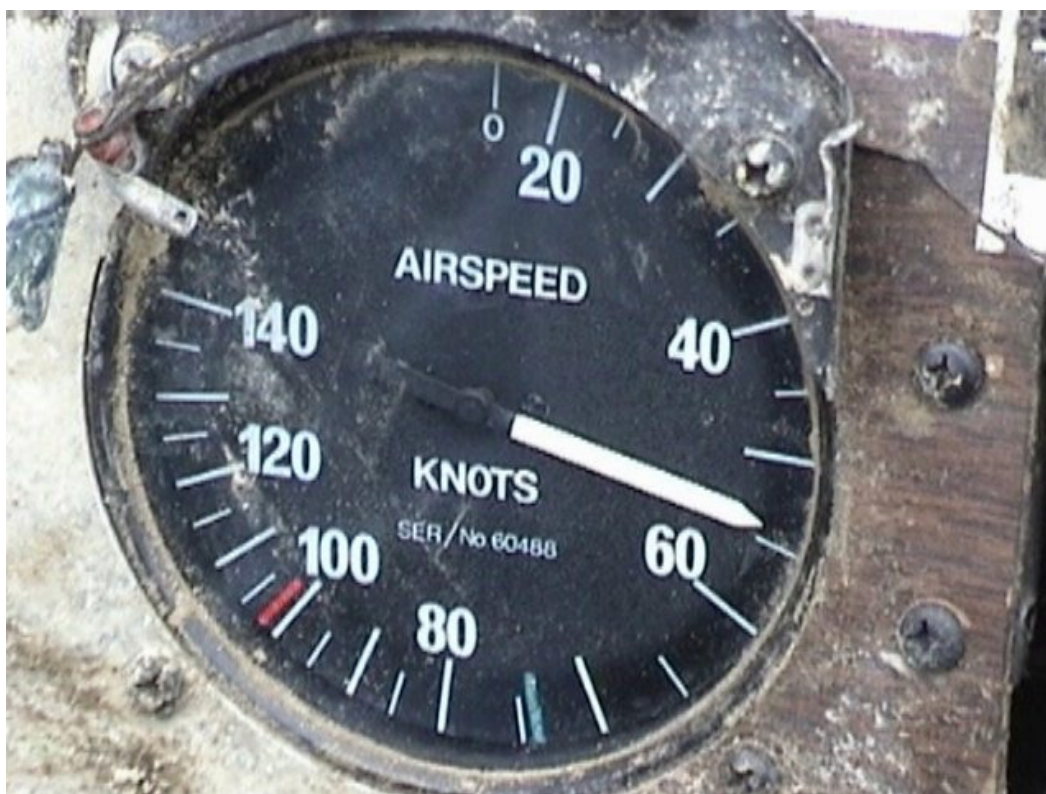
Fot.16 – Prędkościomierz z ostatnim wskazaniem.
