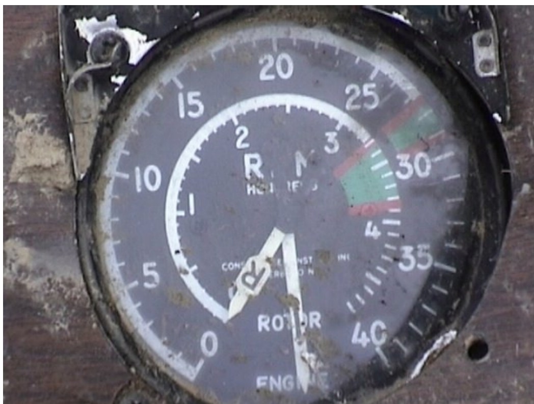
Fot.19 – Wskaźnik obrotomierza wirnika głównego.
