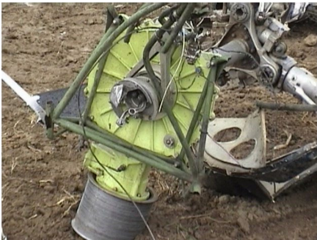
Fot.9 – Górna część przekładni głównej z kołem pasowym, wałem wirnika, tarczą sterującą i głowicą; widoczne zniszczone łożo mocowania przekładni.
