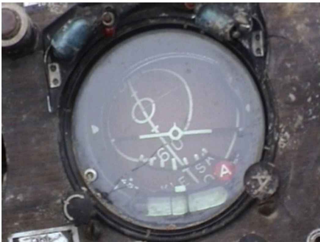
Fot.17 – Sztuczny horyzont z zachowanymi wskazaniem.
