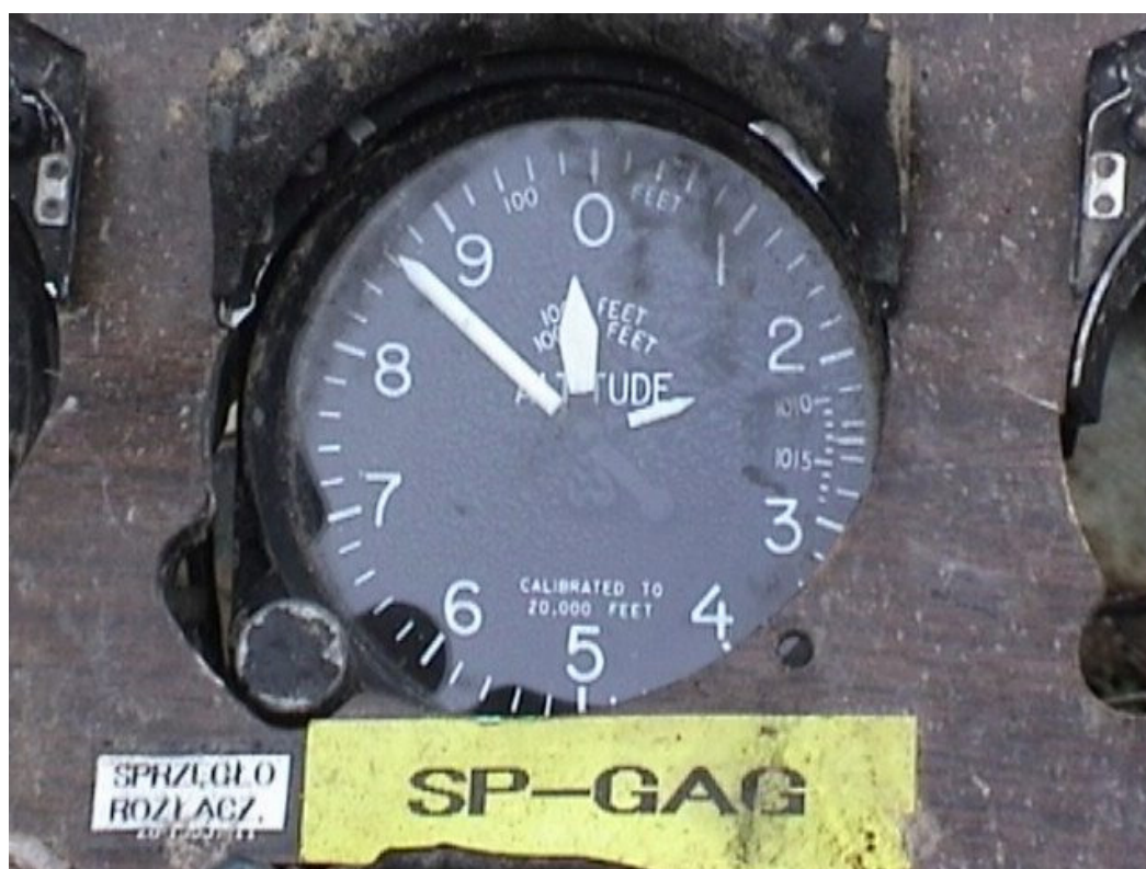
Fot.14 – Wysokościomierz z ostatnim wskazaniem.
