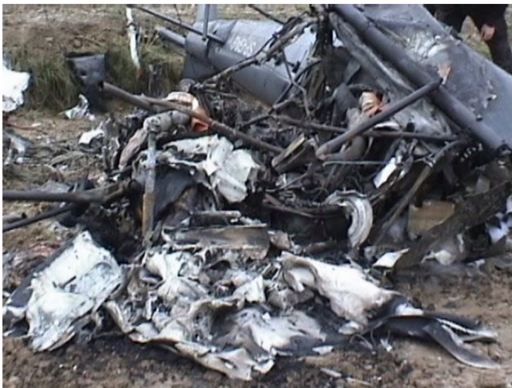
Fot.7 – Szczątki środkowej części kadłuba i zespołu napędowego.
