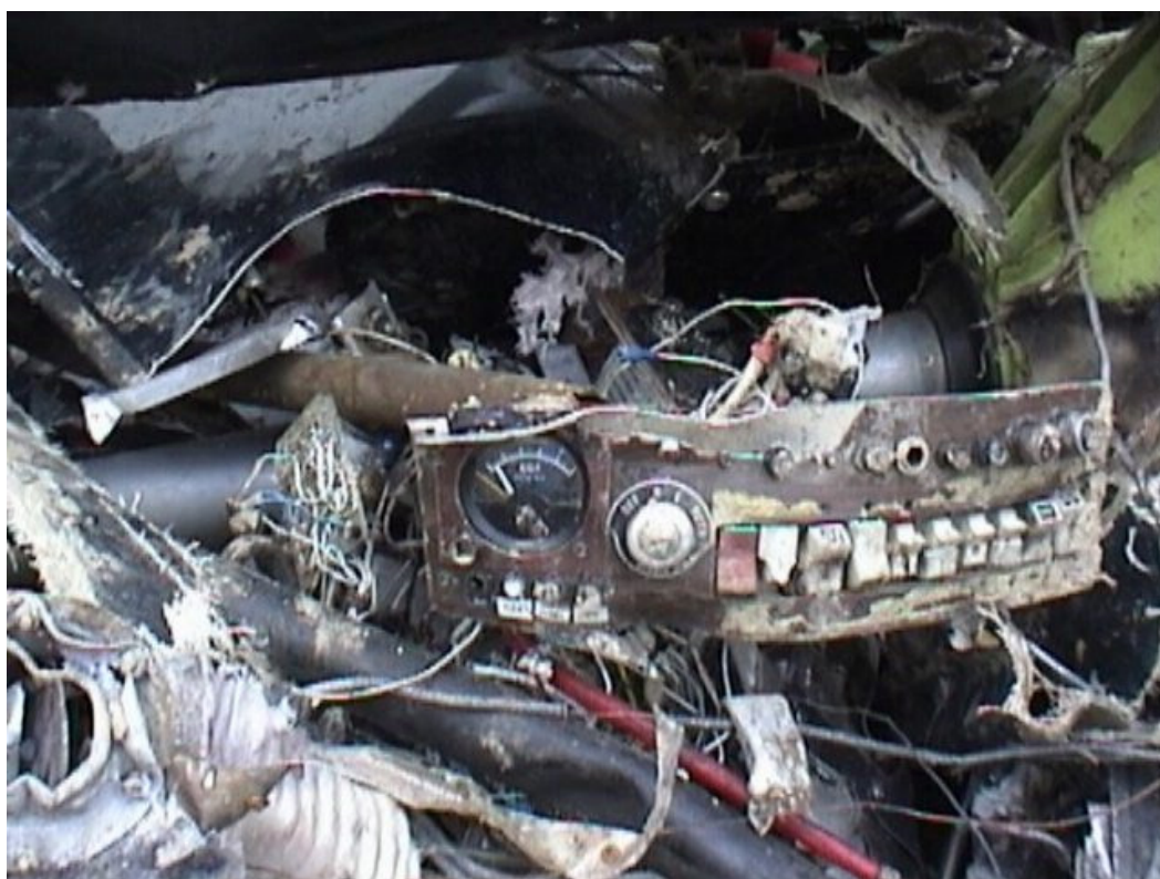
Fot.20 – Pulpit sterowania silnikiem i systemami pokładowymi – widoczne położenie przełączników.
