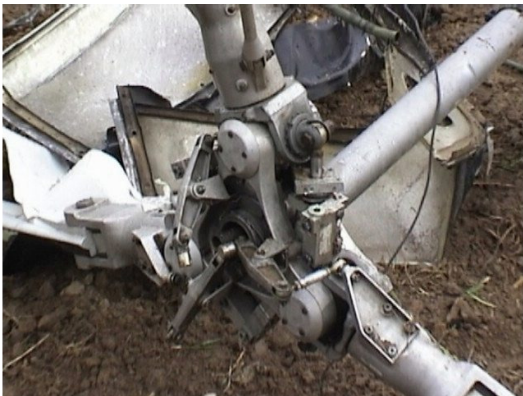
Fot.8 – Uszkodzona głowica wirnika głównego.
