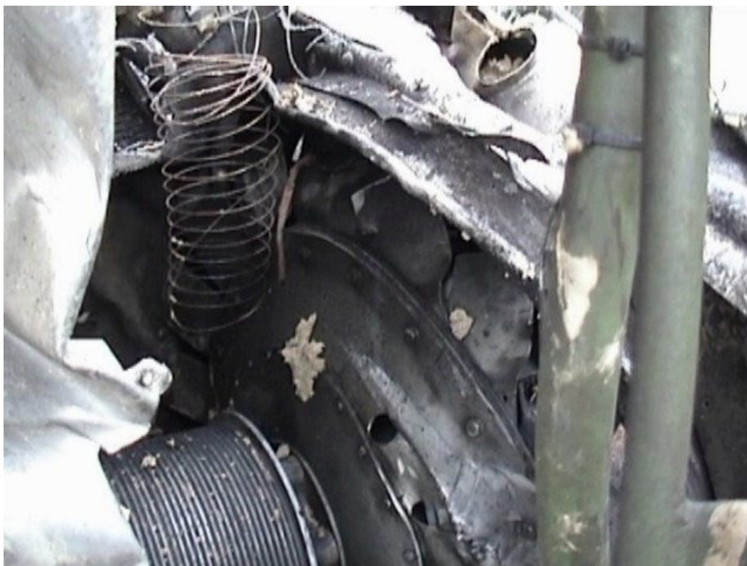
Fot.12 – Wirnik dmuchawy chłodzenia silnika – widoczne łopatki zniszczone w chwili uderzenia o ziemię oraz zniekształcona obudowa.
