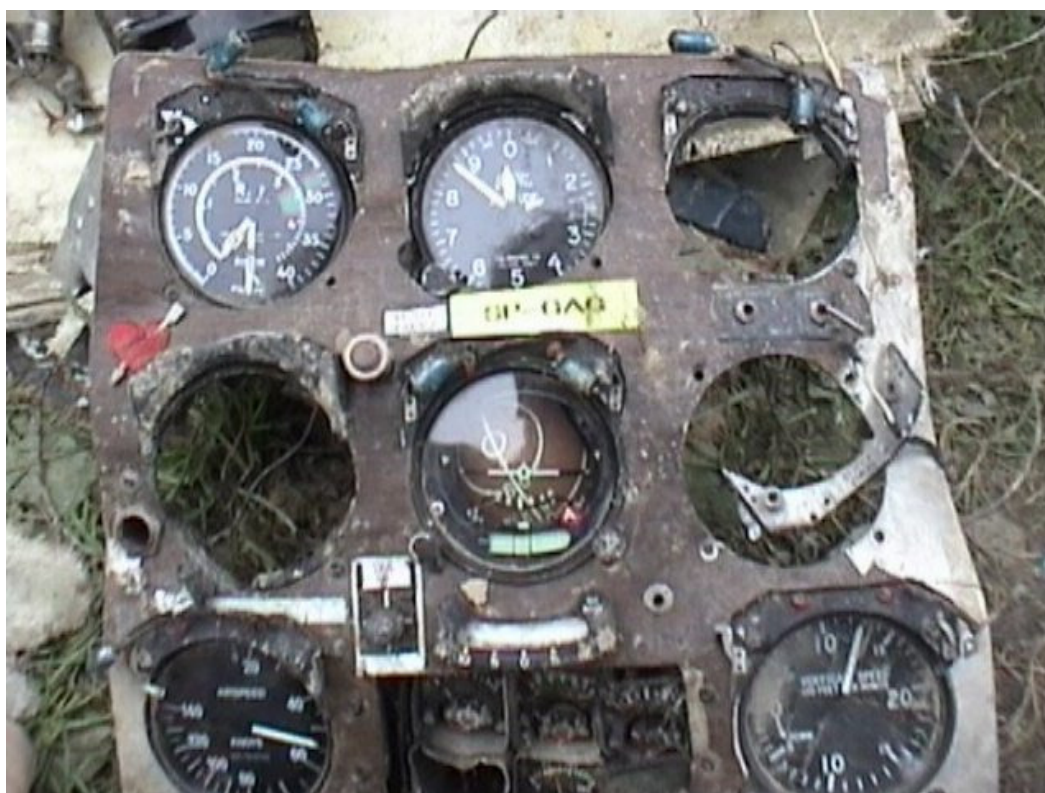
Fot.13 – Tablica przyrządów z ocalałymi przyrządami.
