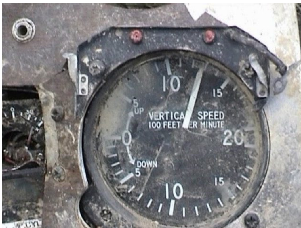
Fot. 15 – Wariometr z ostatnim wskazaniem.
