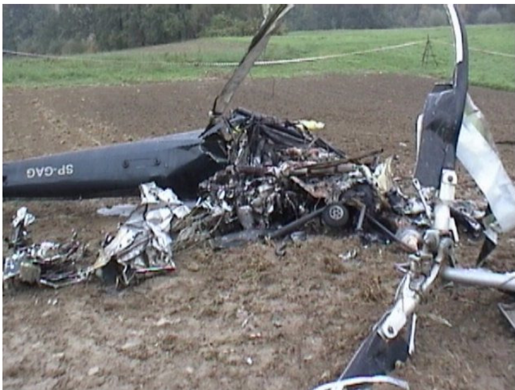
Fot.6 – Szczątki środkowej części kadłuba, kabiny i głowicy wirnika głównego.
