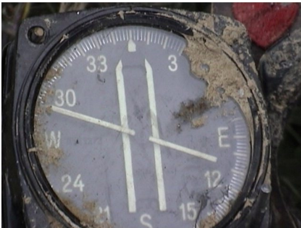
Fot.18 – Giroskopowy wskaźnik kursu z zachowanym ostatnim wskazaniem.
