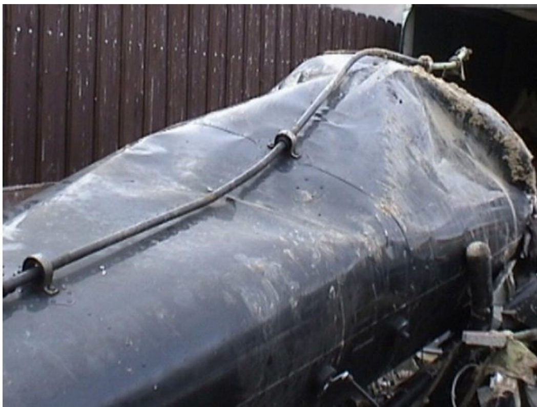
Fot.11 – Wał wirnika ogonowego ułożyskowany na przedniej części belki ogonowej.
