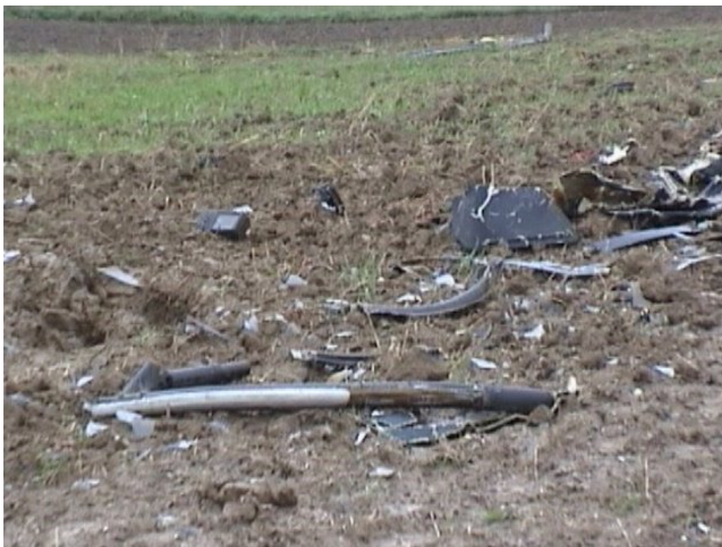
Fot.2 – Szczątki oddzielone od śmigłowca po pierwszym uderzeniu o ziemię.
