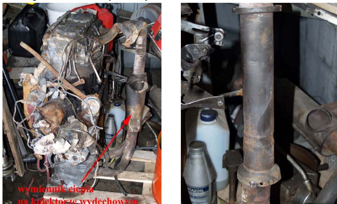
Fot. 7 Zdjęcia wymiennika ciepła przed i po demontażu z silnika
