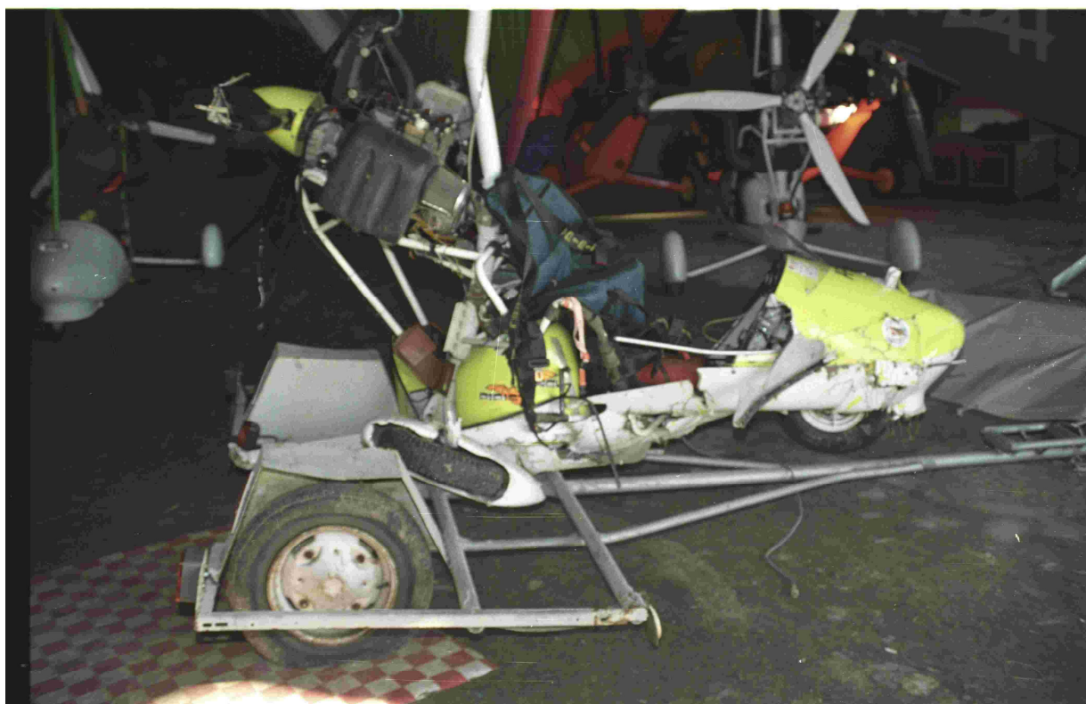
Fot.3 – Wózek z profilu z prawej strony – widoczne odkształcenie łoża silnika.
