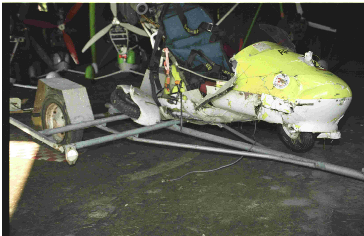
Fot.2 – Wózek z prawej strony – widoczne uszkodzenia owiewki, wyłamana goleń podwozia głównego i uszkodzony fotel.
