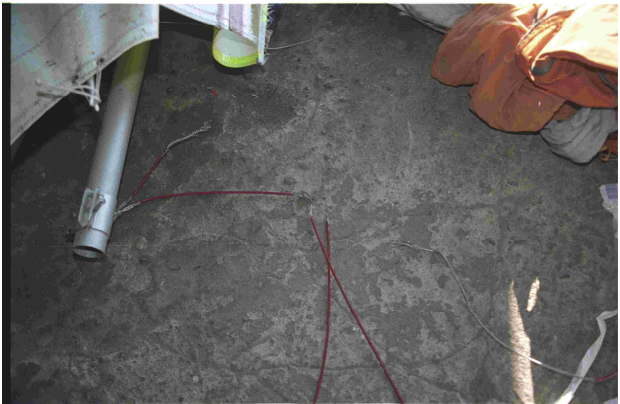
Fot.9 – Zerwane linki struktury skrzydła.
