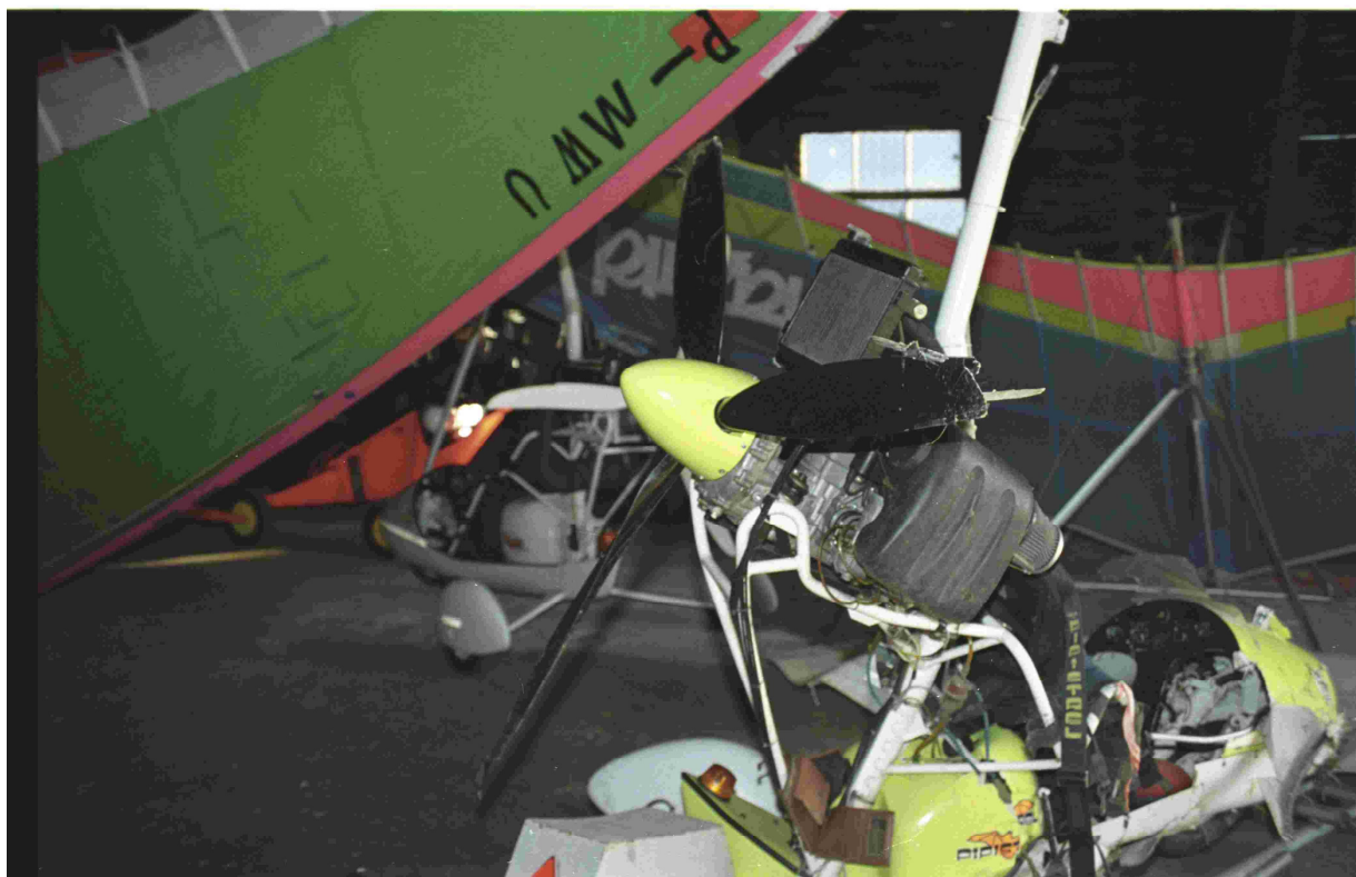
Fot.4 – Zespół napędowy – widoczne uszkodzone łopaty śmigła i odkształcone łożo silnika.
