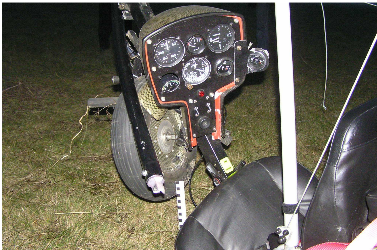
Fot.11 – Tablica przyrządów i przednie siedzenie; obok widoczny czarny pręt szkieletu wózka z rozerwanym okuciem i biały lewy pręt trójkąta sterowniczego.
