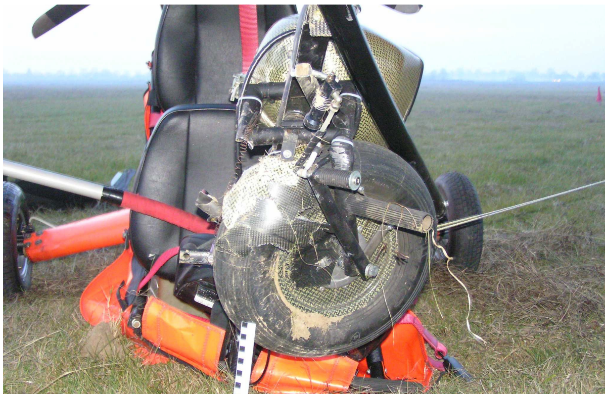
Fot.10 – Zniszczona przednia część wózka motolotni, widoczna strzaskana owiewka i wyłamane podwozie przednie.
