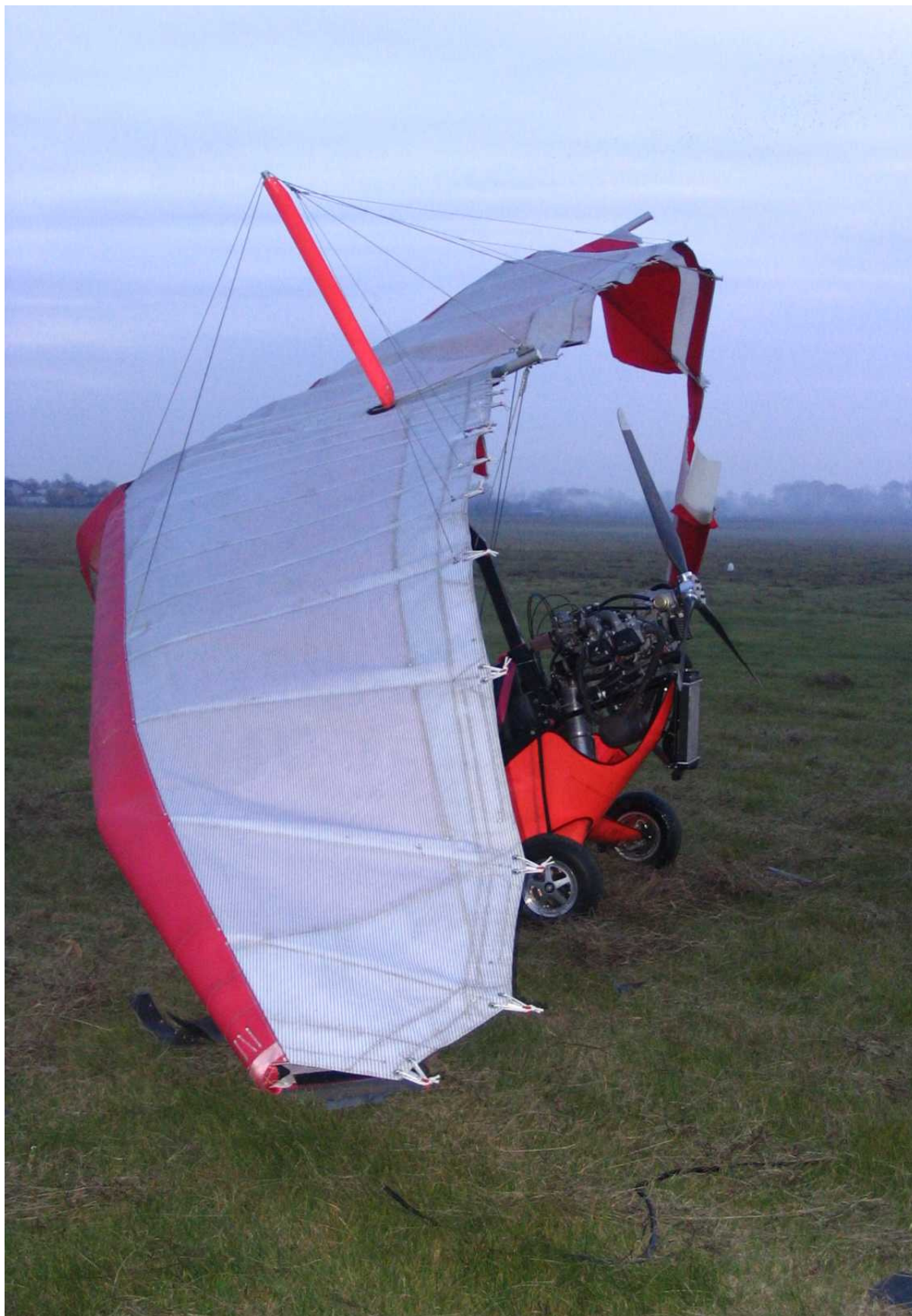
Fot.6 – Widok motolotni z lewej strony – widoczny zespół napędowy, podwozie główne i złamana prawa i uszkodzona lewa końcówka skrzydła.
