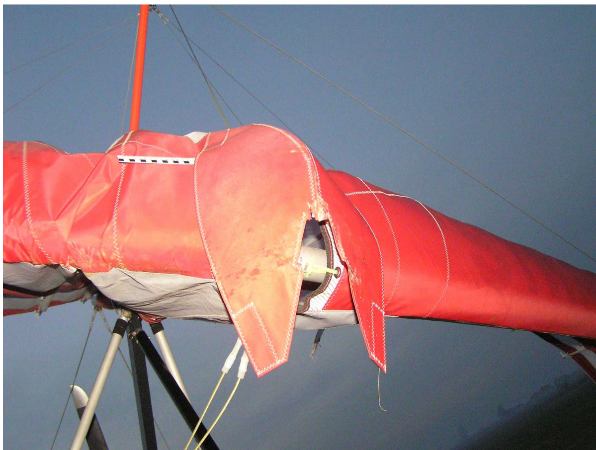
Fot.8 – Rozbity przedni węzeł skrzydła.
