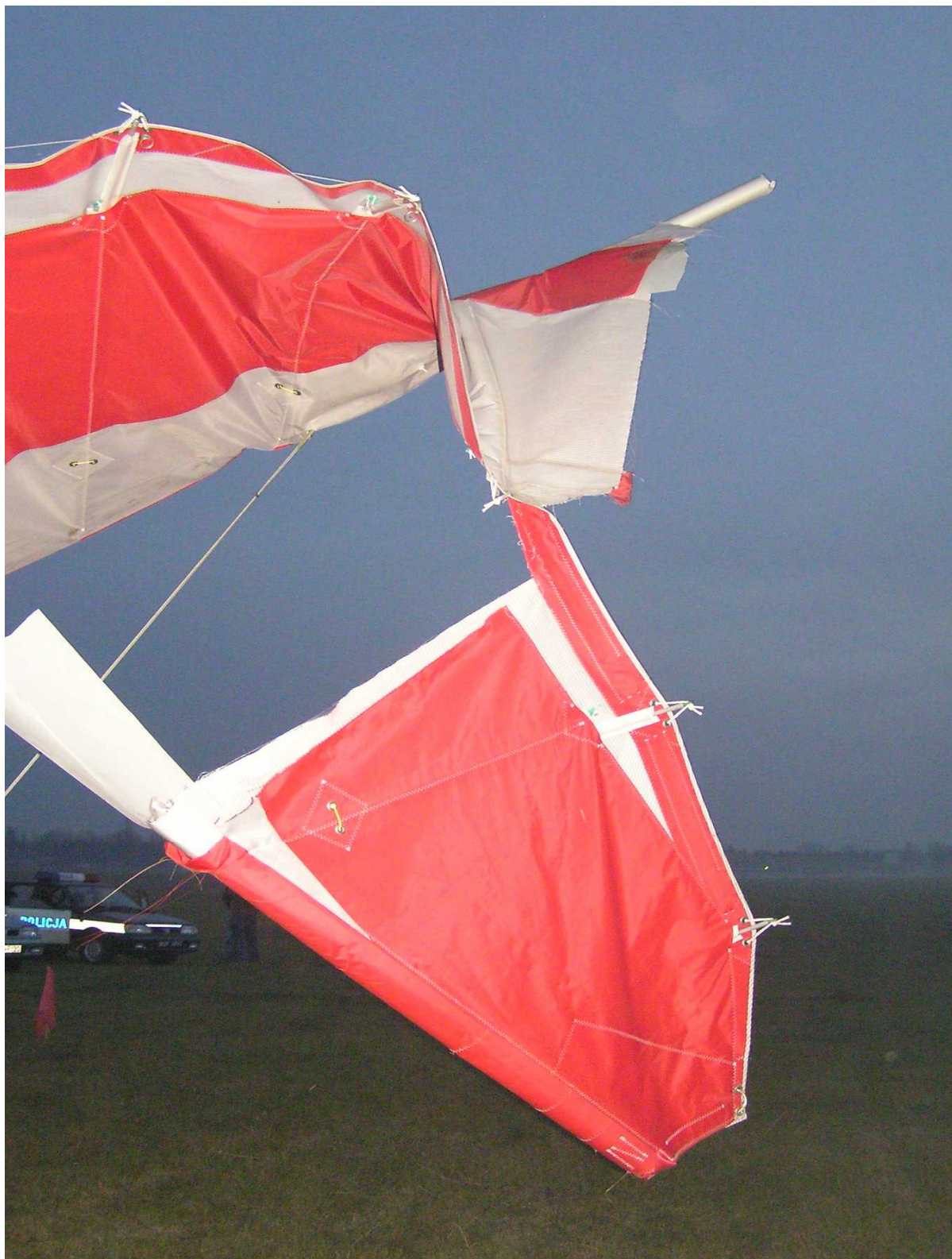
Fot.9 – Złamana prawa końcówka skrzydła z częściowo oderwanym pokryciem.
