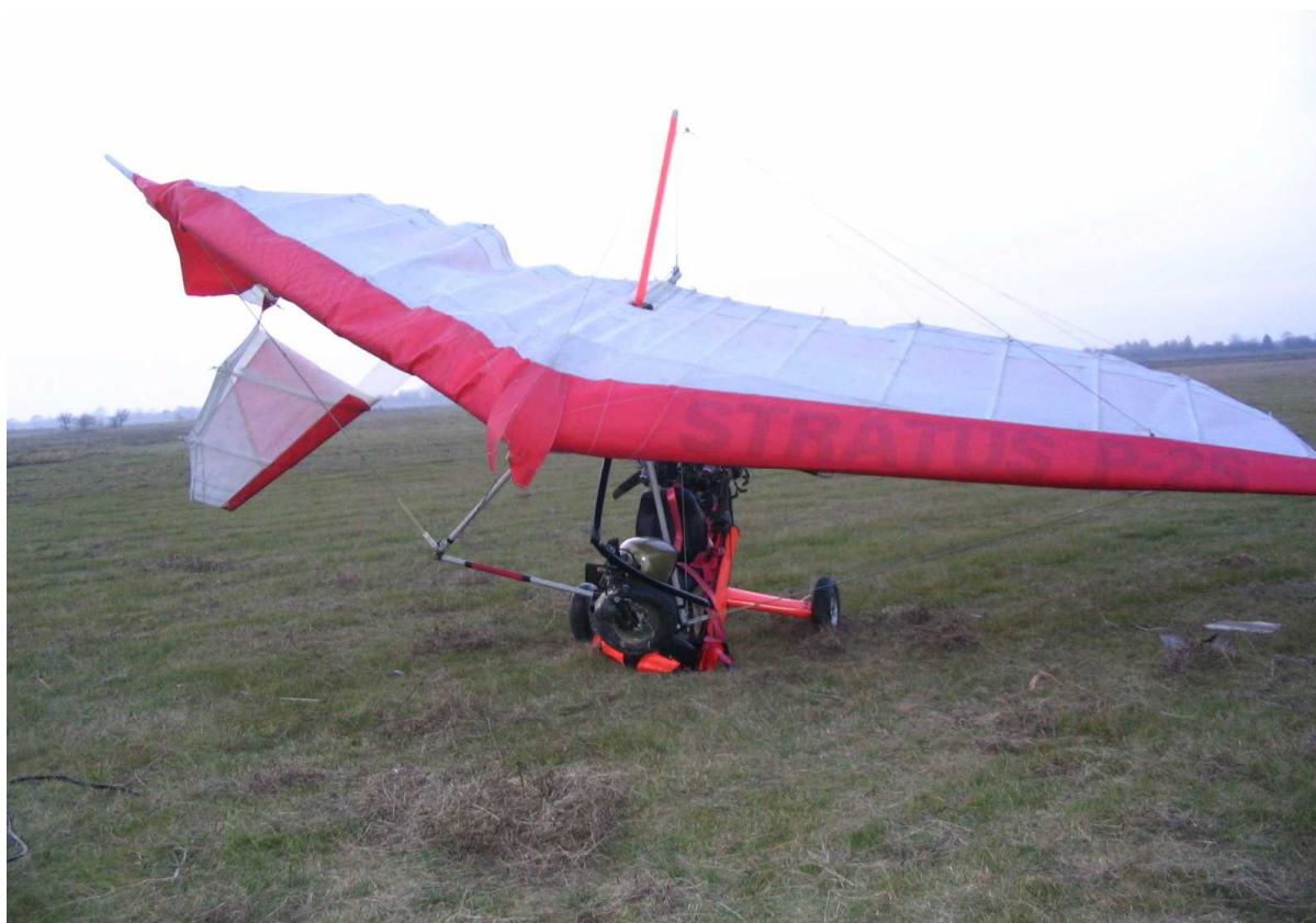
Fot.7 – Widok ogólny rozbitej motolotni z przodu, widoczny złamany czarny przedni pręt szkieletu wózka.
