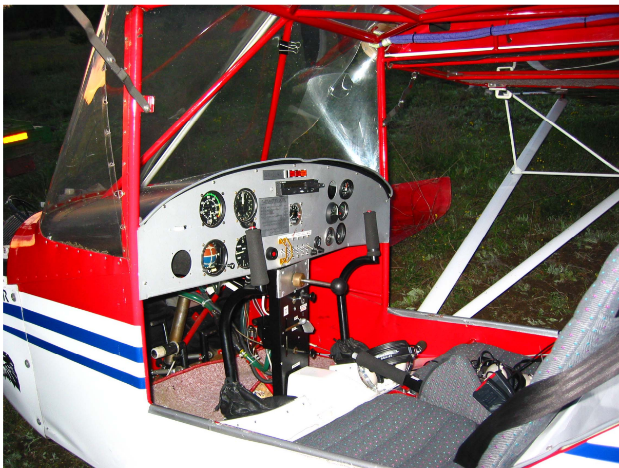
Fot.6 – Wnętrze kabiny, widać oderwany i potłuczony wiatrochron.
