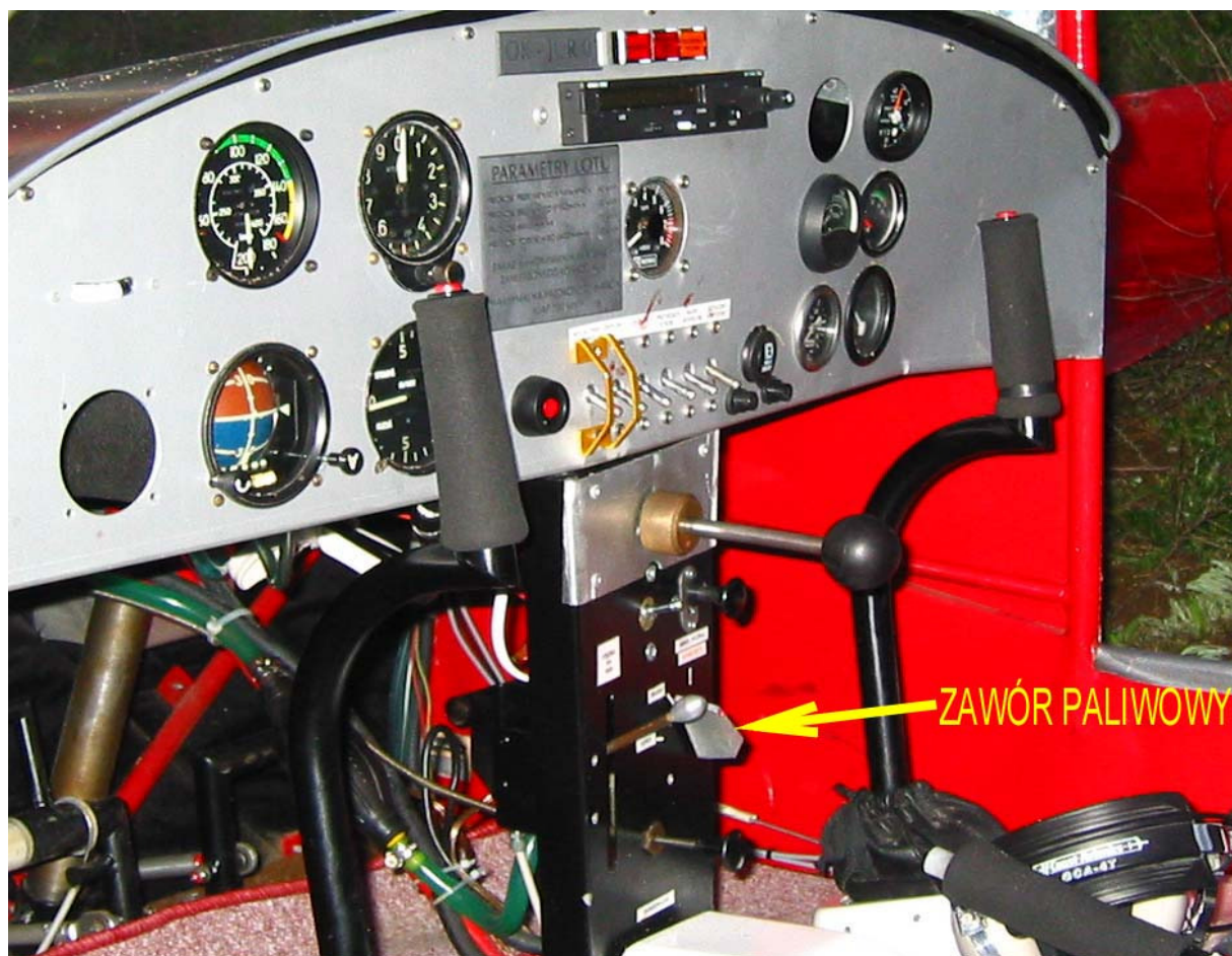
Fot.7 – Tablica przyrządów i sterownice, widoczny zawór paliwowy w położeniu „PRAWY”.
