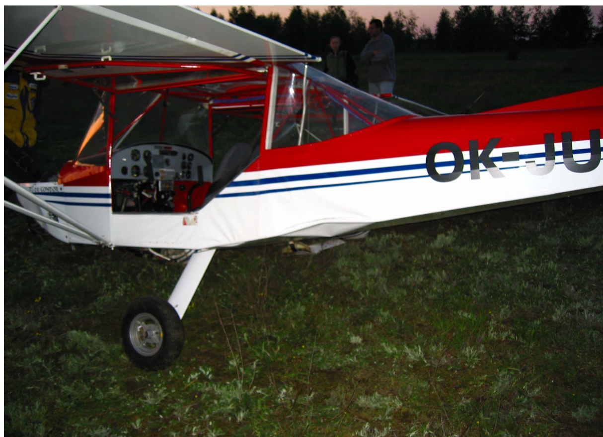
Fot.8 – Lewa strona kadłuba – widać zniekształcenia pokrycia świadczące o uszkodzeniu struktury.
