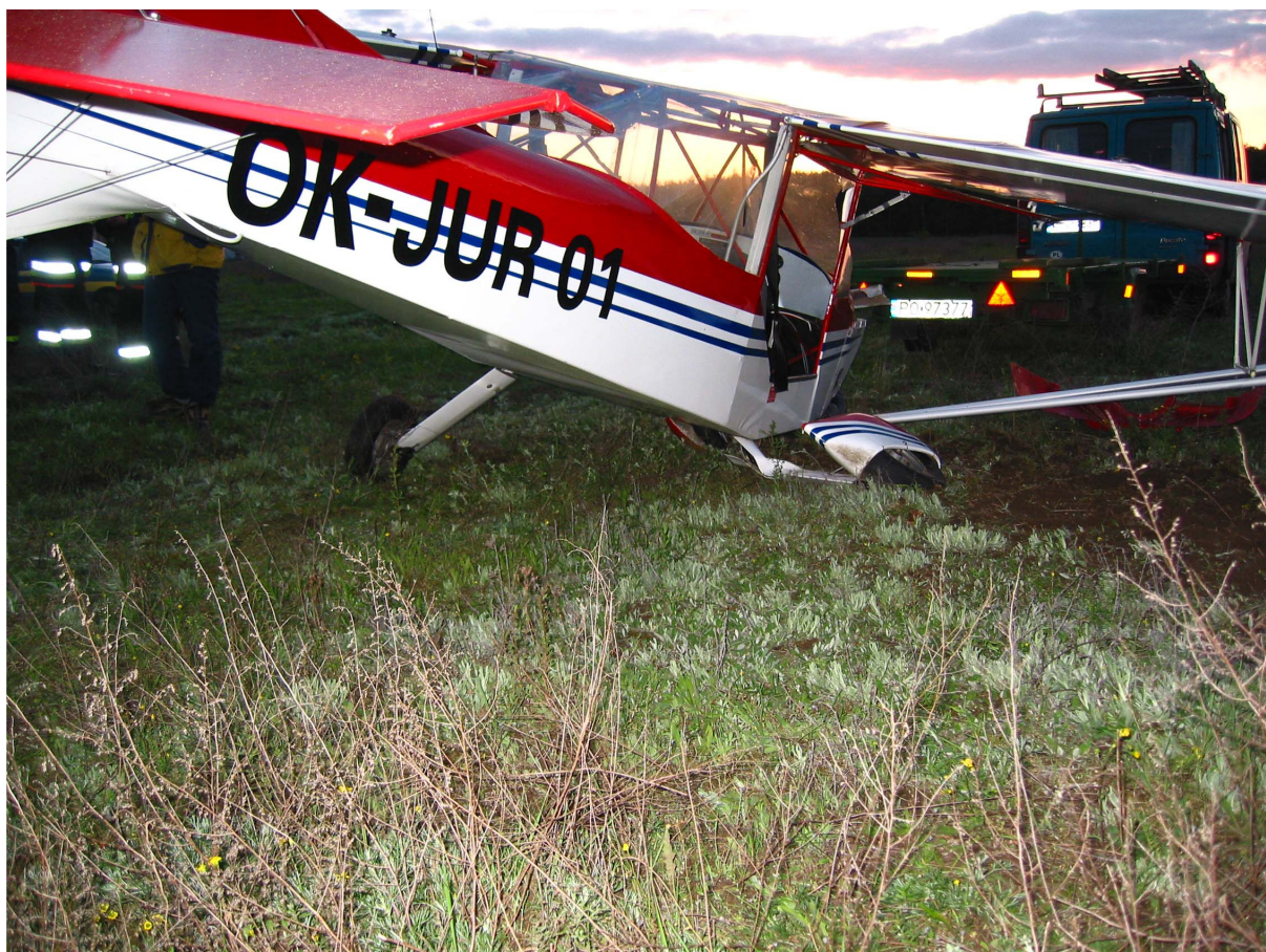
Fot.4 – Widok od tyłu z prawej strony; widoczne zniszczone podwozie przednie i prawe podwozie główne.
