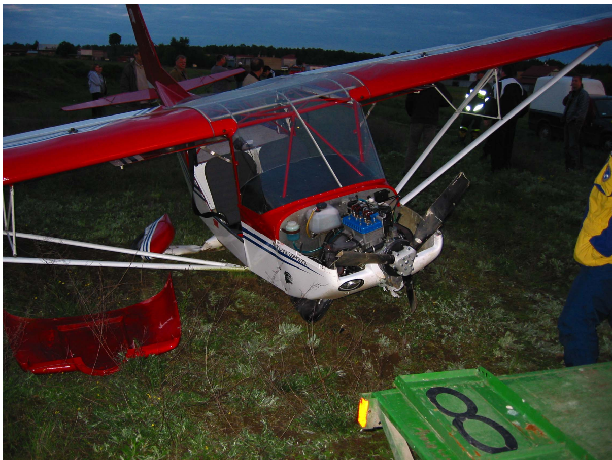
Fot.5 – Zniszczone śmigło.
