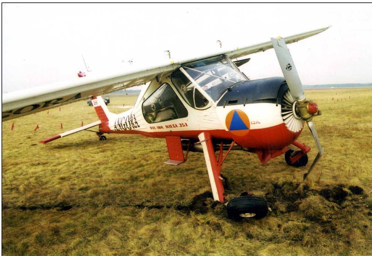
11 – Samolot po wypadku, widok \frac{3}{4} z przodu od prawej. Widoczne połamane śmigło i uszkodzone prawe podwozie oraz ślad dobiegu na trawie.
