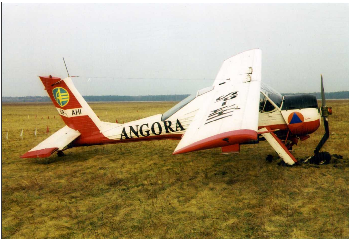
10 – Samolot po zatrzymaniu, lewa strona – widoczne uszkodzenia podwozia i śmigła.
