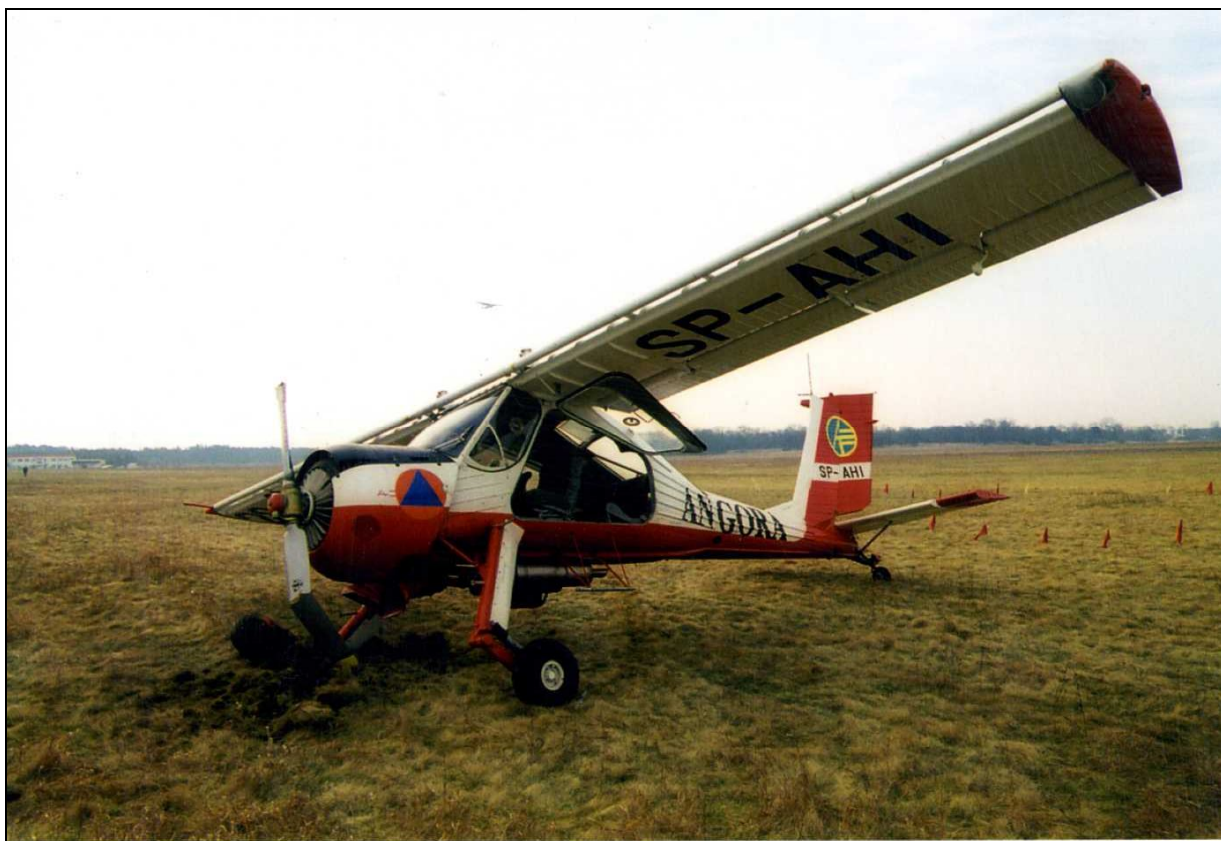
12 - Samolot po wypadku, widok \frac{3}{4} z przodu od lewej. Widoczne połamane śmigło i uszkodzone prawe podwozie oraz ślad dobiegu na trawie.
