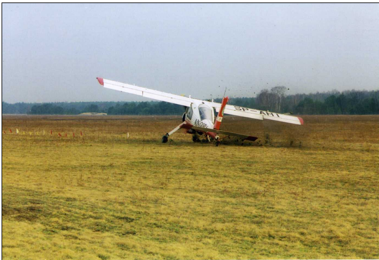
5 – Kolejne fazy lądowania samolotu SP-AHI, zakończonego wypadkiem: C – kontynuowanie dobiegu z zejściem z kierunku w prawo, niszczenie podwozia.
