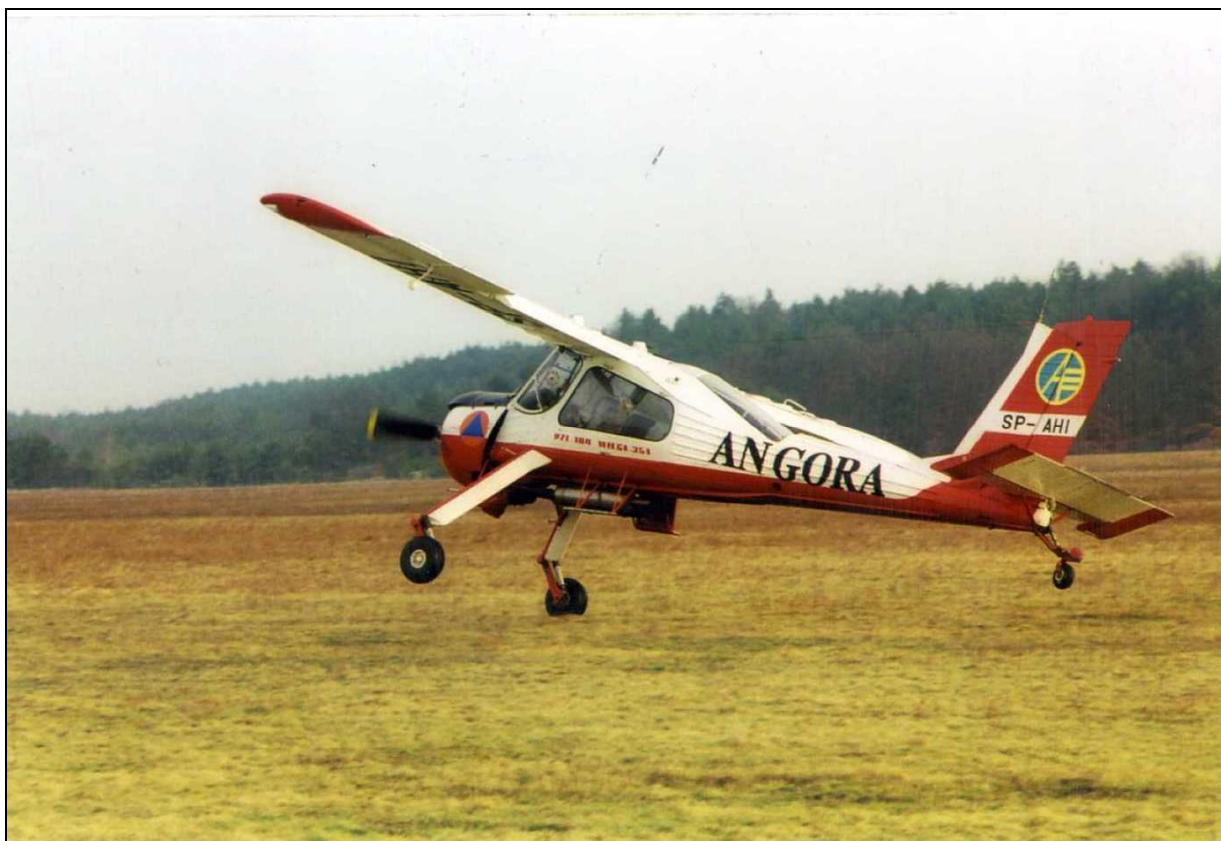
3 – Kolejne fazy lądowania samolotu SP-AHI, zakończonego wypadkiem: A – przyziemienie na prawe podwozie główne z przechyleniem na prawe skrzydło.
