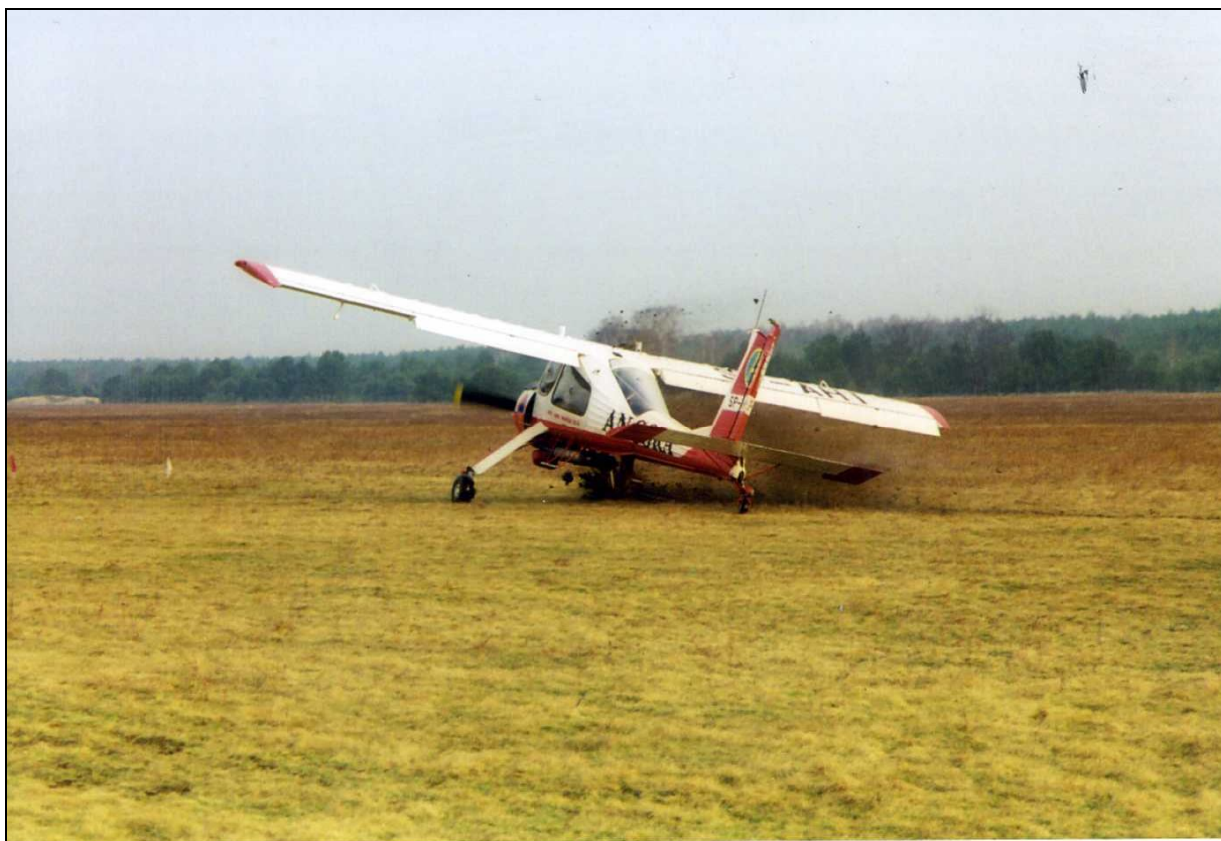
4 – Kolejne fazy lądowania samolotu SP-AHI, zakończonego wypadkiem: B – uszkodzenie prawego podwozia głównego i dobieg z zejściem z kierunku w prawo: widoczna próba kontrowania przechylenia wychyleniem lotek.
