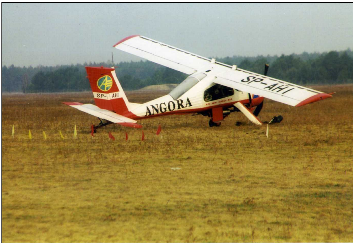
9 – Kolejne fazy lądowania samolotu SP-AHI, zakończonego wypadkiem: G – opadnięcie ogona po zatrzymaniu samolotu; widoczne uszkodzenia śmigła i prawego podwozia głównego.
