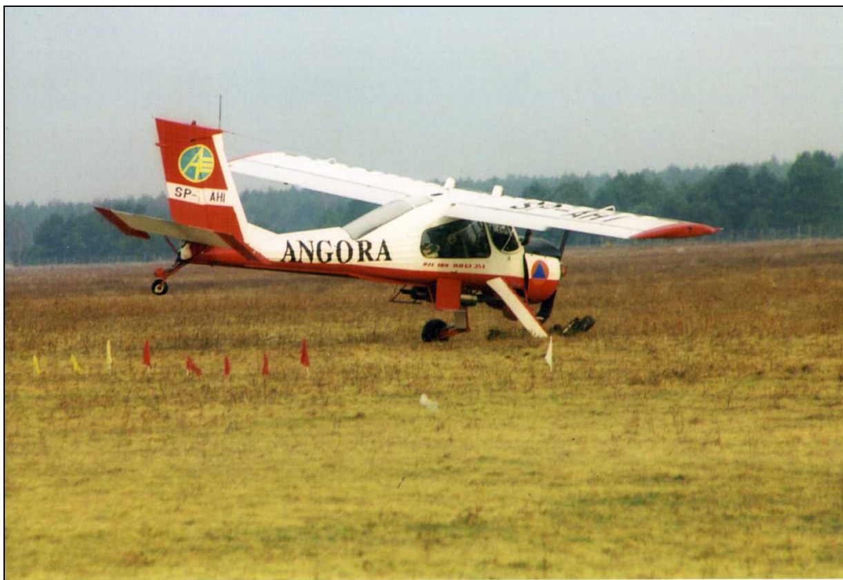
7 – Kolejne fazy lądowania samolotu SP-AHI, zakończonego wypadkiem: E – zatrzymanie i początek pochylania się samolotu na nos, kontakt śmigła z ziemią.
