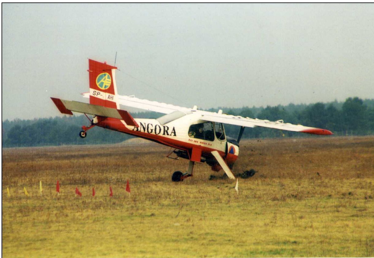
8 – Kolejne fazy lądowania samolotu SP-AHI, zakończonego wypadkiem: F – zatrzymanie i kontynuacja pochylania się samolotu na nos (coraz wyraźniejsze „zadzieranie” ogona), kontakt śmigła z ziemią.
