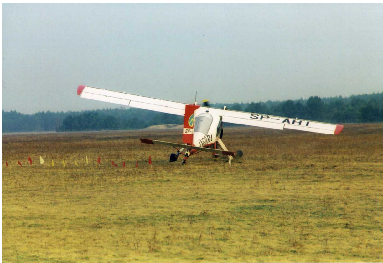
6 – Kolejne fazy lądowania samolotu SP-AHI, zakończonego wypadkiem: D – kontynuowanie dobiegu z zejściem z kierunku w prawo, niszczenie podwozia; widoczna próba kontrowania zejścia z kierunku przez wychylenie steru kierunku.
