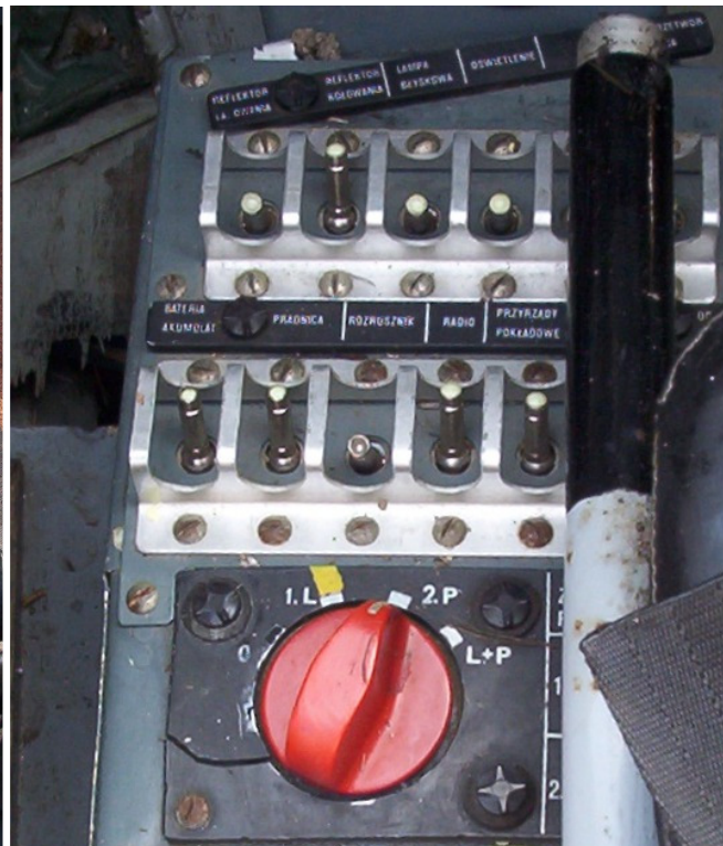
30 – Pulpit między fotelami - wyłączniki i zawór paliwowy.
