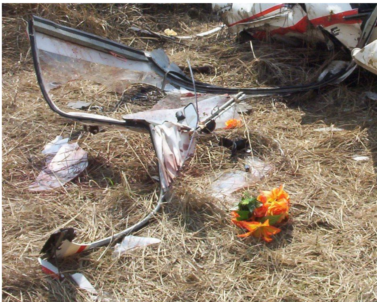
12 – Zniszczona osłona kabiny (usunięta podczas akcji ratowania załogi) i wiązanka kwiatów, przeznaczona do zrzutu.
