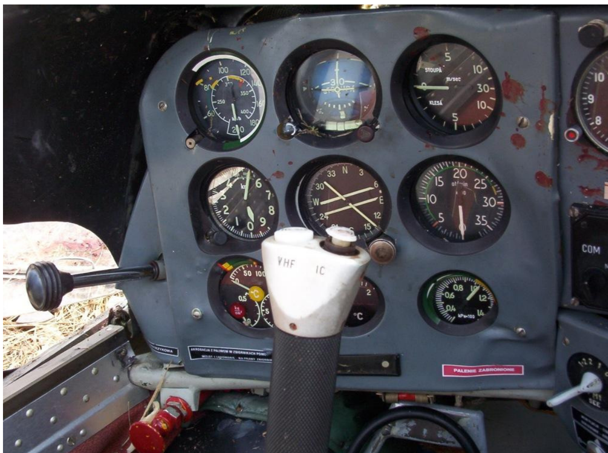
27 – Lewa tablica przyrządów (przyrządy pilotażowo-nawigacyjne).
