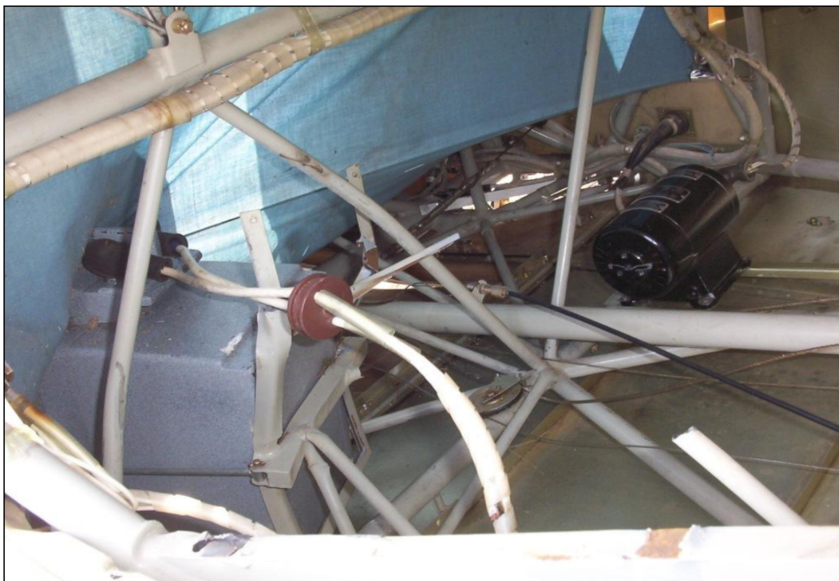
11 – Wnętrze przedniej, kratownicowej części kadłuba za fotelami załogi. Widoczne elementy systemów sterowania i elektrycznego.
