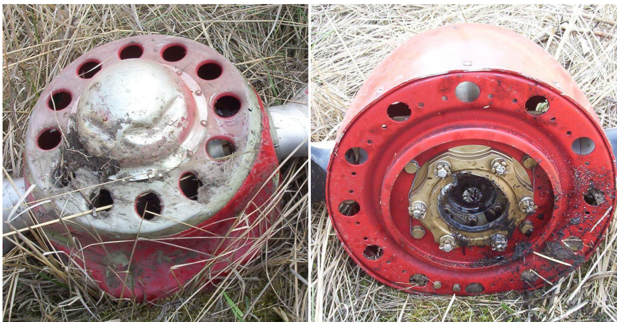
19 i 20 – Piasta śmigła od przodu (po lewej) i od tyłu (po prawej). Na prawym zdjęciu widać odłamaną kołnierz wału śmigła.
