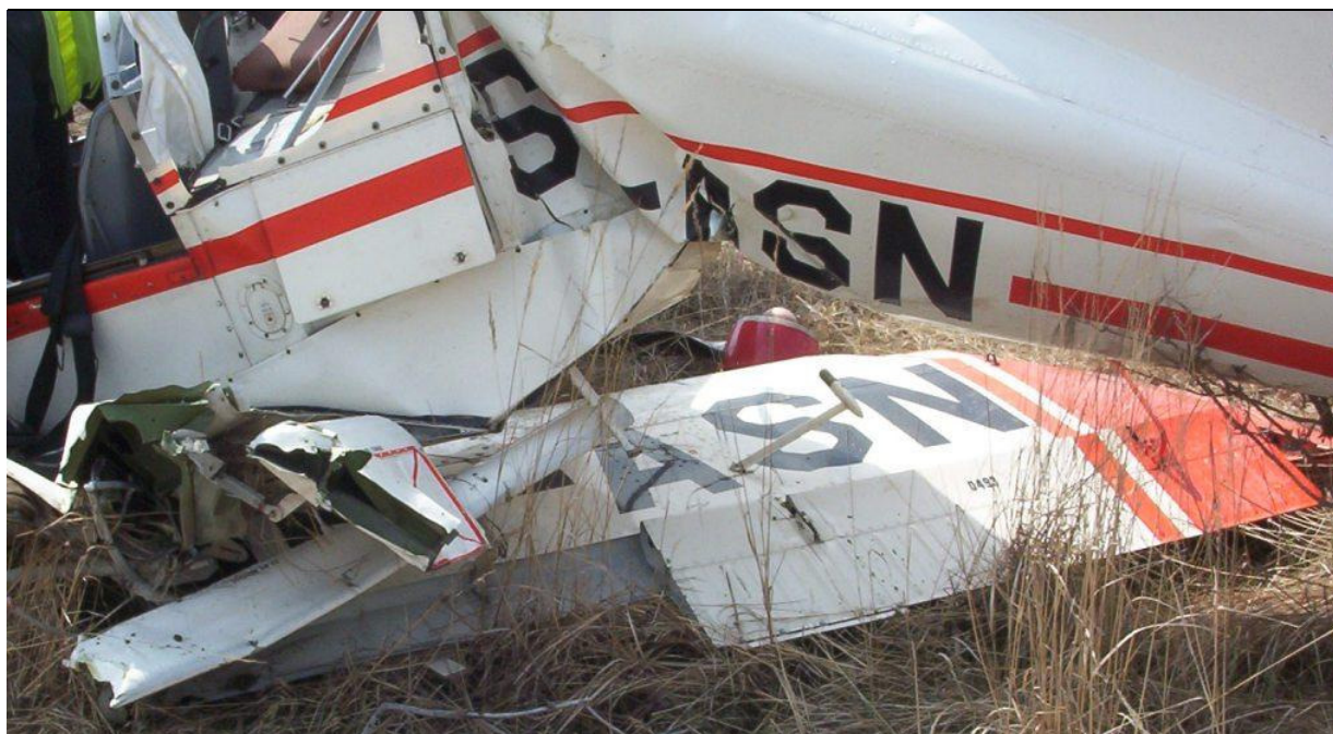
9 – Kadłub w miejscu złamania struktury, lewa strona. Wyłamane lewe skrzydło z wyrwaną klapą leży pod złamanym kadłubem.
