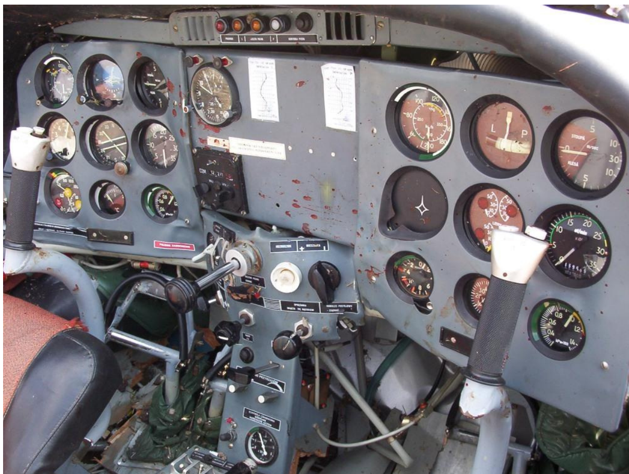
26 – Tablica przyrządów, konsola centralna, sterownice ręczne i nożne.
