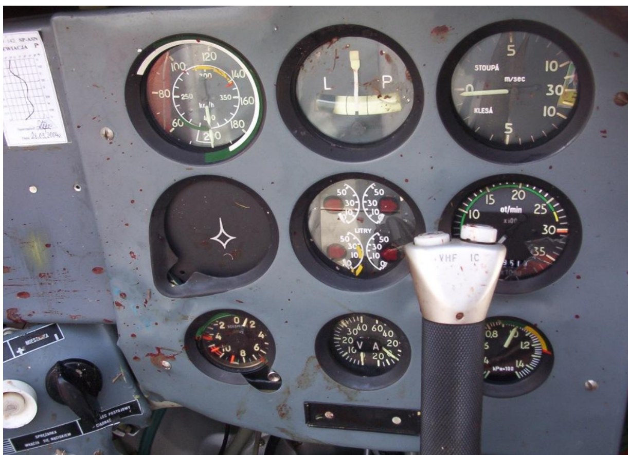
28 – Prawa tablica przyrządów (przyrządy kontroli silnika i systemów pokładowych).
