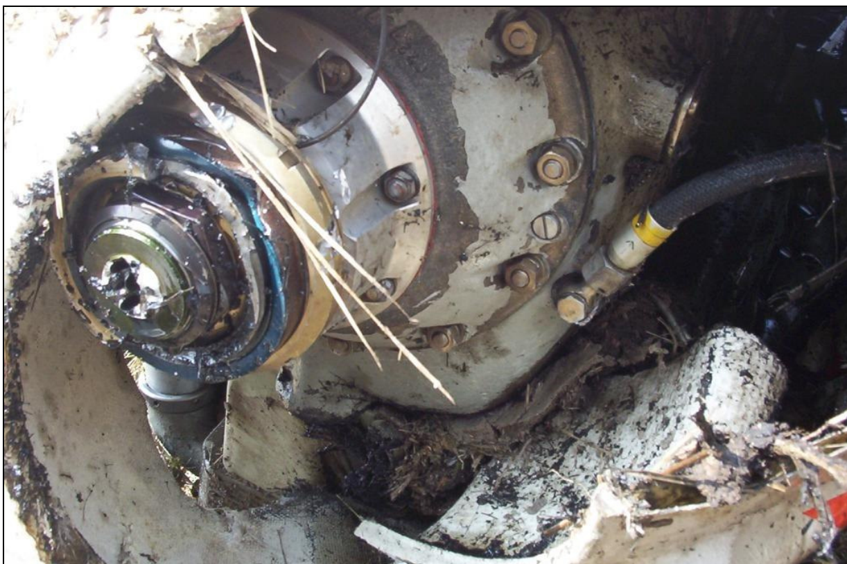
16 – Wyprowadzenie wału silnika z odłamanej (ukręconą) końcówką z kołnierzem do mocowania śmigła.
