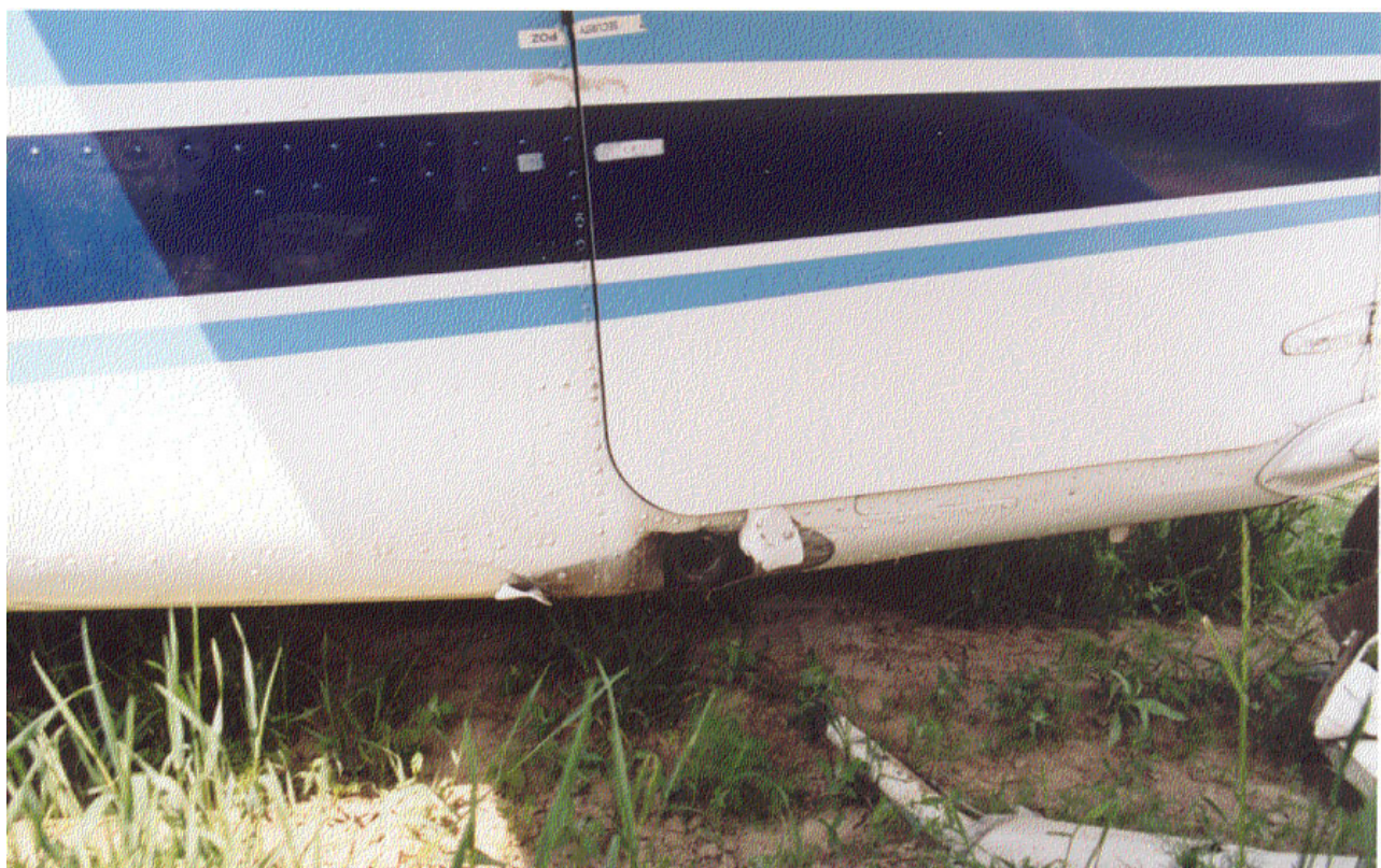
Fot.10 – Wyłamane z kadłuba prawe podwozie główne.
