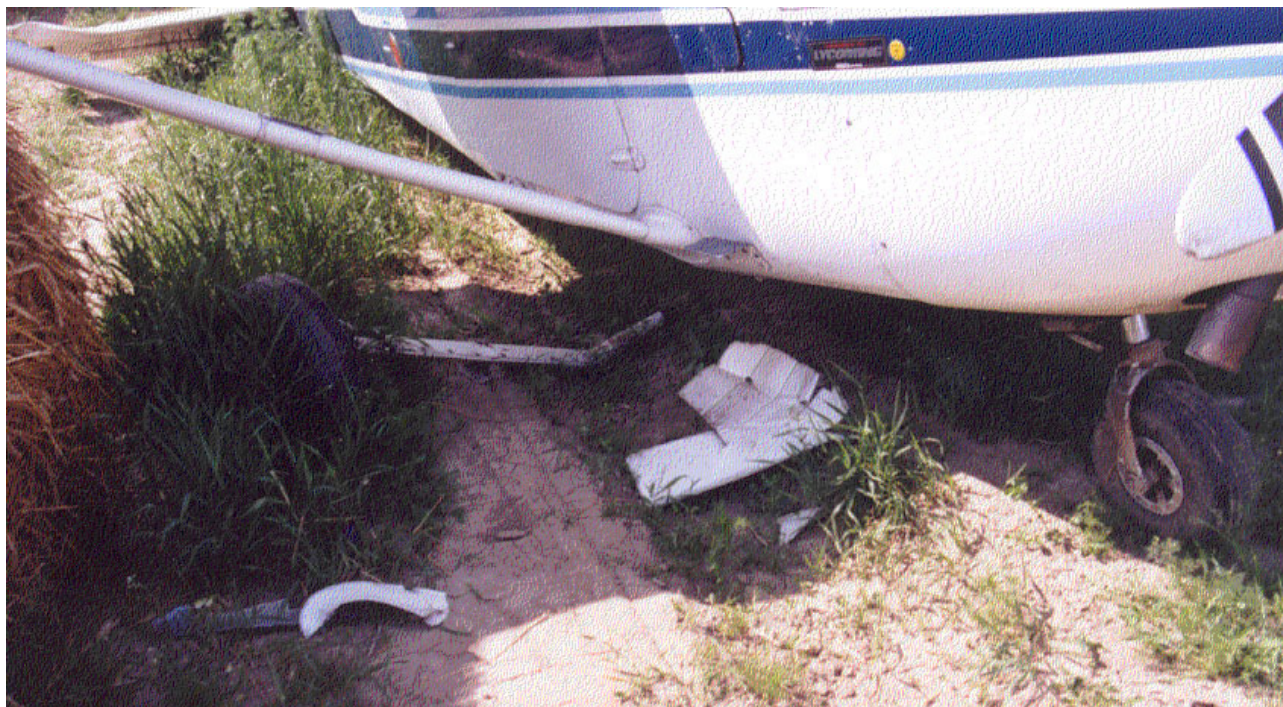
Fot.12 – Ogólny widok uszkodzonego podwozia z prawej strony samolotu.
