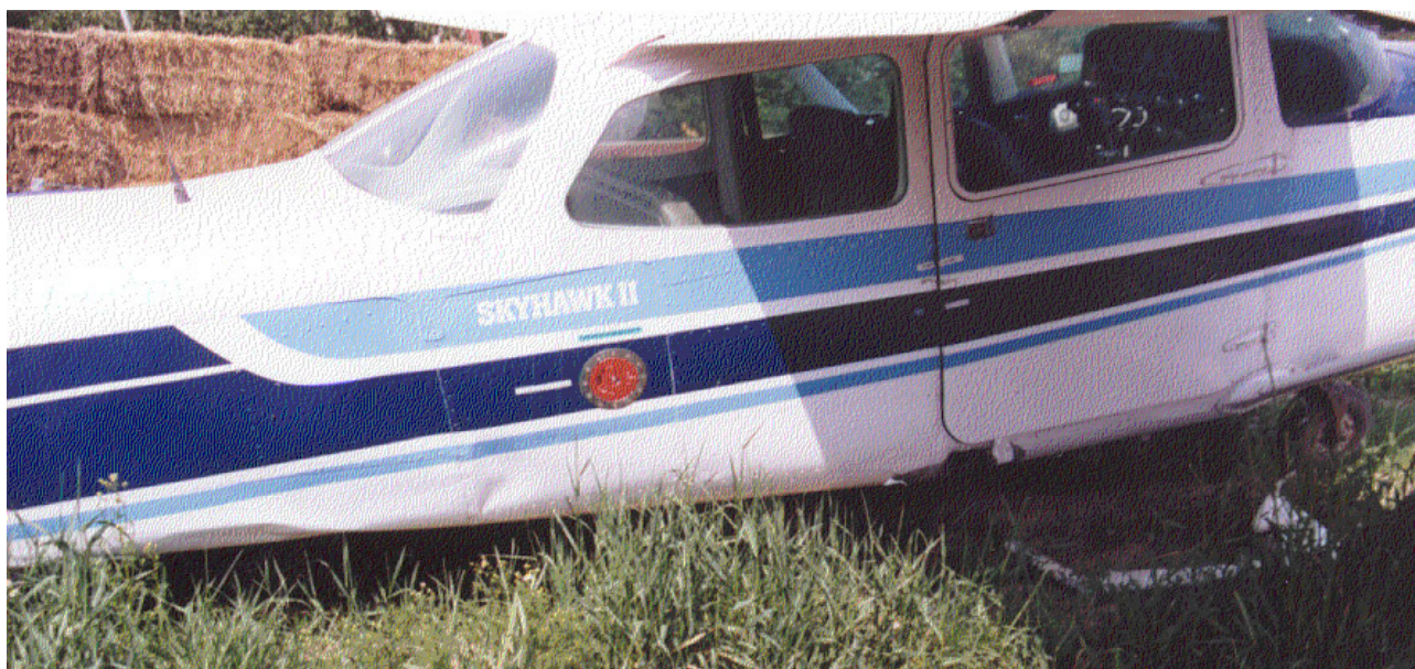
Fot.8 – Uszkodzenia pokryć kadłuba w rejonie kabiny i bagażnika.
