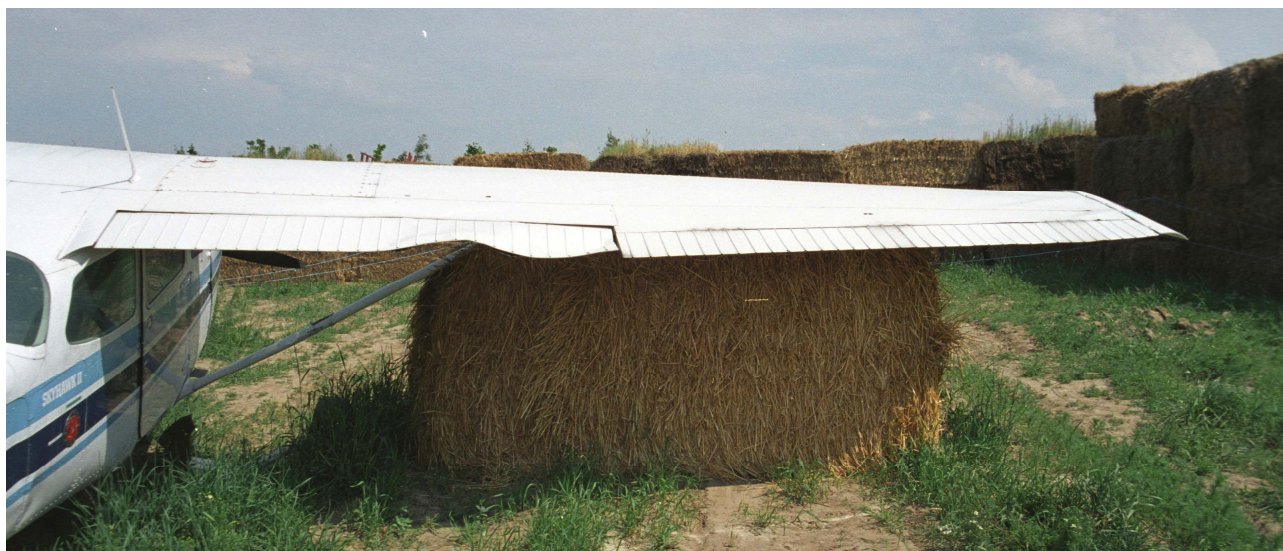
Fot.6 – Pofalowanie spływu prawej kłapy.
