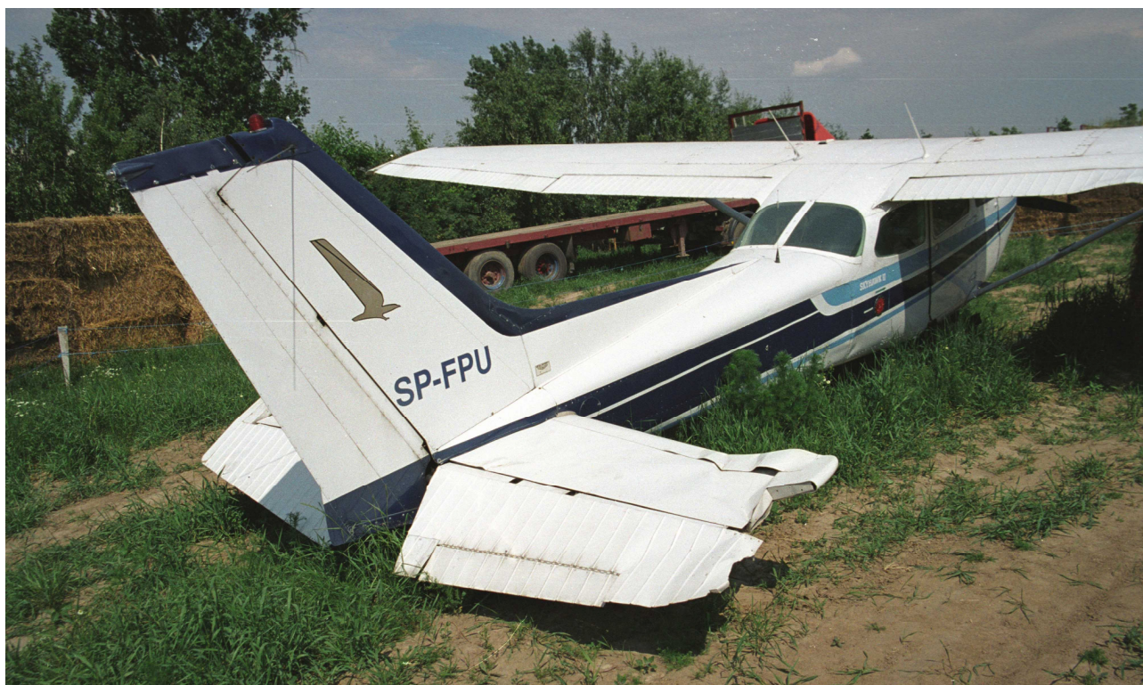
Fot.9 – Uszkodzenia usterzenia poziomego.
