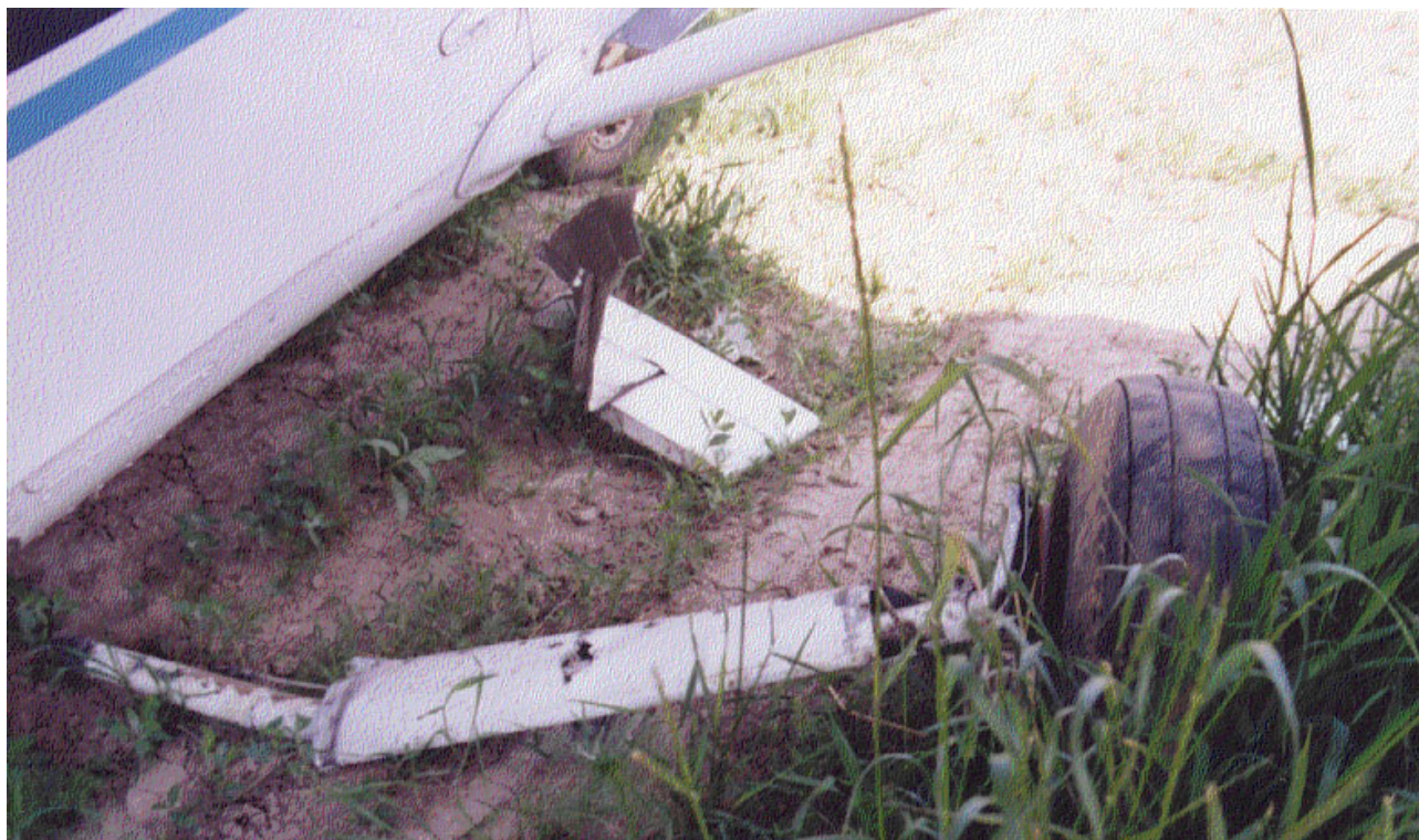
Fot.11 - Wyłamane z kadłuba prawe podwozie główne.
